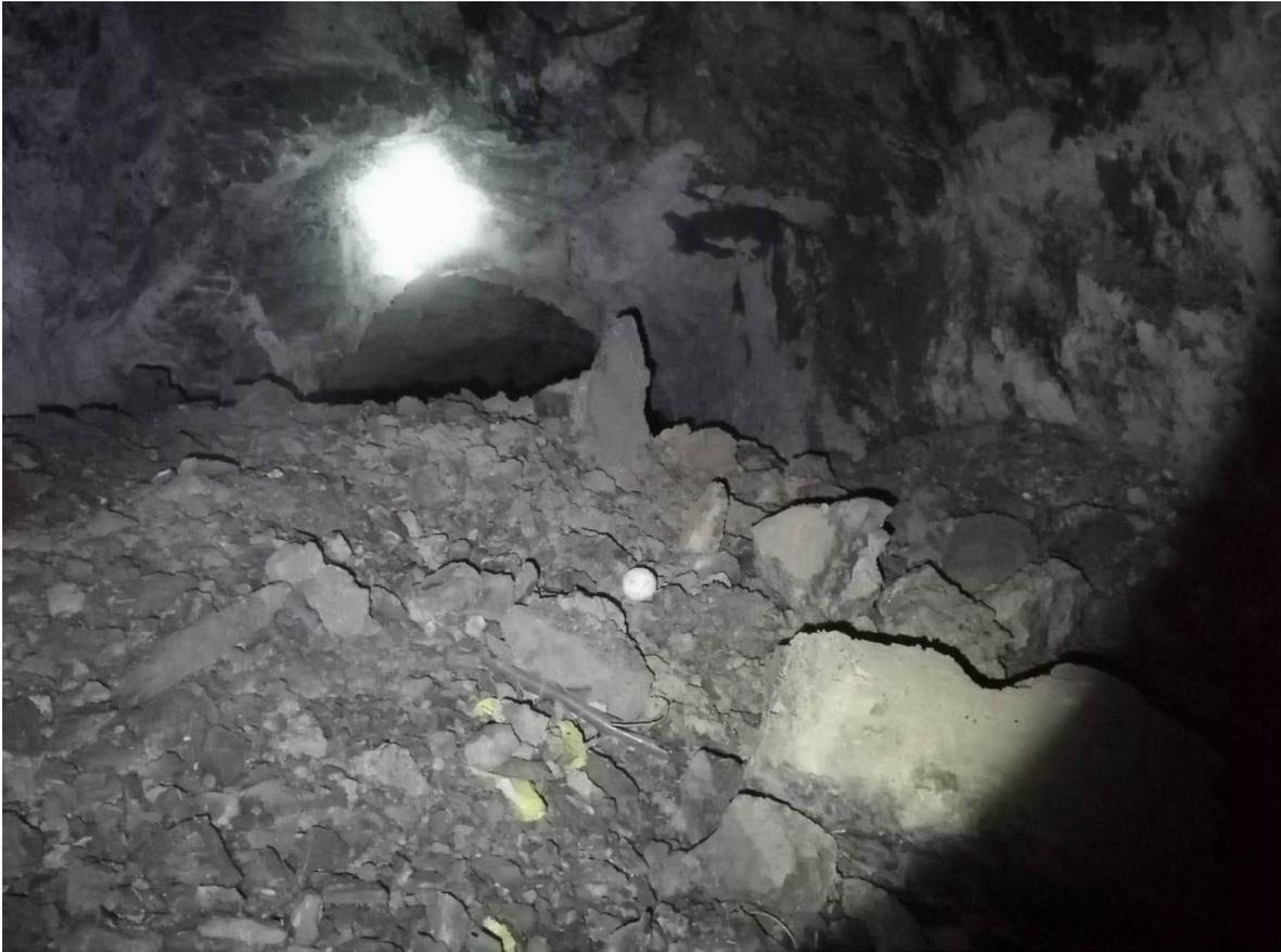
***Figura 16. Granulometría post voladura, ampliación del crucero principal CX 2006***
