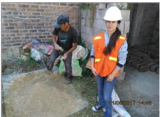
Ilustración 22 Elaboración de adobes con adición de fibra de maguey, tomado de Salazar Terrones, Leslye Lizzeth.
