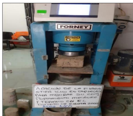
Ilustración 9 Resumen ensayos de resistencia a compresión, tomado de Malca Díaz, Amado
