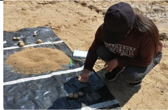
Ilustración 83 Resultado de la prueba de “Resistencia seca”
