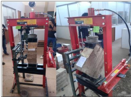
Ilustración 33 Máquina de compresión diagonal, tomado de Chuqui Paucar, Wilfredo y Chalco Ruelas, Ronal Augusto.
