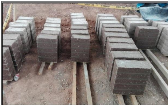
Ilustración 31 Proceso de secado de pilas y muretes de tapia, tomado de Chuqui Paucar, Wilfredo y Chalco Ruelas, Ronal Augusto.
