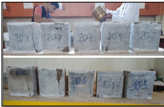
Ilustración 15 Agrietamiento típico en muestras después de ensayo resistencia a la compresión, tomado de Ruiz Catillo, Mirela y Bringas Segura, Aldo
