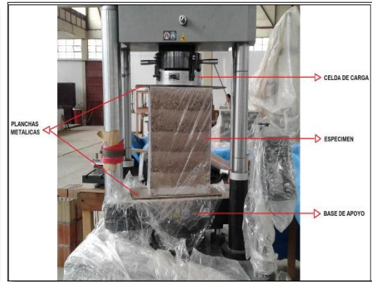
Ilustración 32 Instrumentación del ensayo de compresión axial, tomado de Chuqui Paucar, Wilfredo y Chalco Ruelas, Ronal Augusto.
