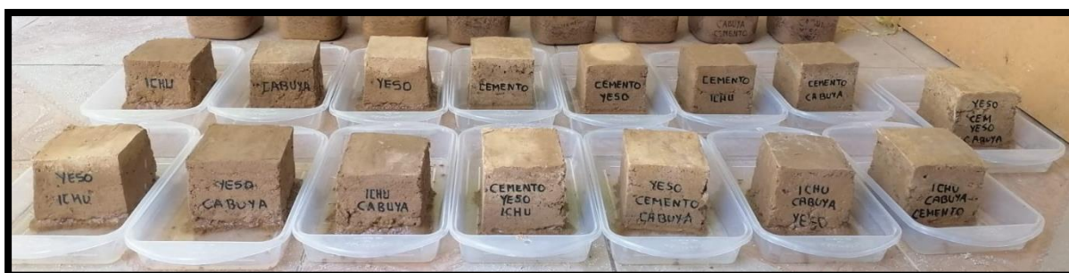
Ilustración 263 Resultados de la Prueba de absorción vista frontal
