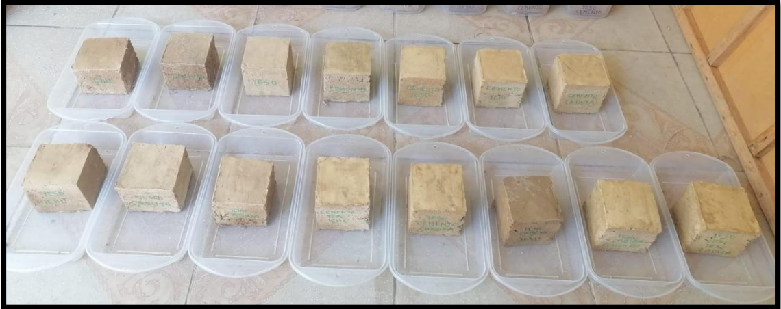
Ilustración 187 Muestra para la Prueba de Absorción
