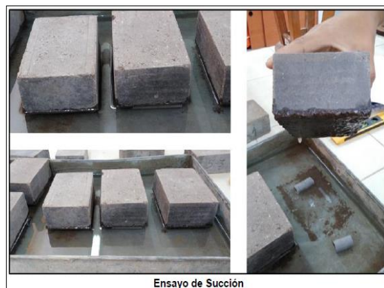
Ilustración 16 Ensayo succión, tomado de Ruiz Catillo, Mirela y Bringas Segura, Aldo
