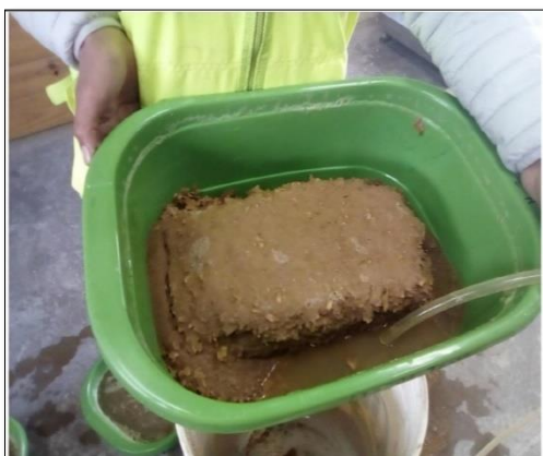
Ilustración 8 Adobe después de las 24 horas que fue sometido al ensayo de absorción, tomado de VASQUEZ VASQUEZ, LIZAR
