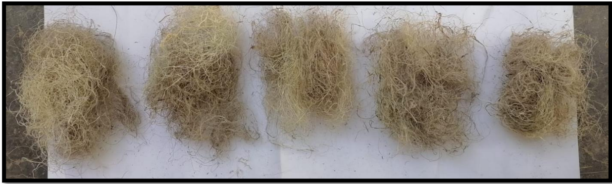
Ilustración 150 Dosificación de la Cabuya en 10%, 20%, 30%, 40% Y 50%
