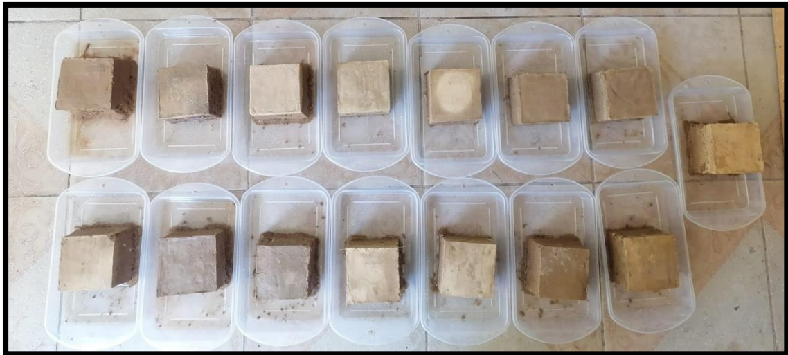
Ilustración 264 Resultados de la Prueba de absorción vista en planta
