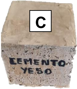
Ilustración 158 Resultado de probeta-cemento y yeso.
