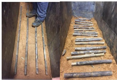
Ilustración 4 Disposición de las cañas longitudinal y transversalmente.
