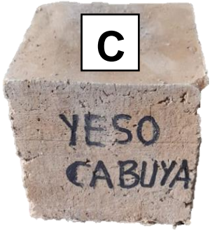
Ilustración 162 Resultado de probeta-yeso-cabuya.
