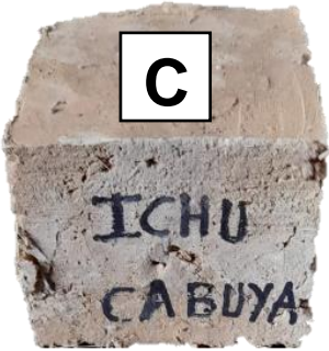
Ilustración 163 Resultado de probeta-cabuya-ichu.
