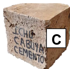
Ilustración 168 Resultado de probeta-cemento-ichu y cemento.
