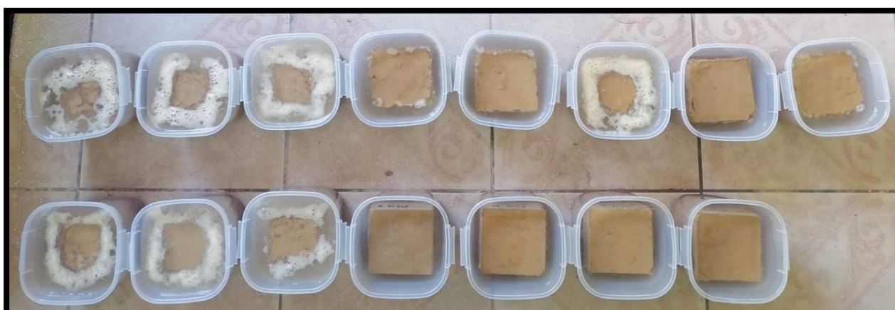
Ilustración 424 Resultados de la Prueba de Inmersión vista en planta
