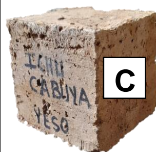
Ilustración 167 Resultado de probeta-yeso-cabuya-ichu.
