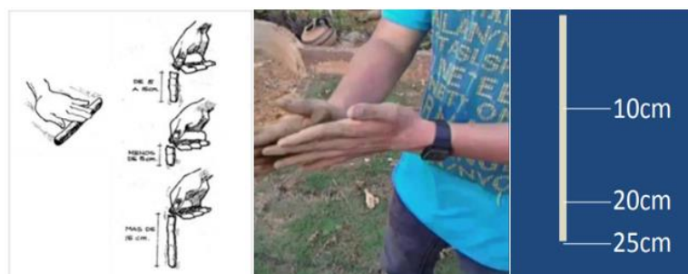
Ilustración 34 Prueba de cinta de barro, tomado de la Norma E080 diseño y construcción con tierra reforzada
