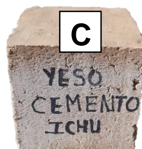
Ilustración 164 Resultado de probeta-yeso-cemento-ichu.
