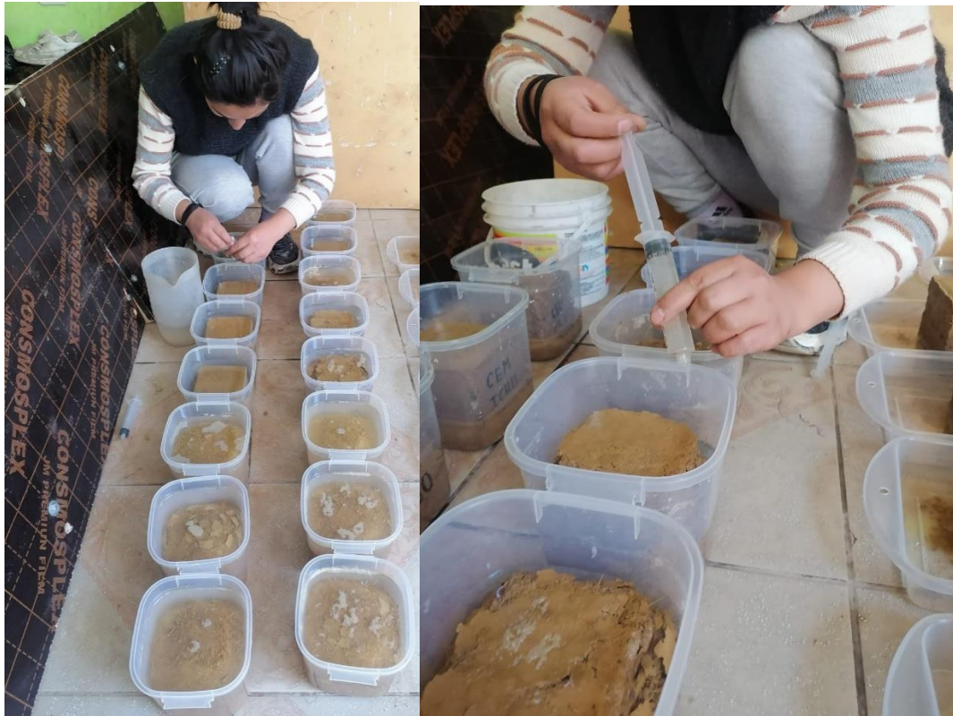
Ilustración 425 Detalle del retiro de agua de las pruebas de inmersión
