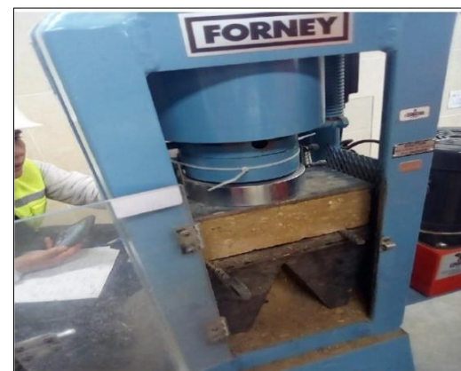
Ilustración 7 Realizando el ensayo a la resistencia a la flexión, tomado de VASQUEZ VASQUEZ, LIZAR
