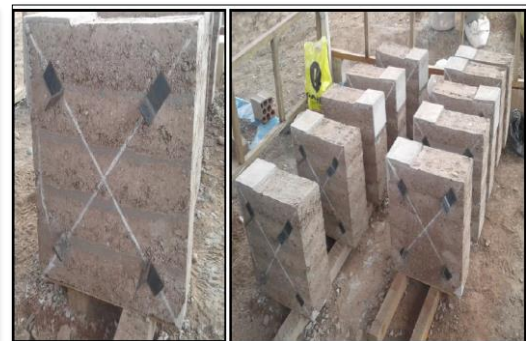
Ilustración 30 Colocado de angulares en las diagonales de los muretes, tomado de Chuqui Paucar, Wilfredo y Chalco Ruelas, Ronal Augusto.
