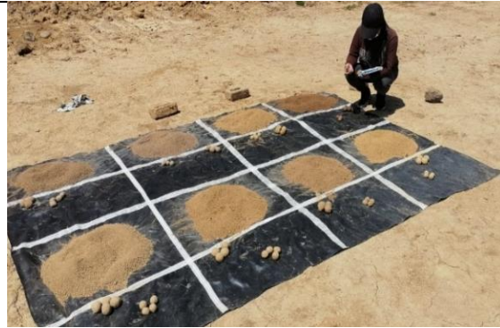
Ilustración 82 Resultado de la prueba de “Resistencia seca”
