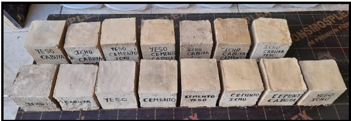
Ilustración 171 Muestras para la Prueba de Resistencia a la Compresión
