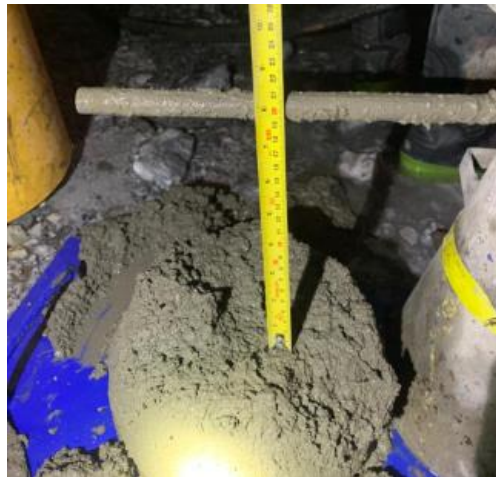
Figura 40. Medición de slump antes del lanzado
