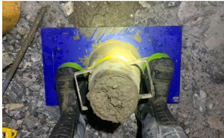
Figura 39. Pruebas de slump en interior de la mina con el cono Abrams
