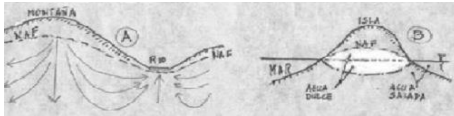
Figura 25. Nivel freático regional: A. bajo una montaña, B. bajo una isla Se ilustran con flechas el flujo del agua y en línea punteada el NAF
