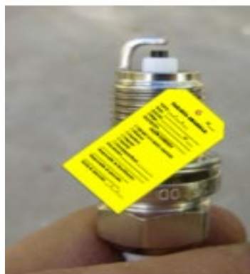
Figura 49. Uso de la tarjeta amarillas en Bujías en buen estado.
