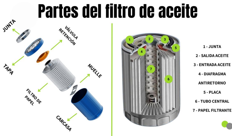
Figura 7. Filtro de aceite. Tomada de “RO-DES: ¿Partes de un filtro de aceite?”, por Alabajos, 2019.
