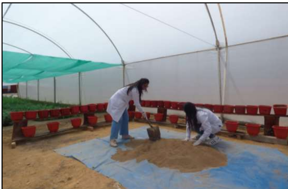
Fotografía 6. Homogenización de las muestras simples para obtención de la muestra compuesta.
