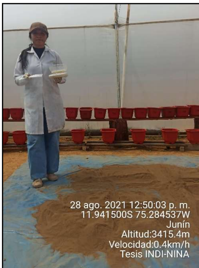
Fotografía 8. Preparado de muestra compuesta para análisis de Pb
