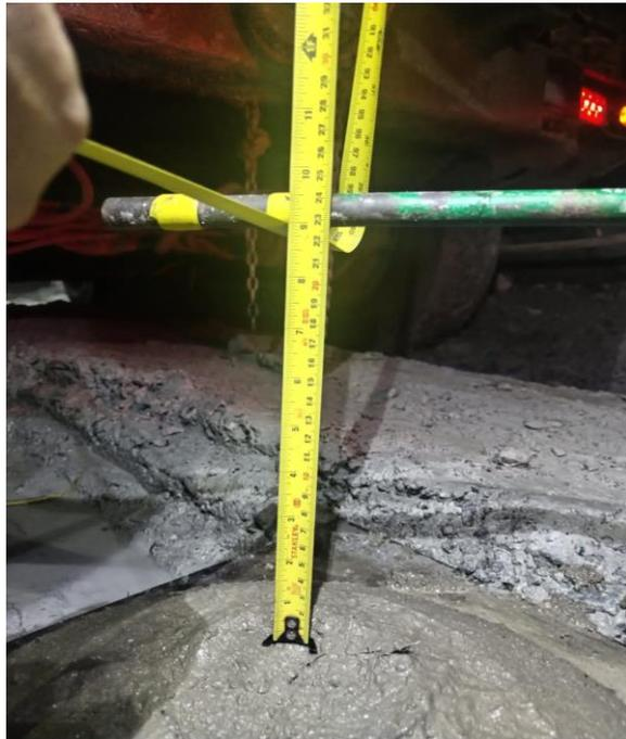
**Figura 10. Cálculo del slump de shotcrete, Cx 2713, Nv 1565**
