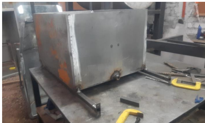
Figura 51. Fabricación tanque de almacenamiento
