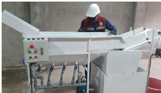
Figura 55. Inspección de lavado de espinacas
