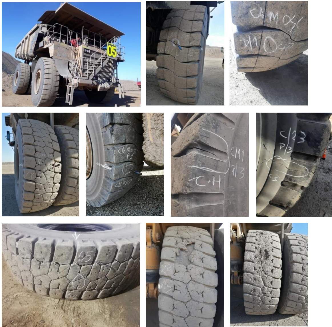
Figura 2.1. Daños de neumáticos.
