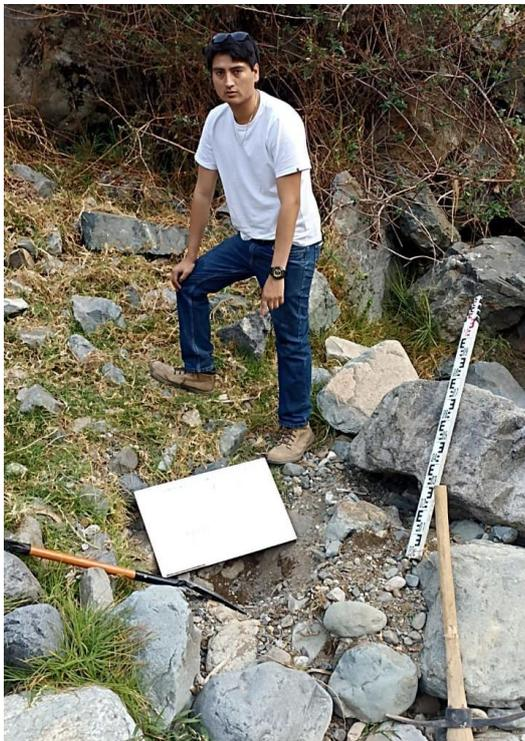
Fotografía 4. Arriba se observa la ejecución de la calicata en ribera del río Chacchan.
