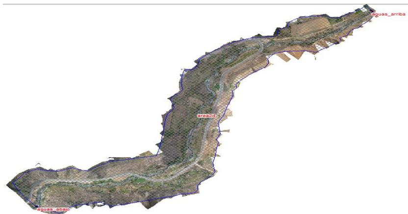
Figura 10. Configuración de Geometría en HEC-RAS 6.3.
