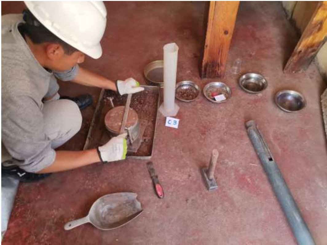
Fotografía 15. Nivelación de la muestra
