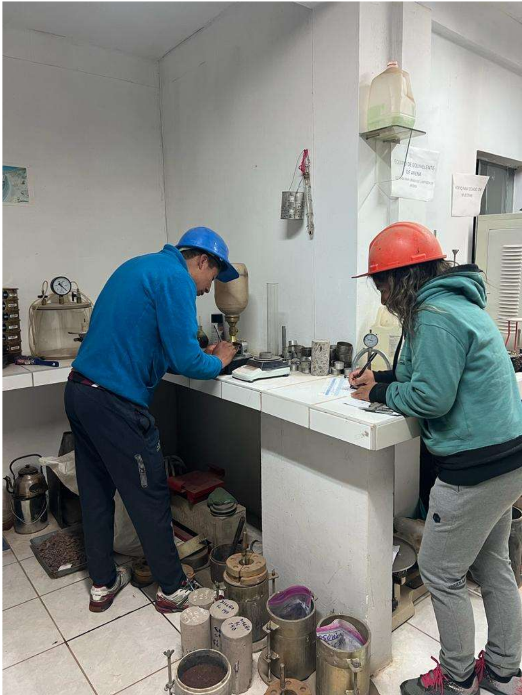
Fotografía 8. Toma de datos del peso de las muestras
