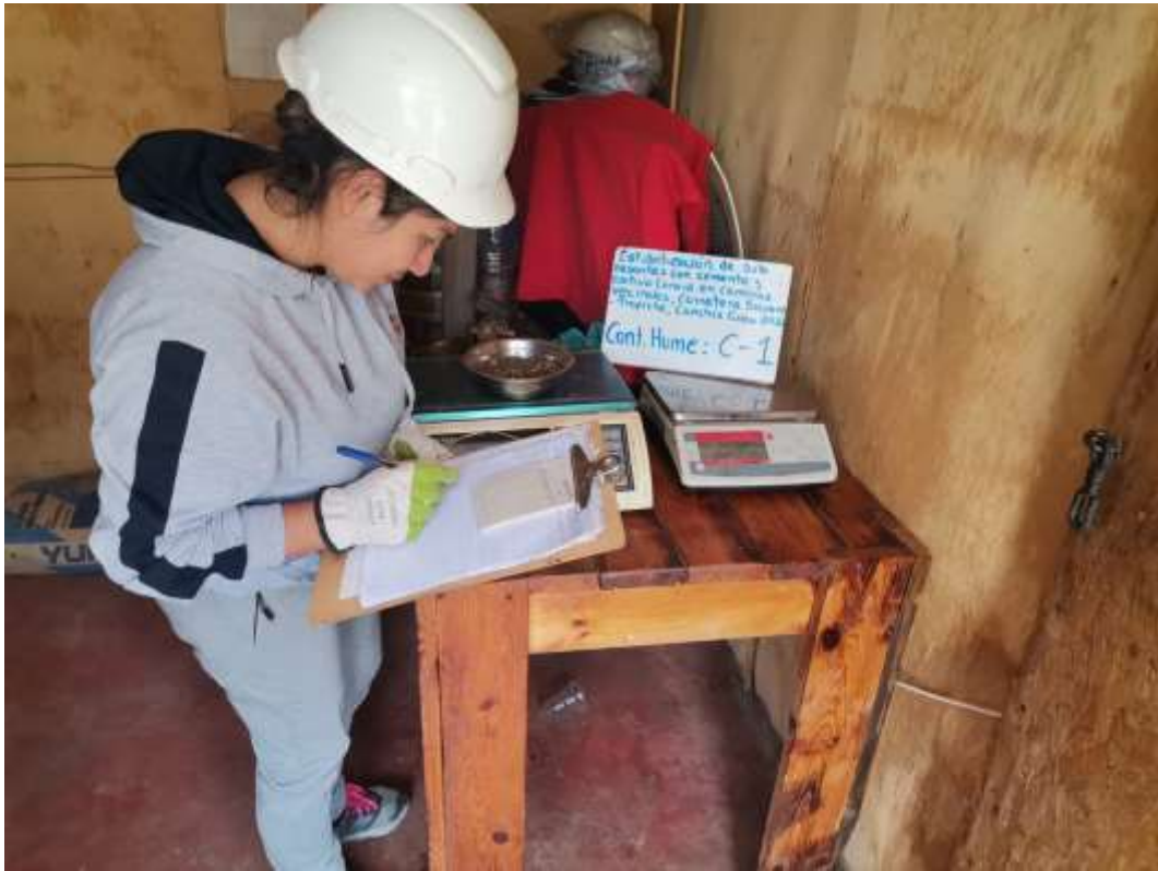
Fotografía 12. Toma de datos del contenido de humedad
