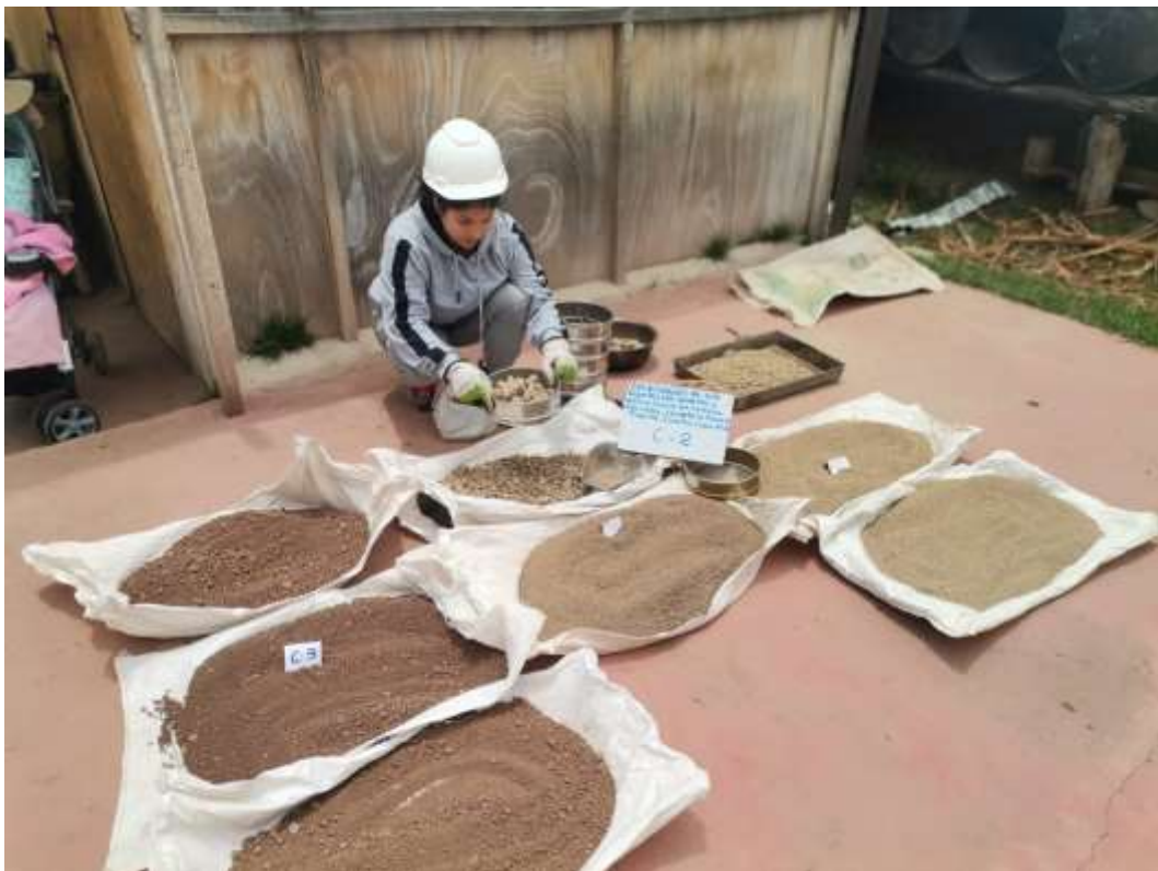
Fotografía 7. Obtención de material después del tamizado
