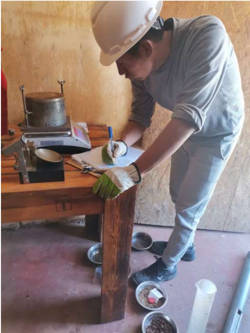
Fotografía 11. Toma de datos para plasticidad
