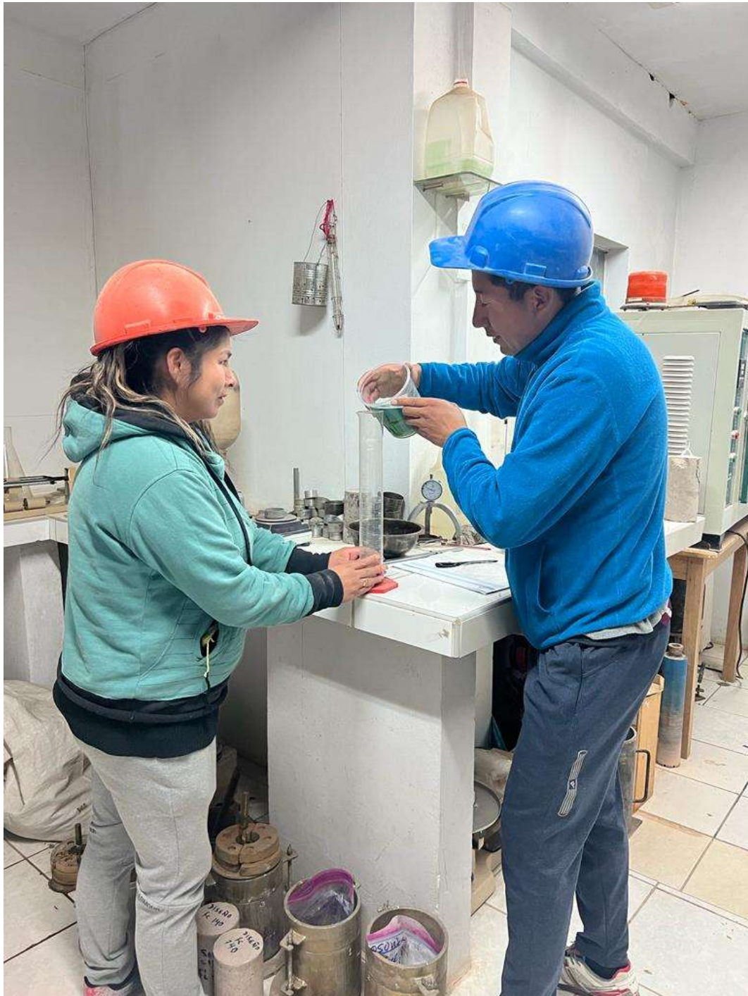
Fotografía 10. Colocación de muestra en la probeta
