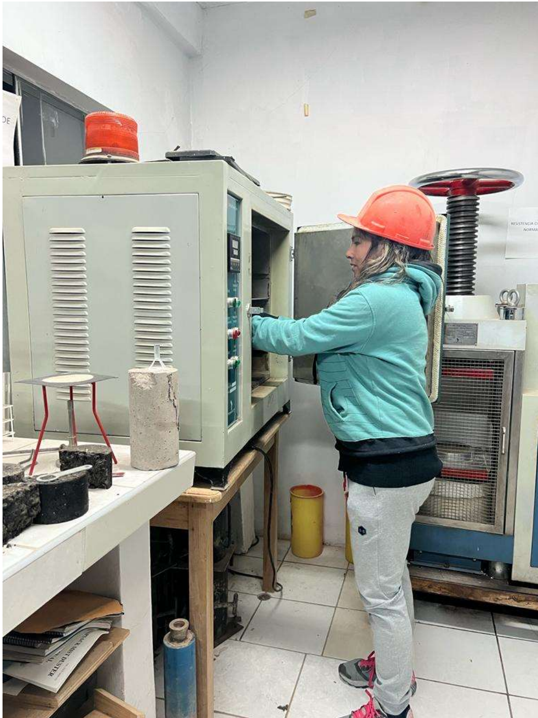
Fotografía 9. Inserción de muestras en el horno
