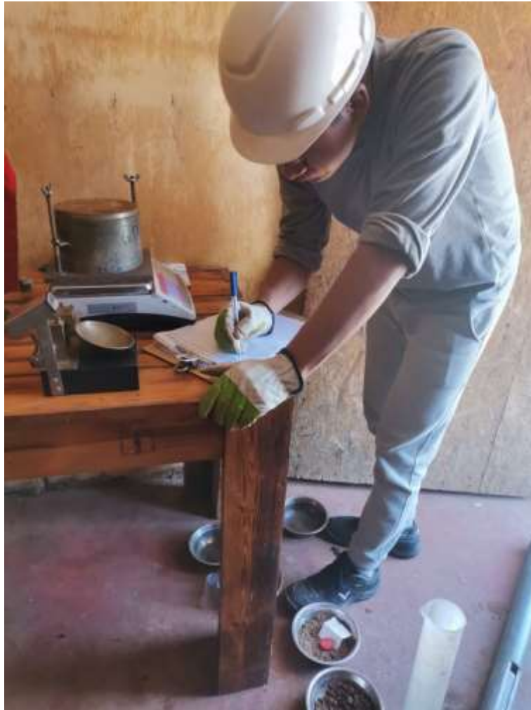
Fotografía 3: Ensayo de Límites de Consistencia
