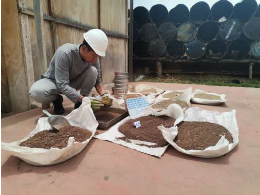
Fotografía 6. Tamizado de material obtenido de las calicatas
