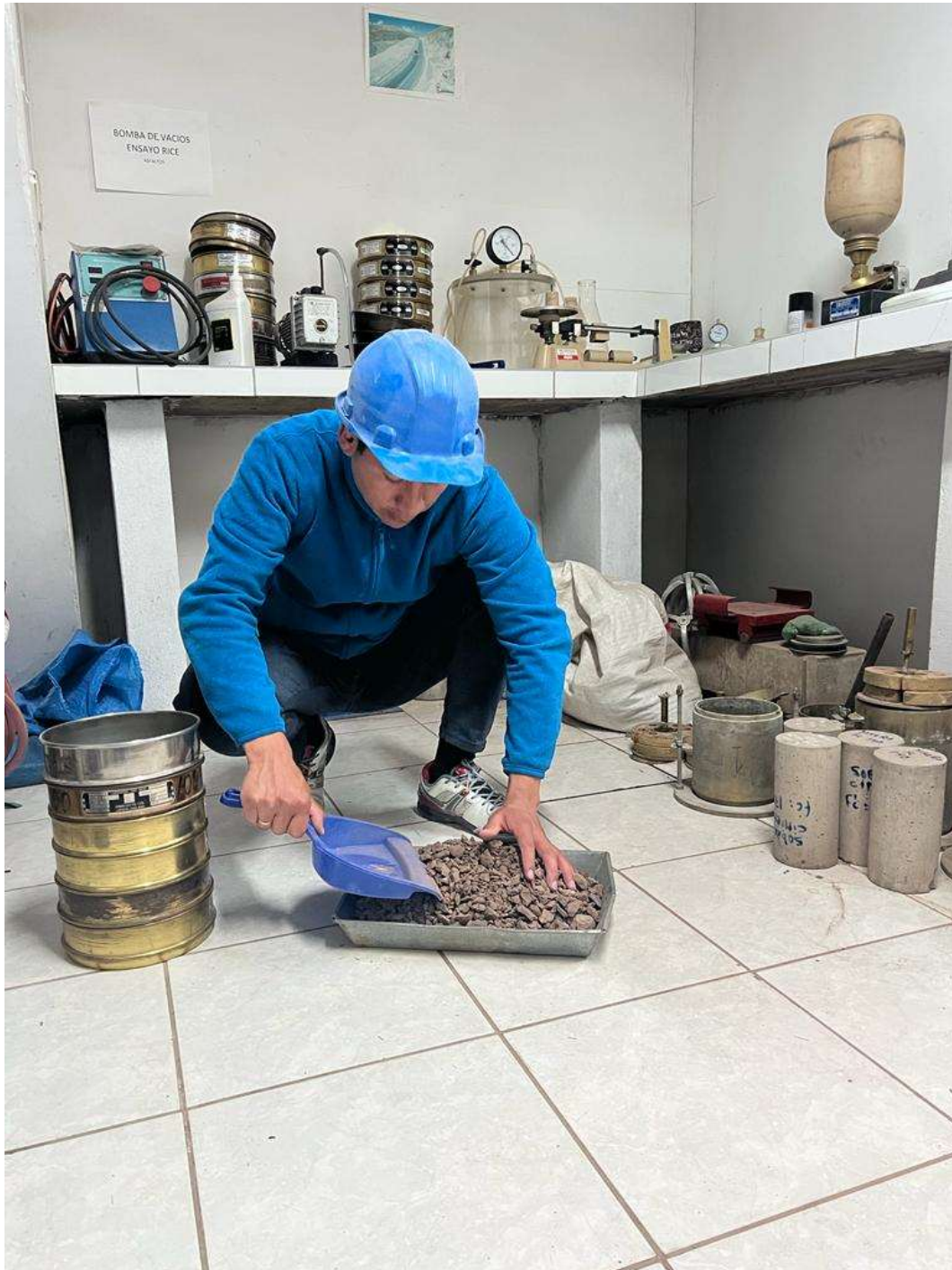
Fotografía 13. Colocación del material grueso en los tamices
