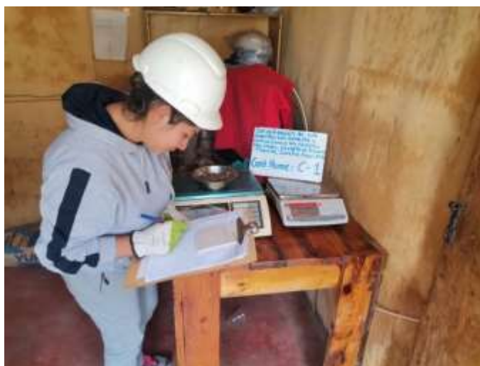
Fotografía 5: Ensayo de CBR
