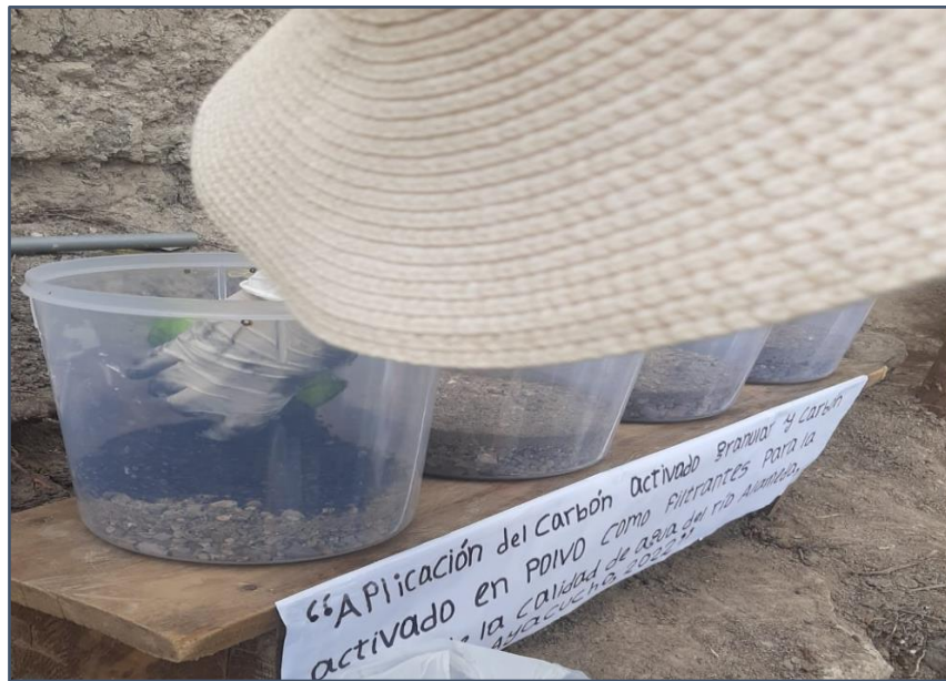
Figura 8.- Preparación de los filtros, con las respectivas capas como: piedra chancada, grava, gravilla, arena gruesa y carbón activado granular y en polvo.
