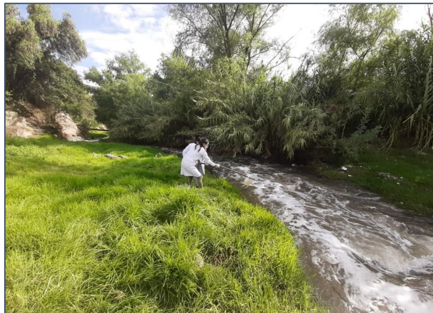
Figura 6.- Recojo de agua del río Alameda, al recipiente principal de 30 l, para su respectiva homogenización y para luego ser distribuidos a los 8 filtros y una muestra de caracterización.
