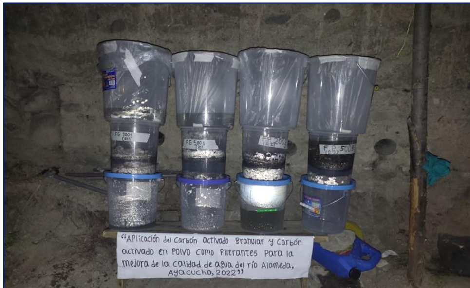
Figura 4.- Proceso de filtración de agua, colectadas del río Alameda.
