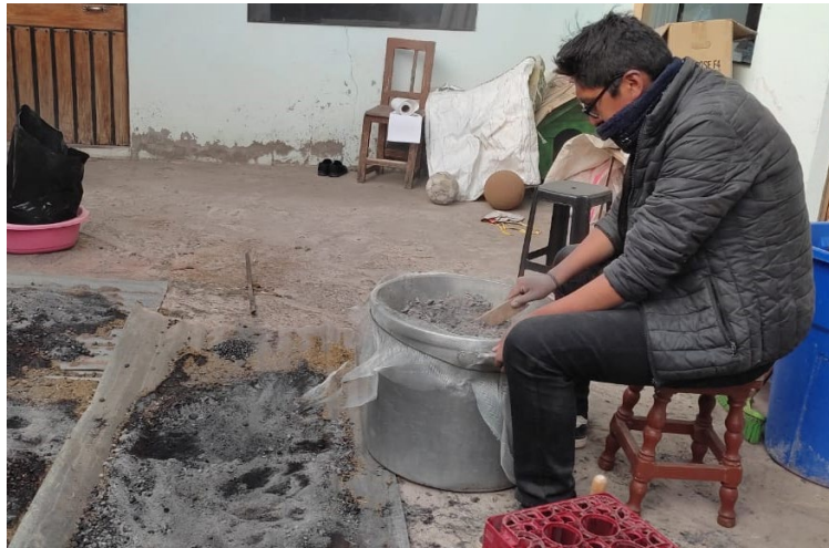
Figura 58 Obtención de las partículas más finas de la ceniza del estiércol de ovino
