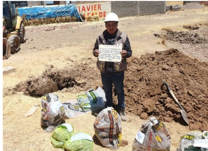
Figura 61 Exploración de la Calicata 3
