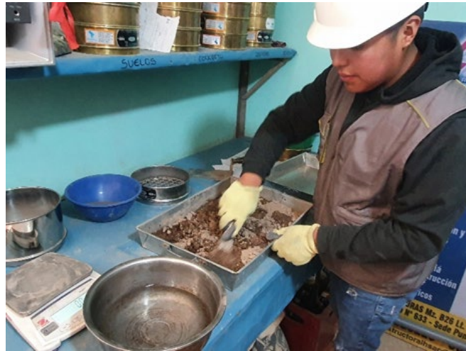
Figura 67 Ensayo de óptimo contenido de humedad
