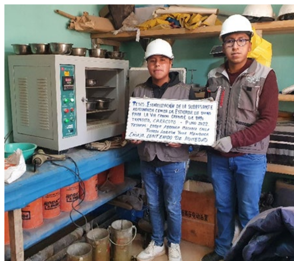
Figura 63 Ensayo de Contenido de humedad
