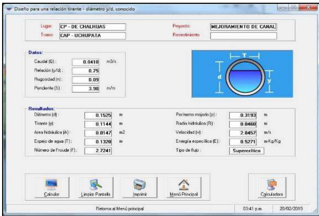
Figura 27. Imagen del cálculo de canal en el programa H Canales.
