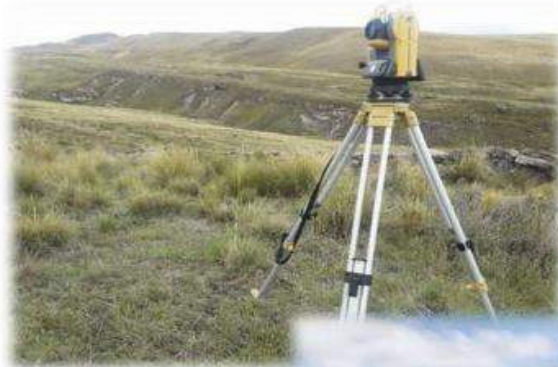
LEVANTAMIENTO TOPOGRAFICO CON ESTACION TOTAL DE LA LINEA DE CONDUCCION
