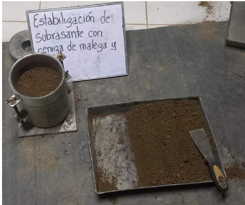
Figura 2. Ensayo de Proctor modificado.
