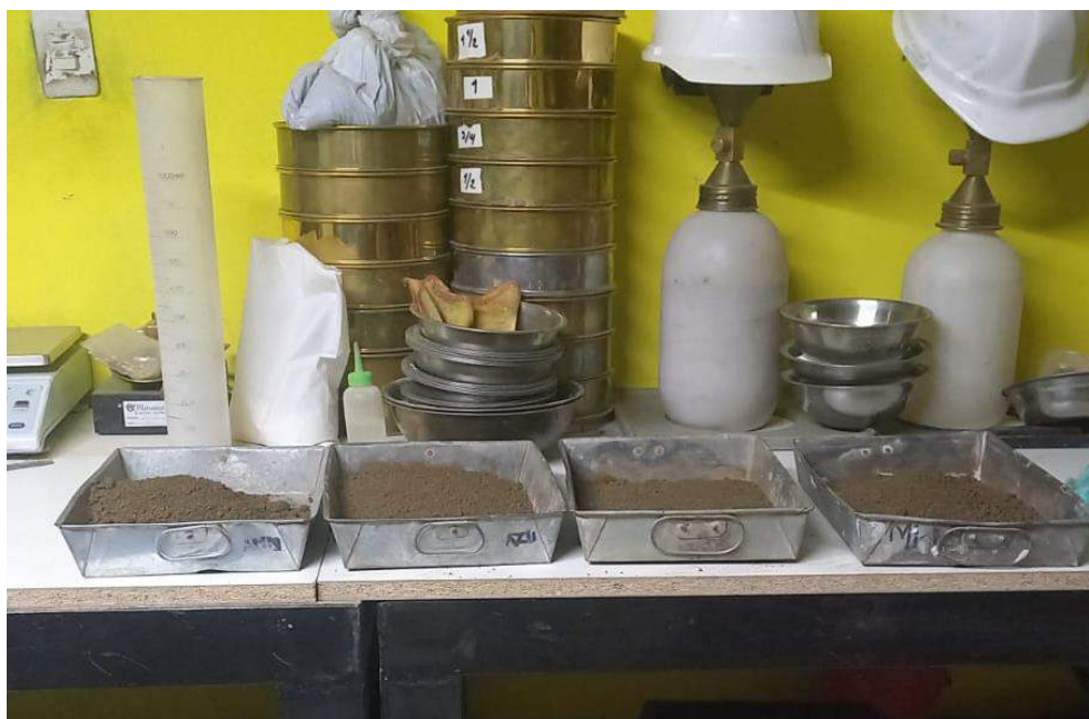
Fotografía 9. Ensayo de clasificación de suelos al suelo natural de la calicata.
