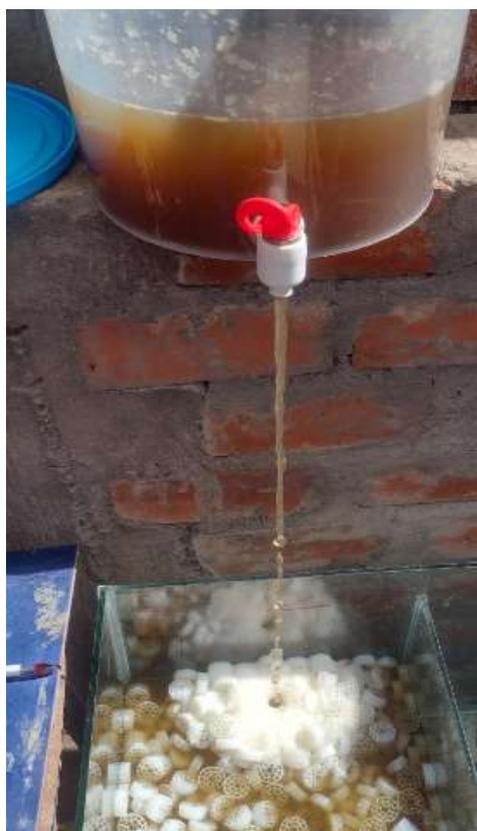
*Figura 57. Agregado de Agua Residual a Cámara 2*
