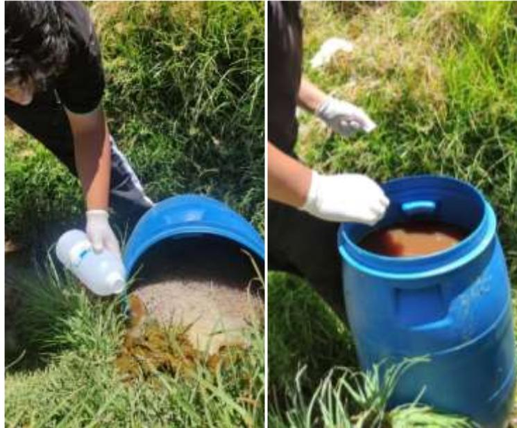
*Figura 6. Toma de muestra del agua residual*
