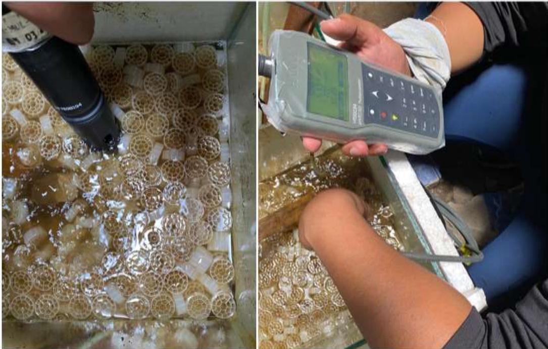
*Figura 61. Toma de Temperatura y pH de la cámara 1 con Multiparámetro*
