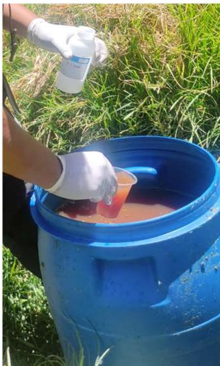
*Figura 48. Toma de muestra de Agua Residual del Camal Municipal*
