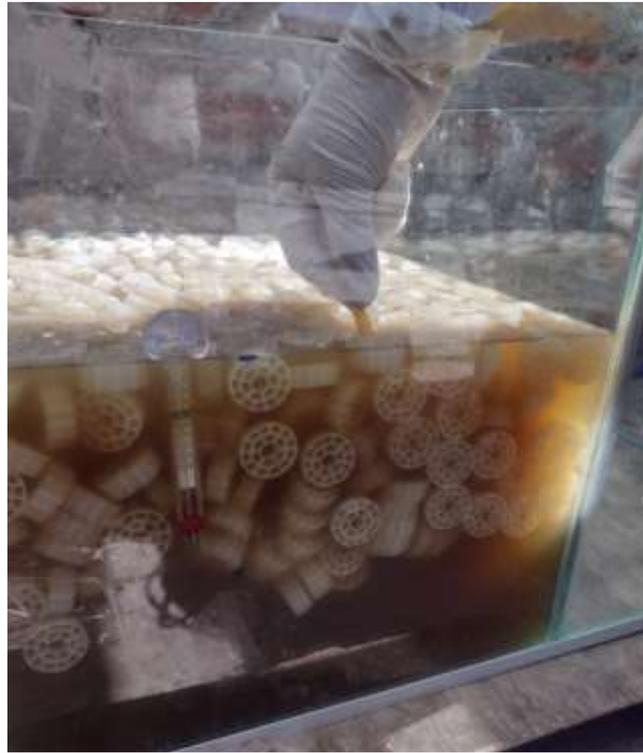
*Figura 60. Toma de Temperatura y pH*
