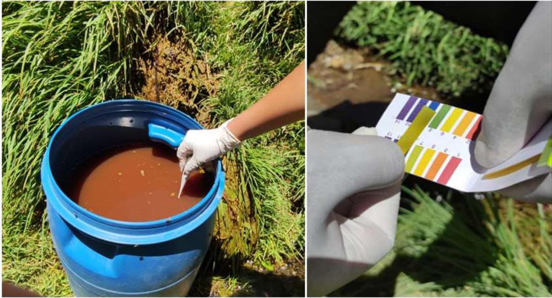
*Figura 50. Toma de Temperatura y pH de la muestra de Agua Residual del Camal*
