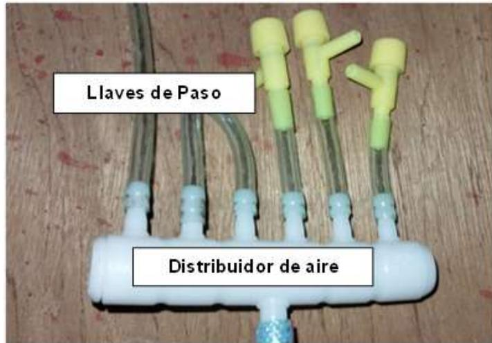
*Figura 11.* Distribuidor de aire y llaves de paso
