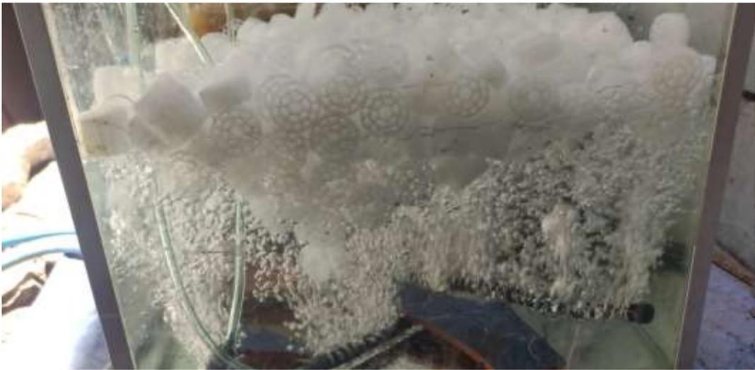
*Figura 55. Prueba con Carriers en Cámara 2*
