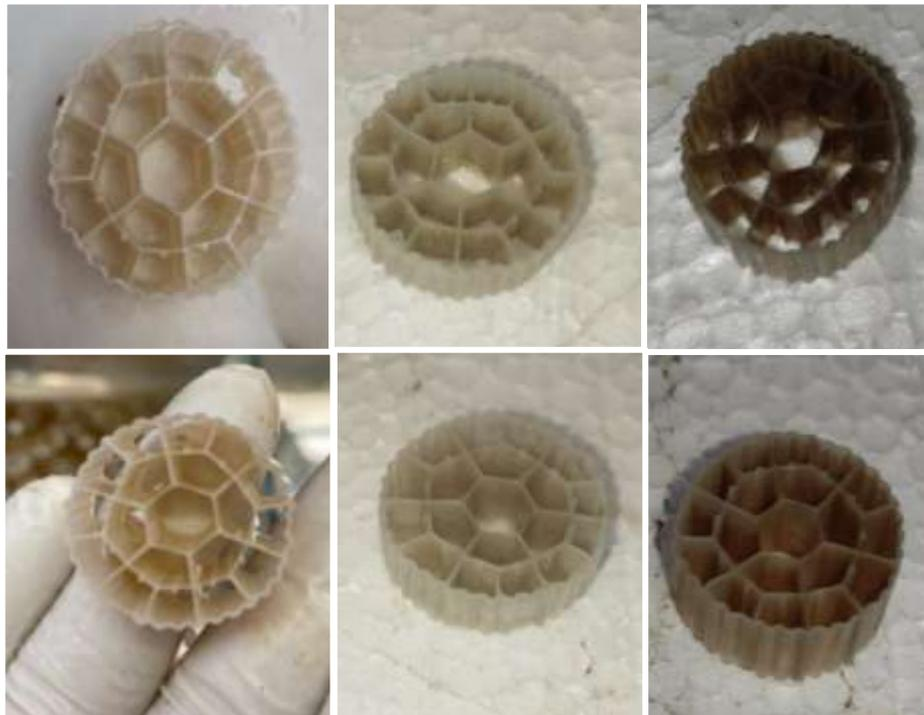
*Figura 66. Formación de Biofilm (Cámara 1 y 2)*
