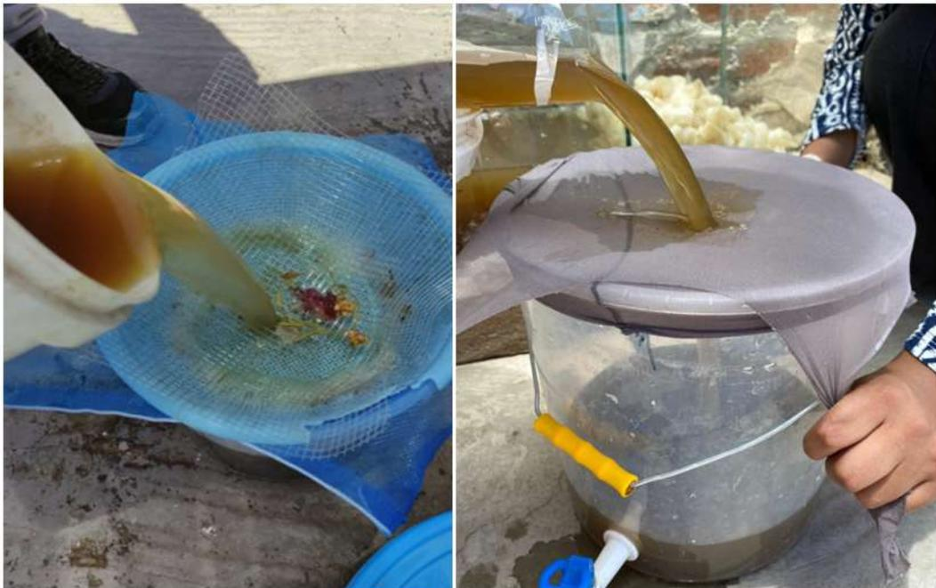
*Figura 51. Adaptación del Pre Tratamiento del Agua Residual "Cámara de Rejas"*
