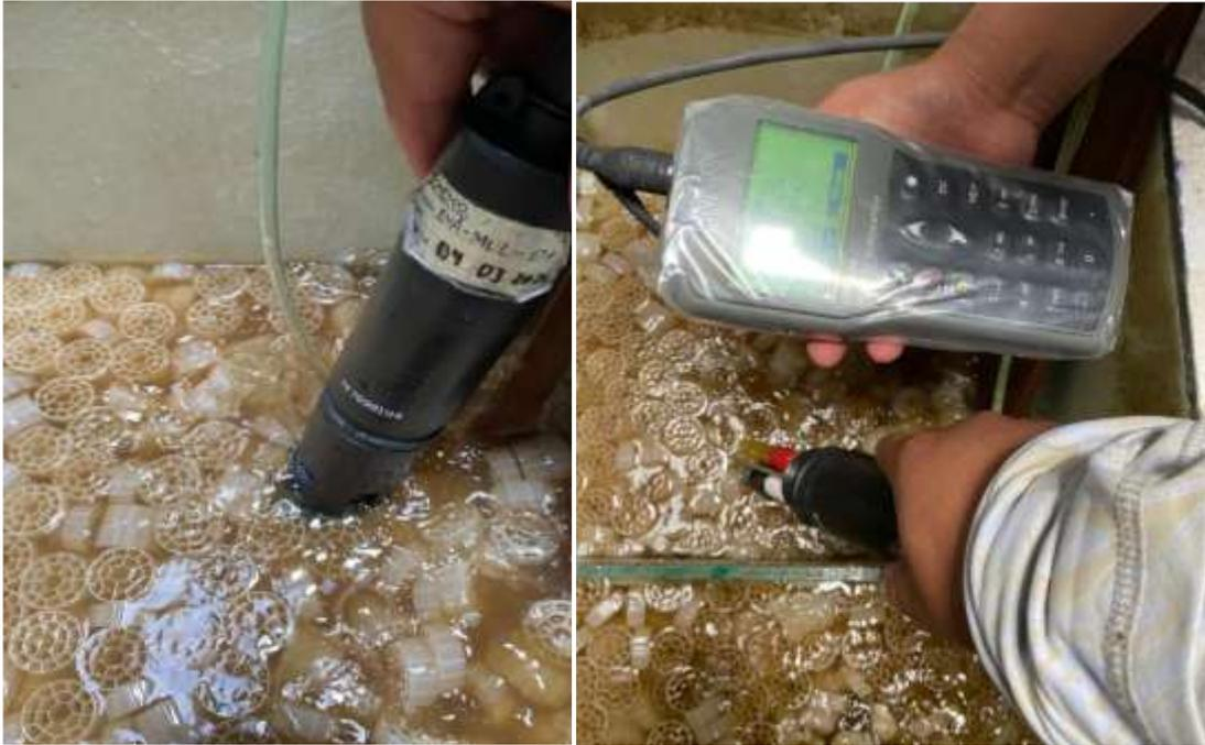
*Figura 62. Toma de Temperatura y pH de la cámara 2 con Multiparámetro*
