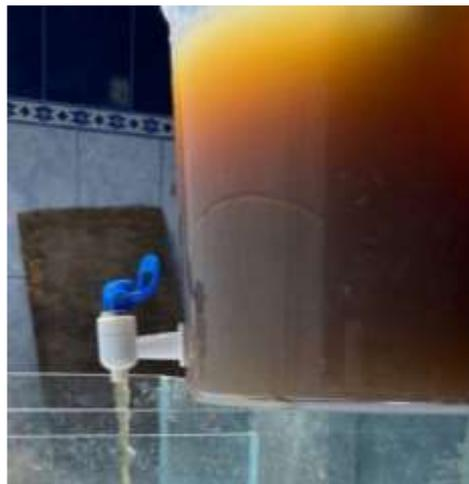
*Figura 17.* Trampa de grasas y sedimentador convencional
