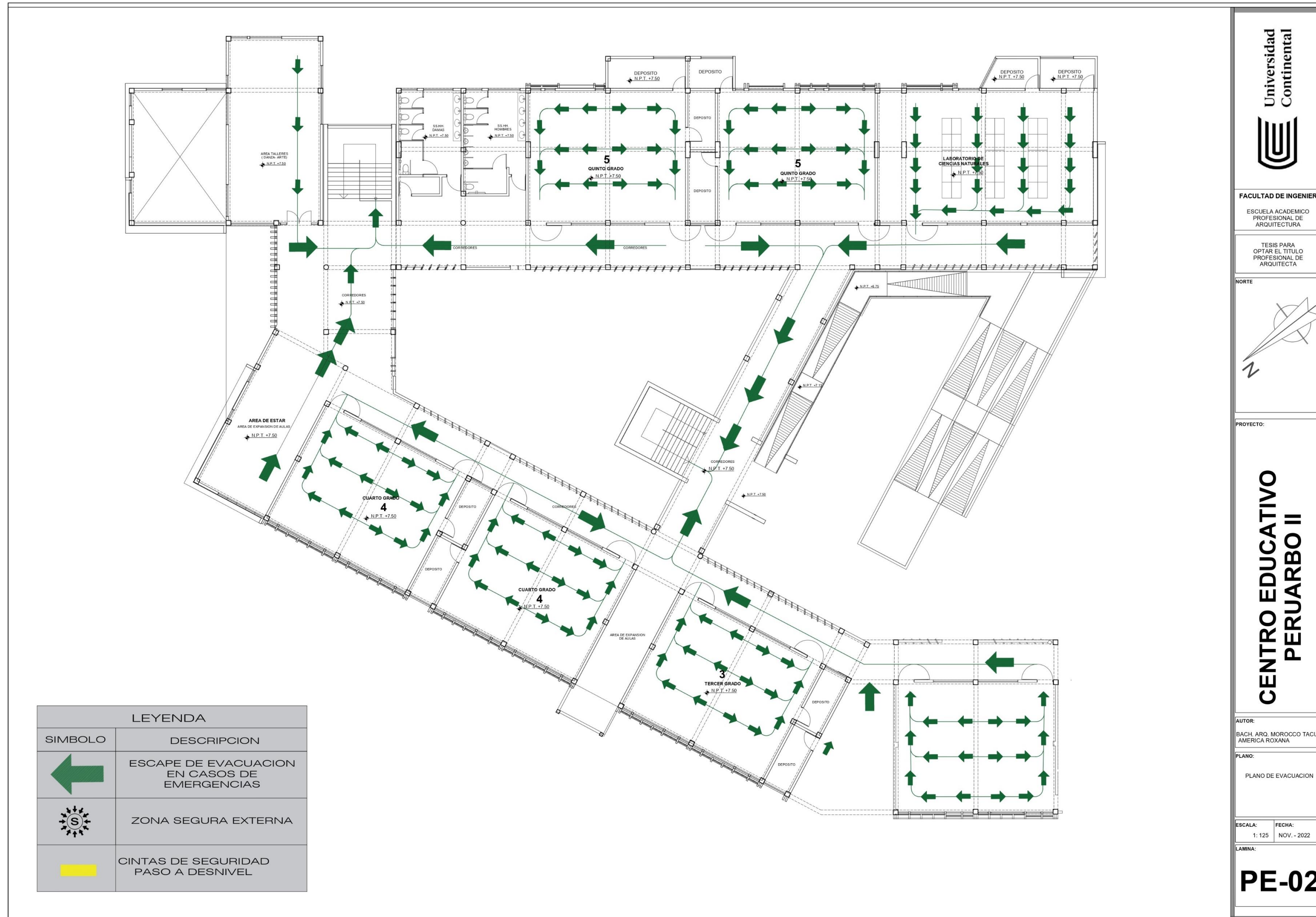
Planta de evacuación- segundo nivel
