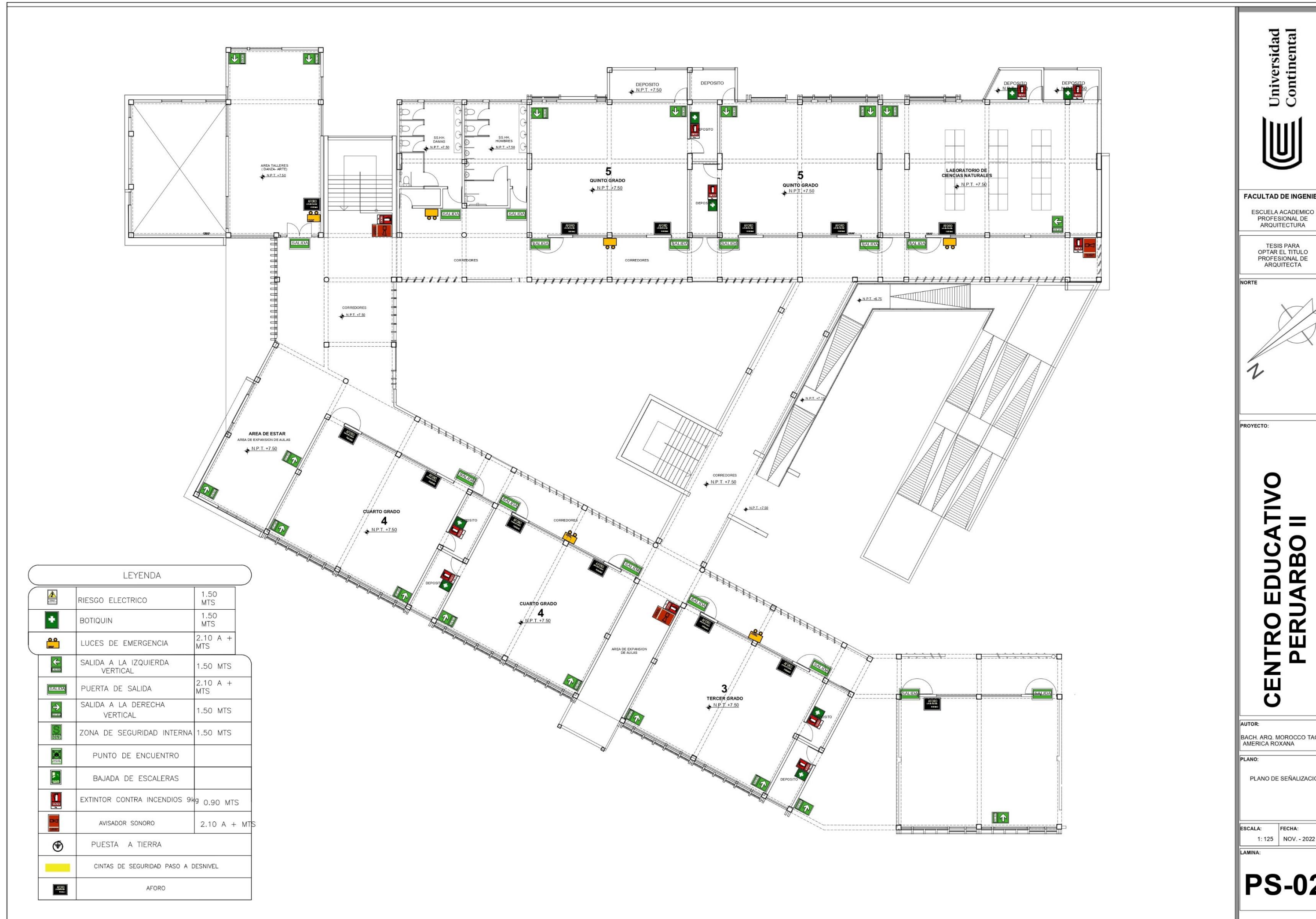
Planta de señalización – segundo nivel
