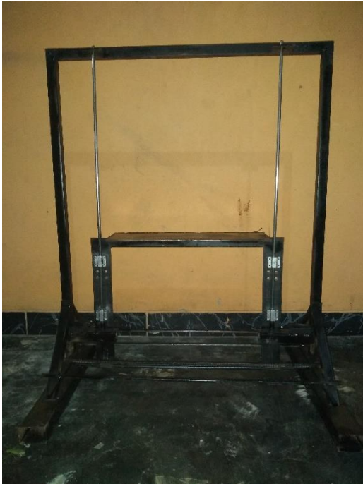
Anexo 1. Dispositivo para experimento de la fuerza de corte para ladrillo arcilla húmedo.
