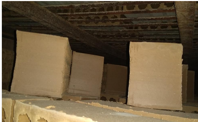
Figura 2. Corte del ladrillo King Kong.
