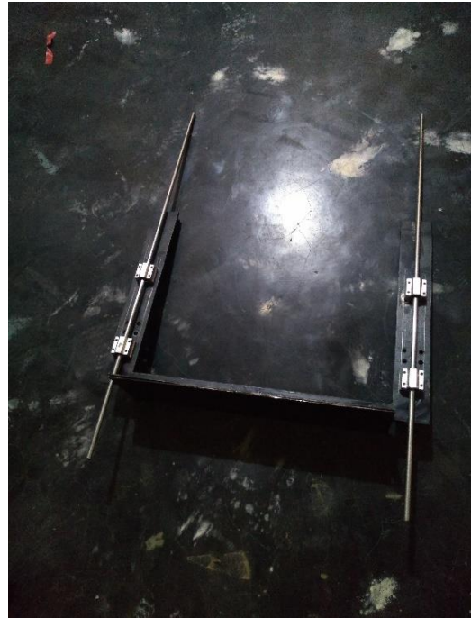
Anexo 1. Dispositivo para experimento de la fuerza de corte para ladrillo arcilla húmedo.
