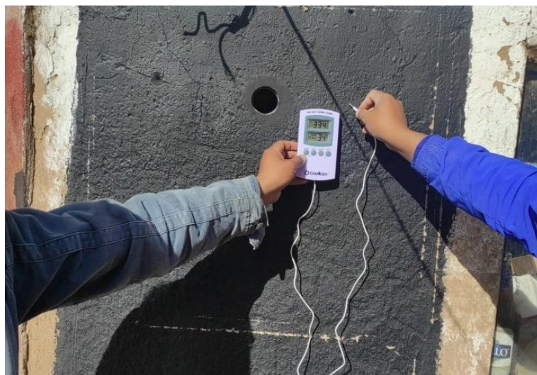
Figura 28. Toma de temperatura después de la pared negra
