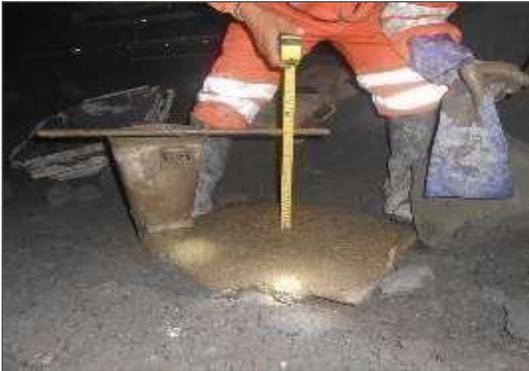
Figura N. 21. Medición de Slump en Interior Mina
