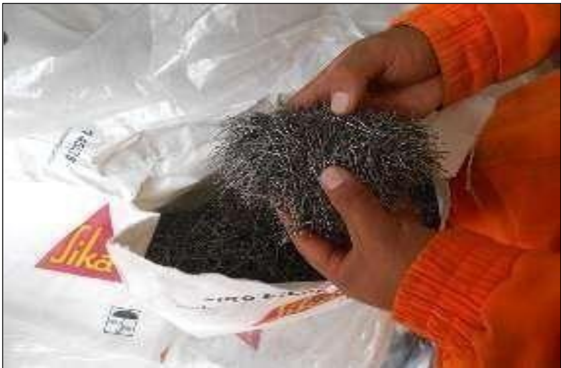
Figura N. 10. Fibras de acero Sika LHO 45/35 NB para refuerzo del shotcrete (10).
