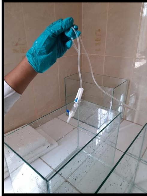
Fotografía 11: Venocllisis adaptado para bombeo de aire
