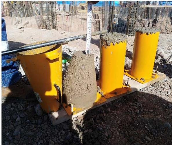
*Figura 64. Ensayo de consistencia de concreto y la confección de probetas.*
