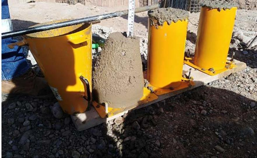
*Figura 57. Prueba de Slump y muestras de testigos de concreto*
