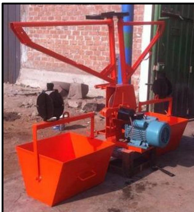
**Figura 23. Instalación de wincha eléctrica**
