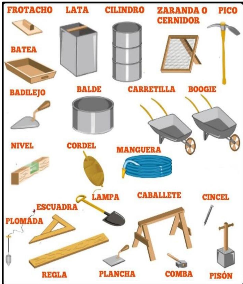
Figura 3. Herramientas empleadas en la construcción
