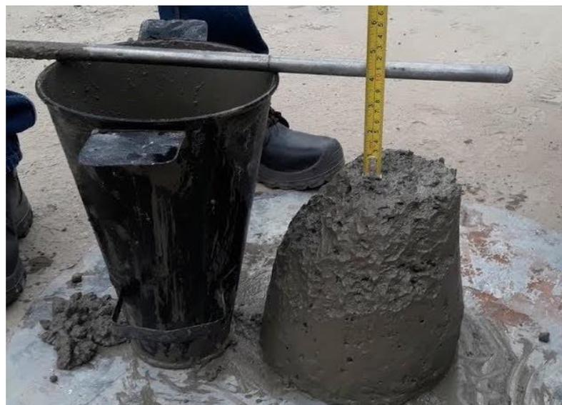
**Figura 46. Prueba cono de Abrams**
