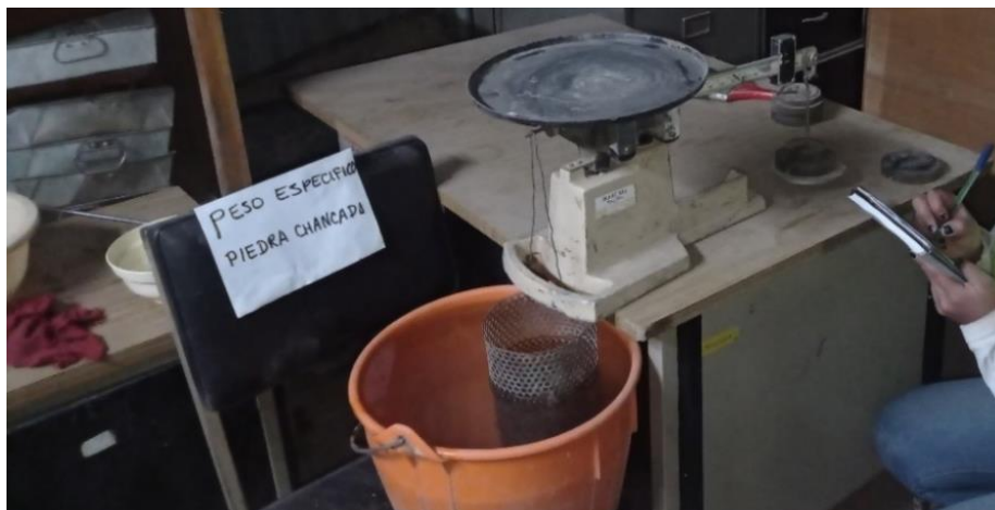
Figura 26. Peso específico del agregado grueso
