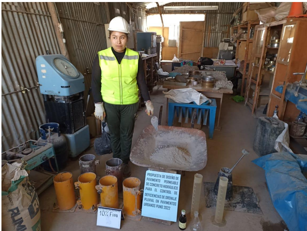
Vaciado de concreto permeable con 10% de agregado fino
