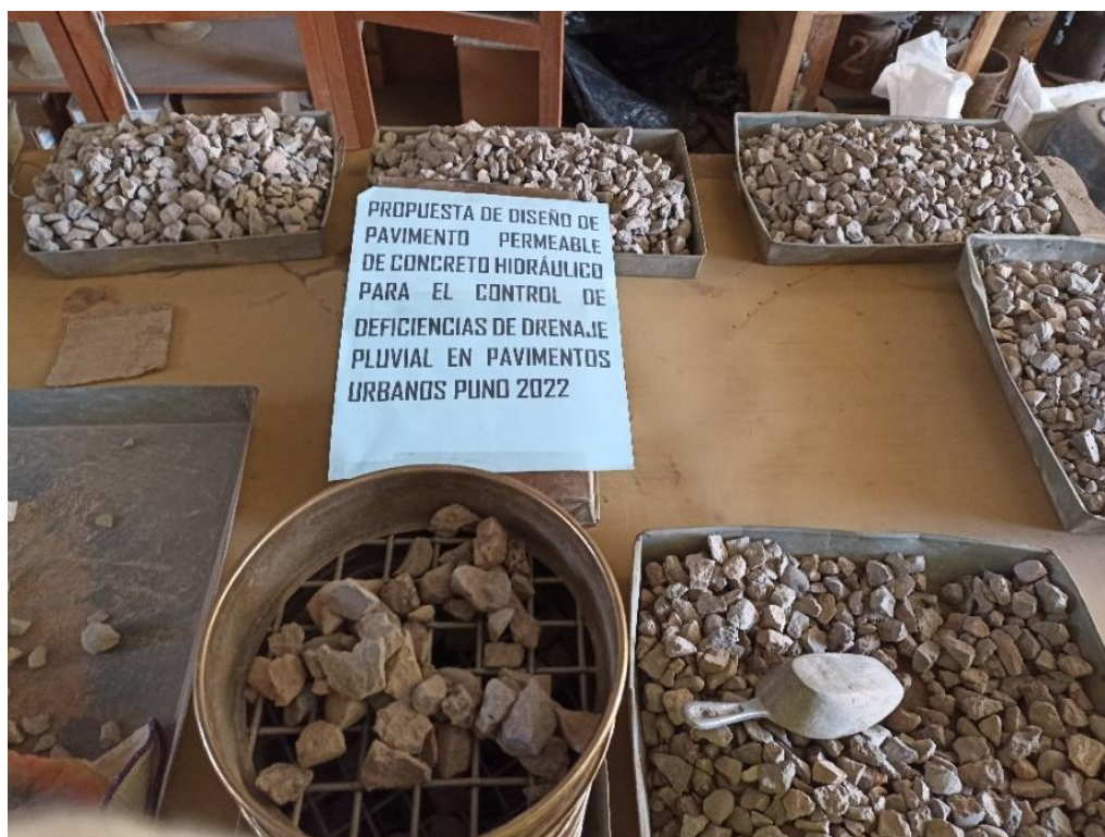
Figura 16. Tamizado de Piedra Chancada (Grava)
