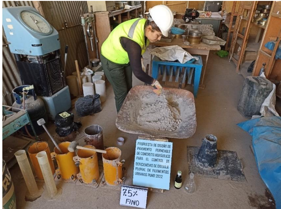
Figura 32. Colocación de aditivo sika fume a la mezcla
