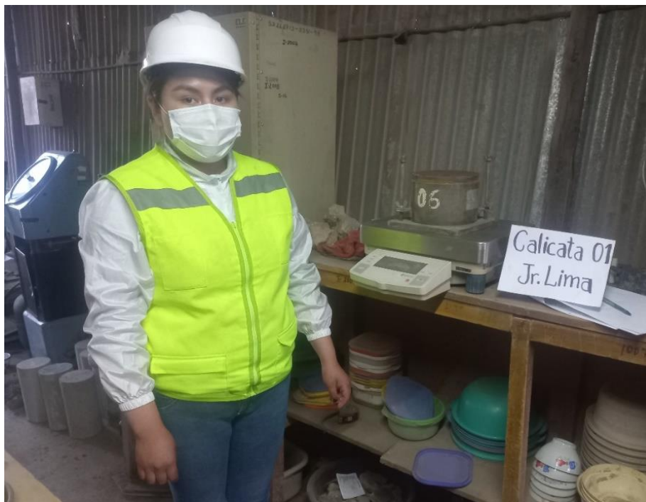
Figura 62. Pesaje de molde más muestra húmeda (Proctor Modificado).
