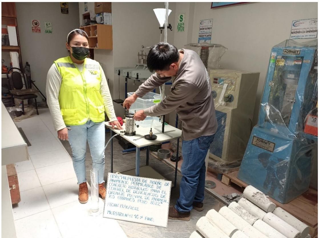
Prueba de permeabilidad con 10% de agregado fino
