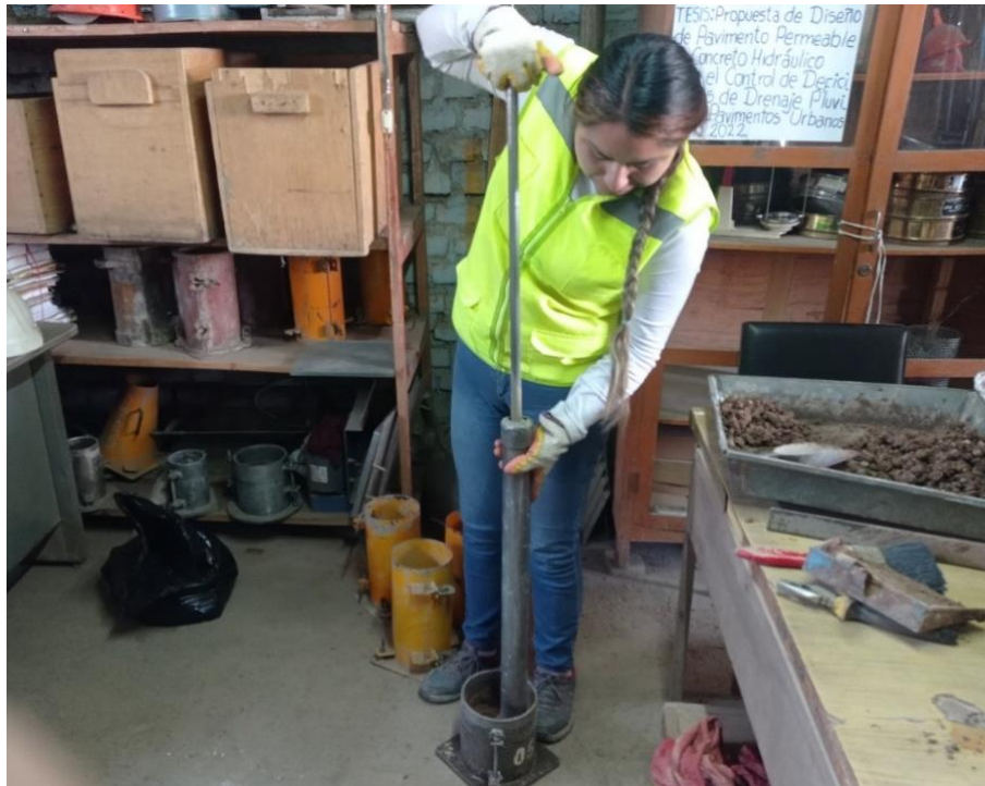
Figura 61. Prueba de Proctor Modificado
