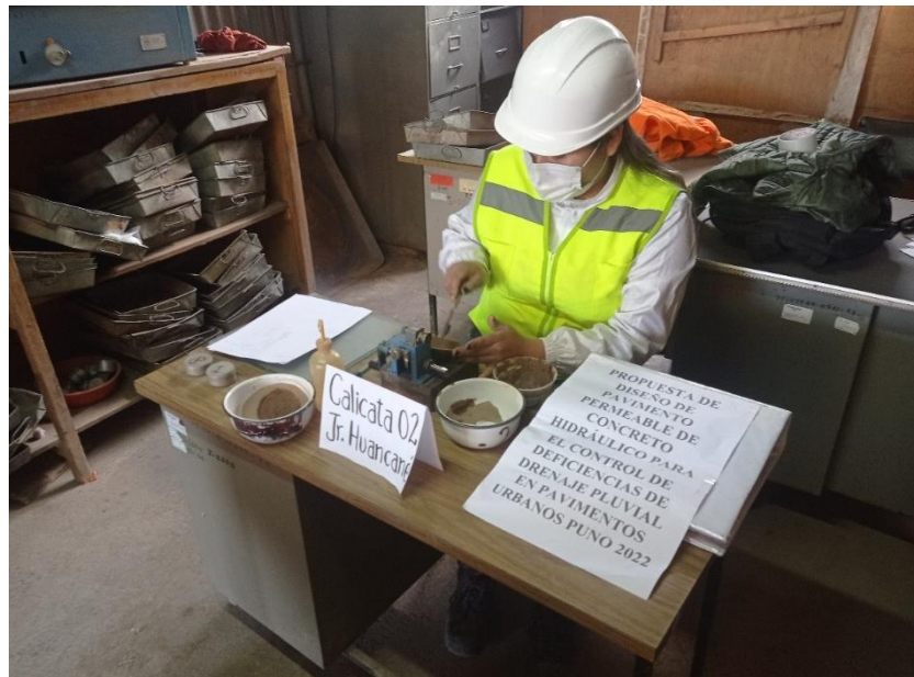
Figura 58. Ranurando en el centro de la muestra
