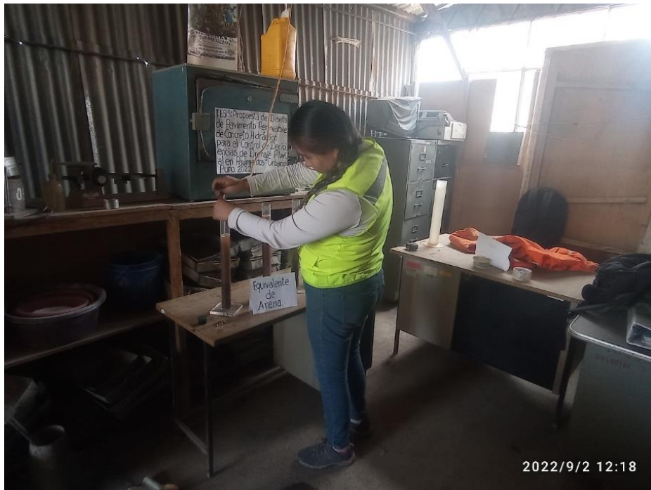
Figura 28. Proceso de girado de varilla lentamente.
