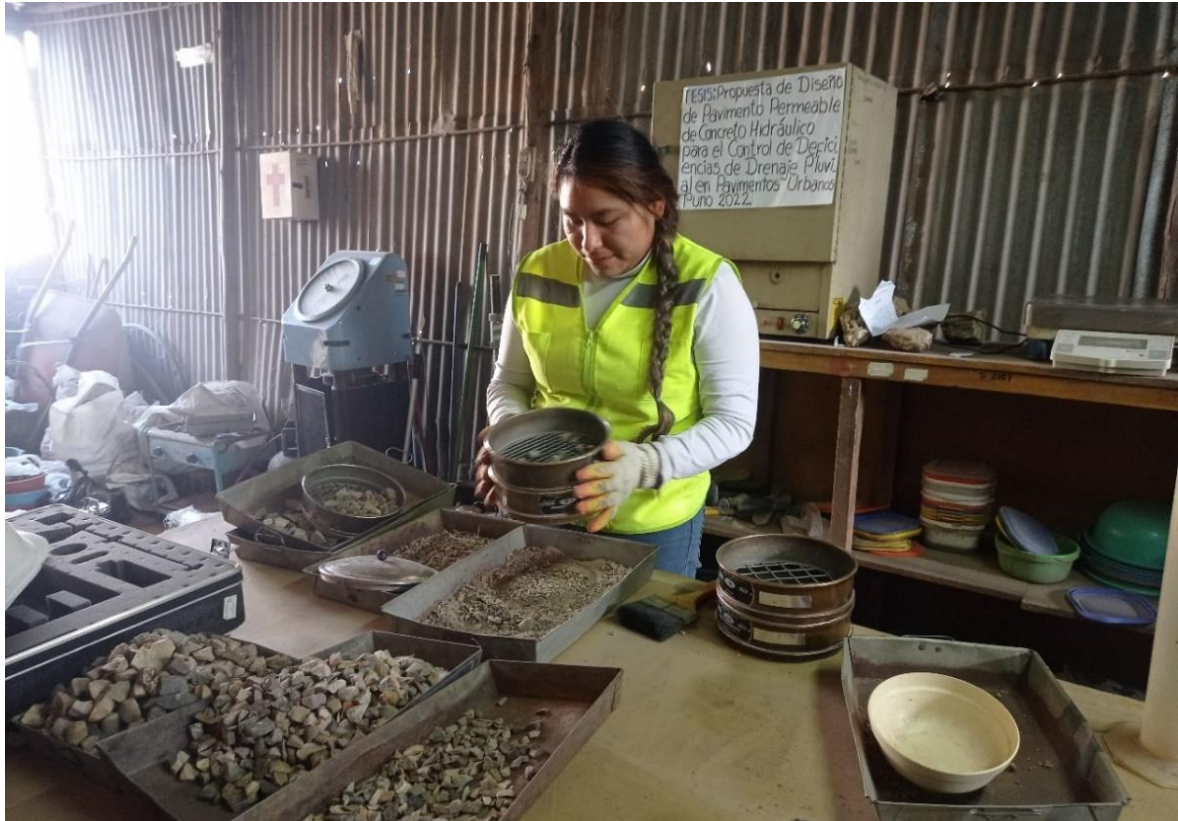
Proceso de tamizado de los agregados
