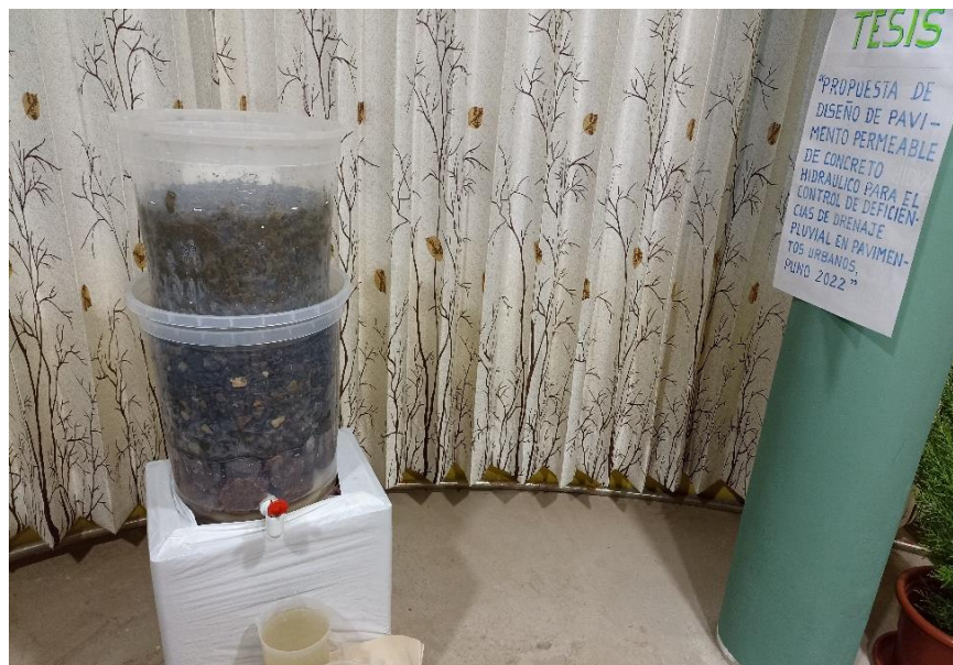
Figura 49. Prototipo a escala de estructuración del pavimento
