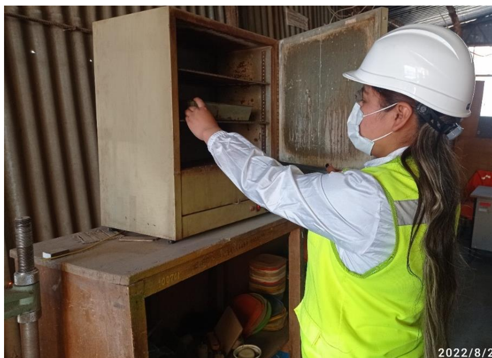
Figura 53. Secado de muestras de suelo para determinar el % de humedad
