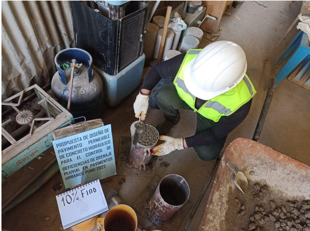
Moldeado de diseño de mezclas con 10% de finos en 3 probetas
