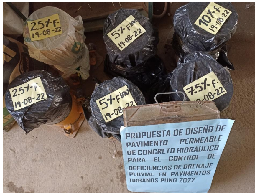
Figura 35. Proceso de curado inicial
