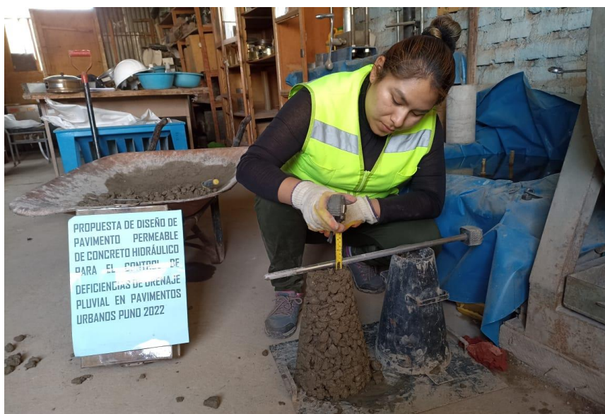
Figura 38. Asentamiento de concreto permeable
