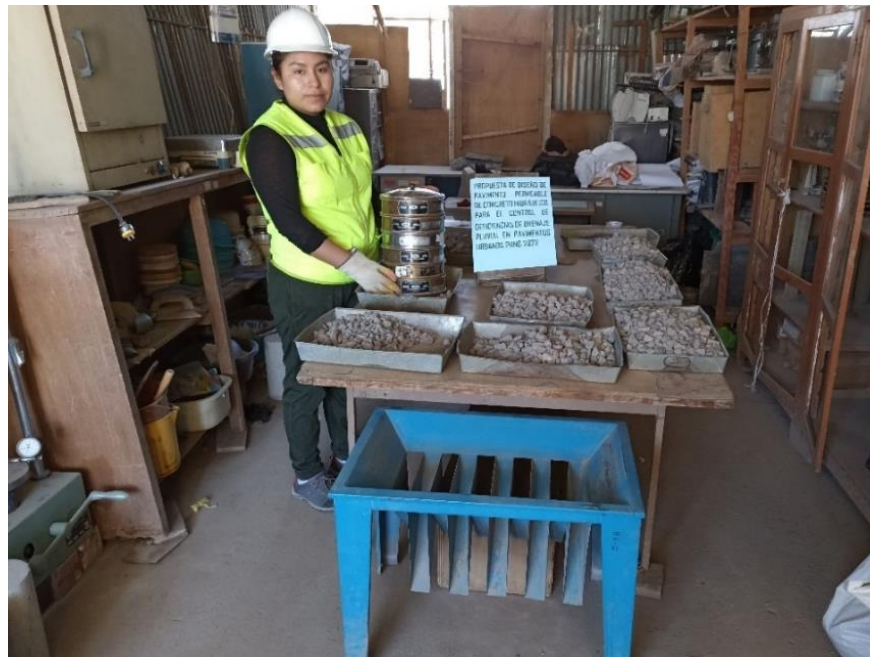
Figura 18. Tamizado del agregado fino (Cantera Isla)
