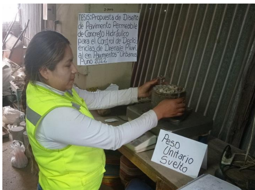
Figura 20. Peso de molde + muestra suelta inicial
