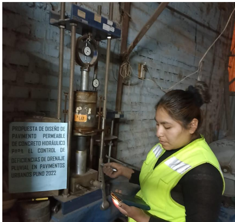
Figura 65. Lectura de CBR controlando tiempo C-1
