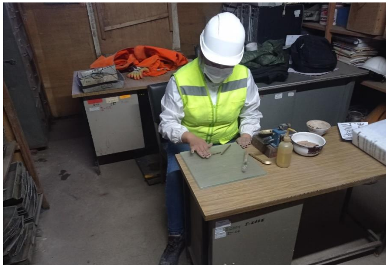
Figura 59. Realizando el rodado del cilindro con los dedos
