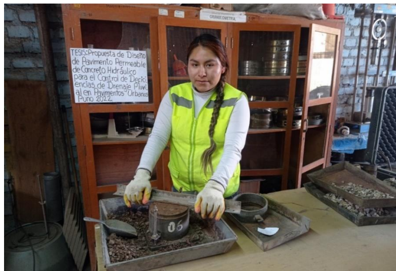
Figura 60. Enrasado de la muestra en el molde Proctor
