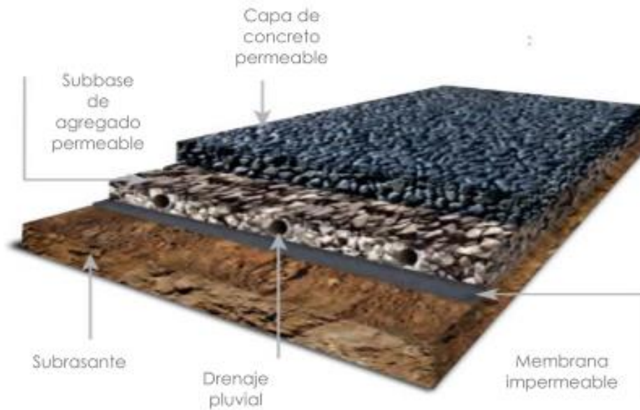
Figura 10. Diseño de estructura de Pavimento Permeable
