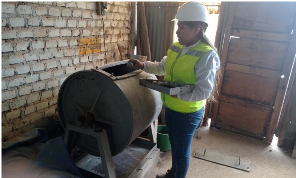
Figura 30. Colocación de esferas a la maquina Los Ángeles
