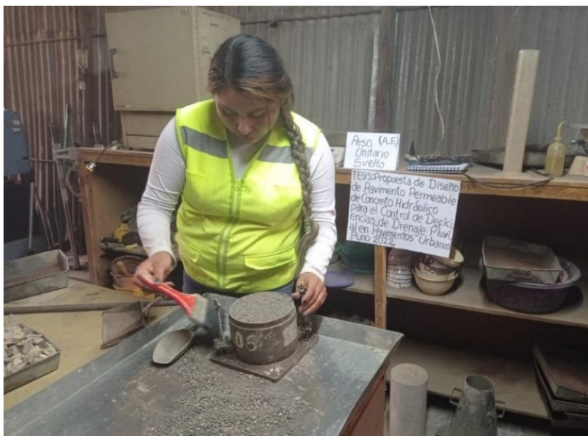
Figura 21. Preparación de molde + muestra de AF.
