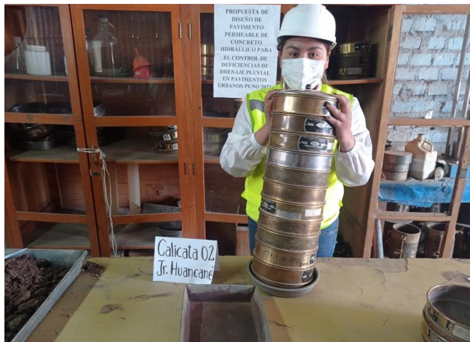
Figura 69. Tamizaje de la muestra para conocer la granulometría y clasificación de la C-2
