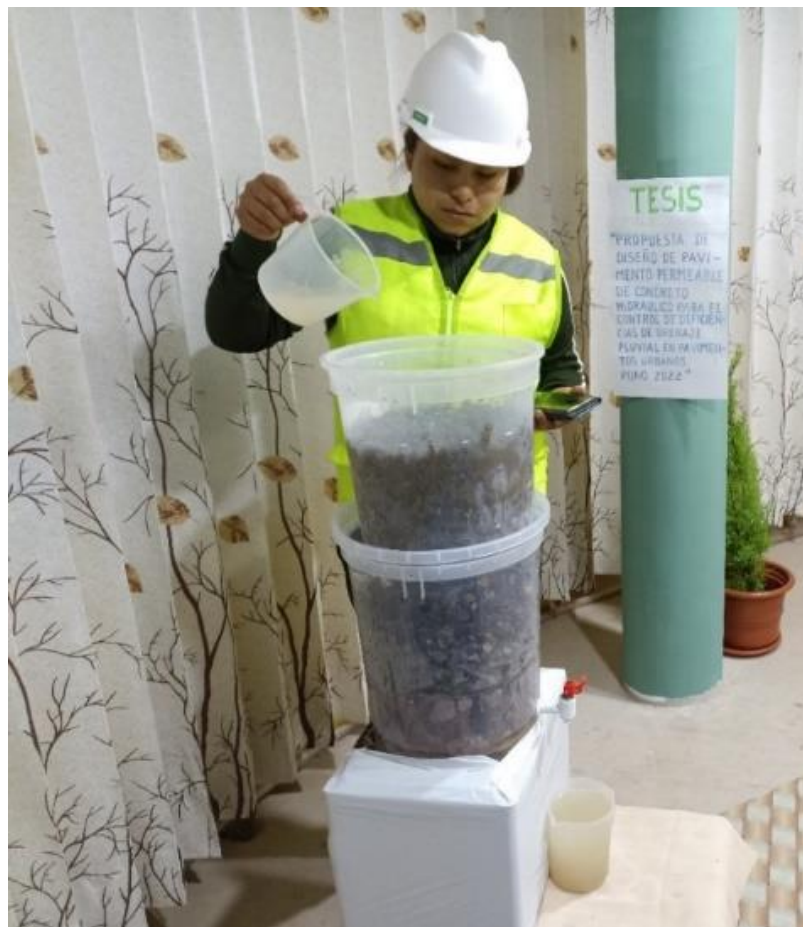
Figura 50. Prueba de carga constante de agua durante 2 horas
