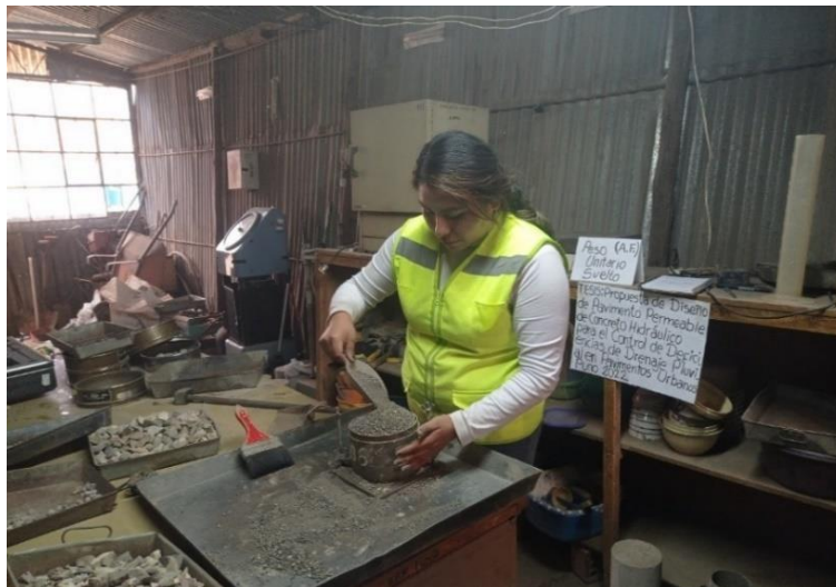
Figura 23. Conformación de la última capa de agregado fino en el molde
