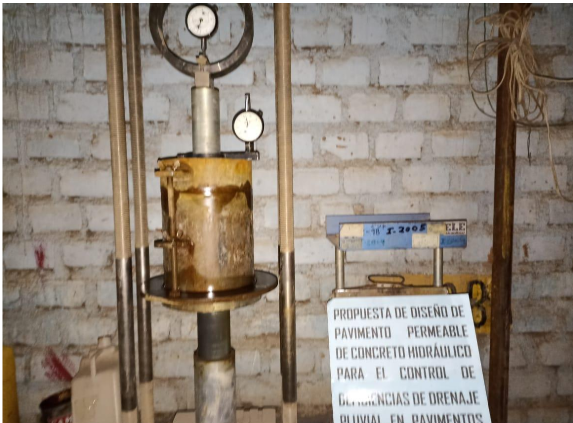
Lectura del molde con el equipo CBR.
