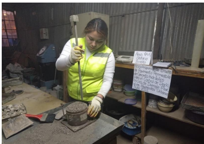
Figura 22. Varillado de la última capa de la muestra N° 1
