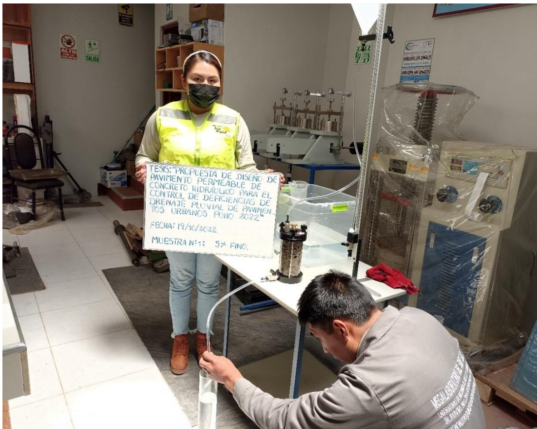
Prueba de permeabilidad con 5% de agregado fino
