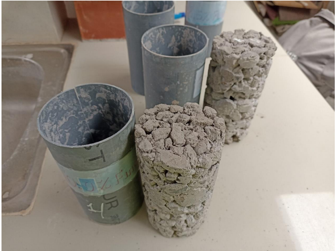
Desencofrado de muestras para la prueba de permeabilidad
