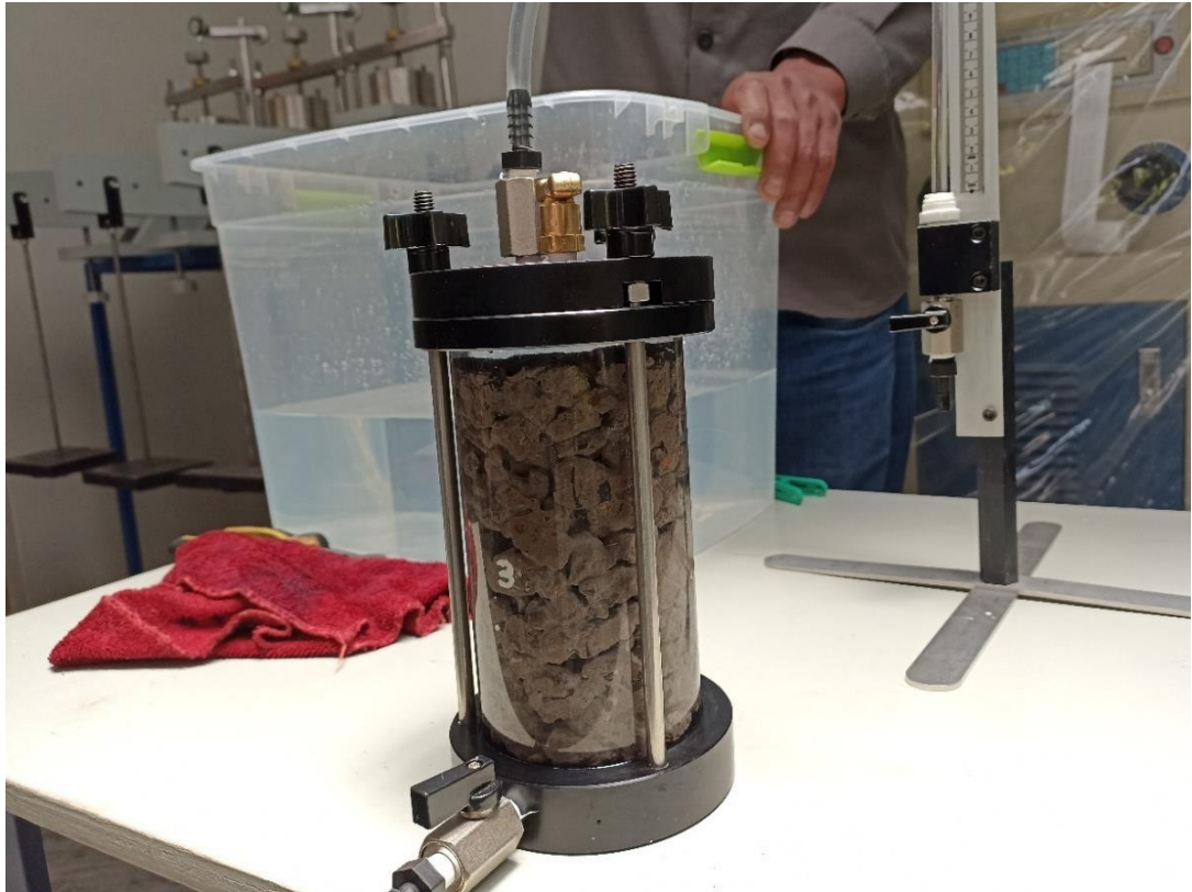
Prueba de permeabilidad con el equipo denominado permeámetro
