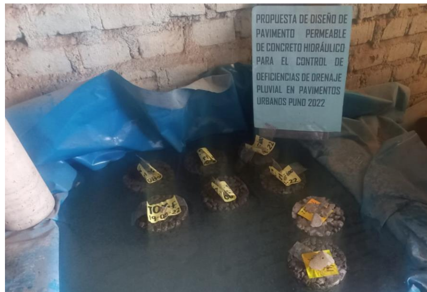
Figura 36. Curado de testigos permeables
