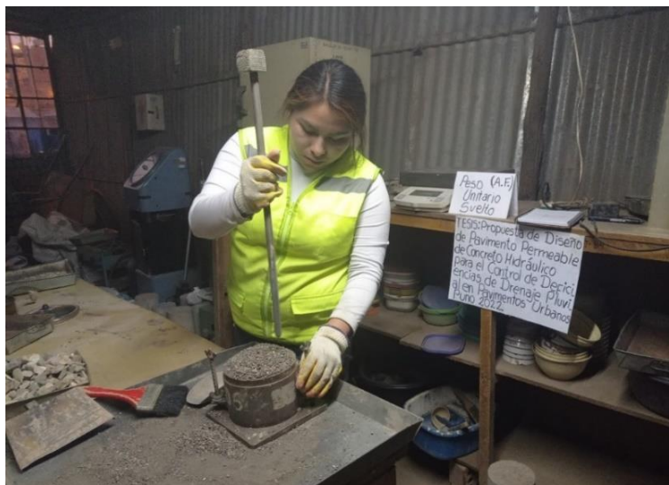
Figura 24. Proceso de compactación del agregado fino
