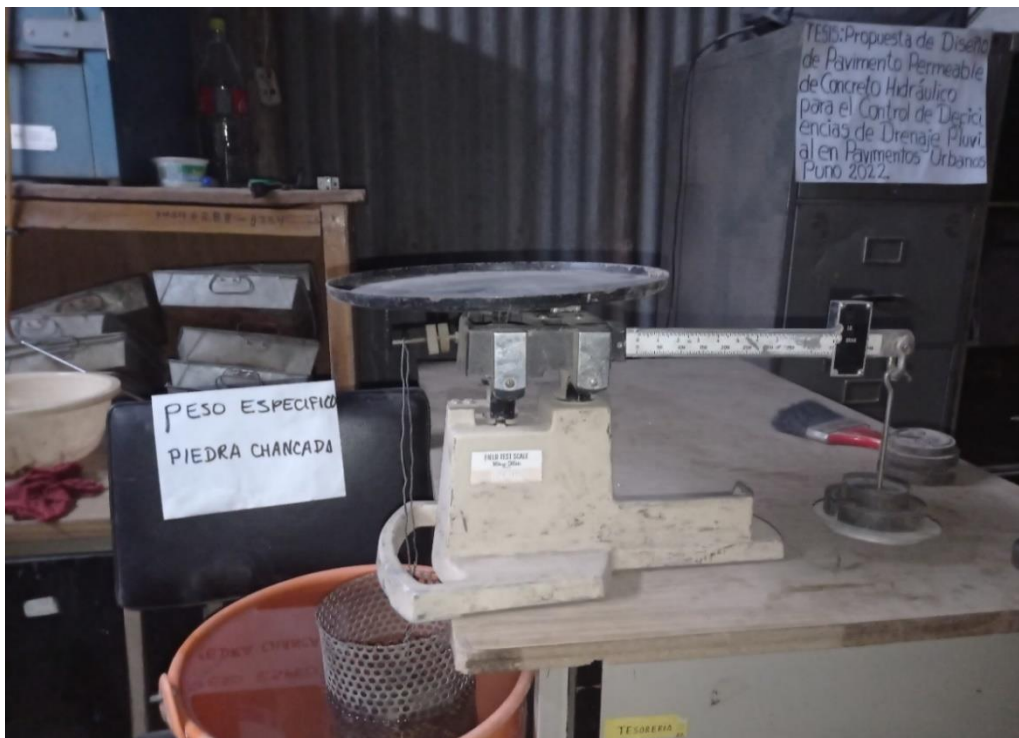
Prueba de peso específico del agregado grueso
