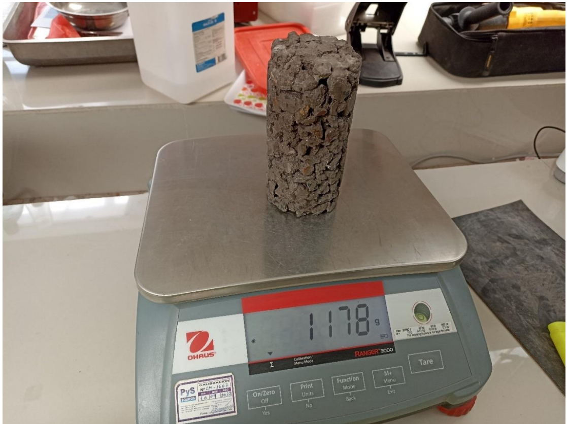
Pesado de la muestra saturada con 2.5% de agregado fino
