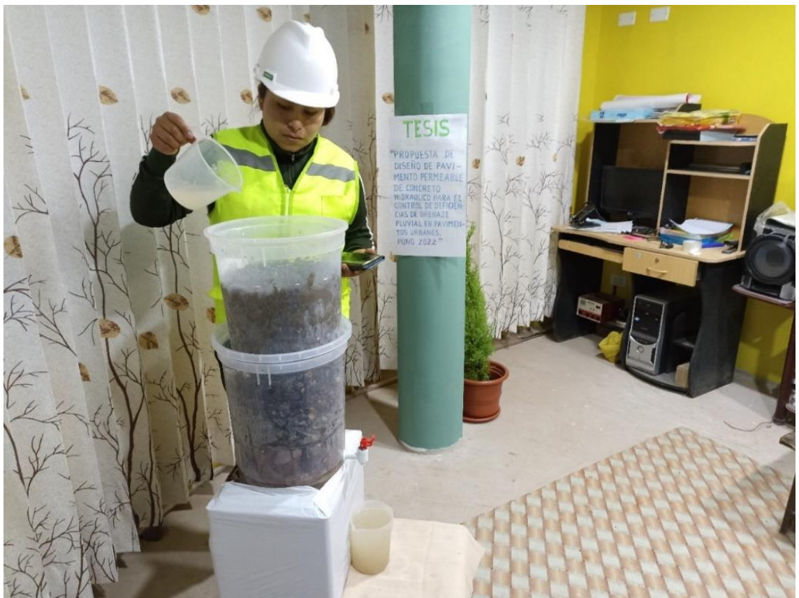
Prueba de influencia del geotextil no tejido en el prototipo elaborado.
