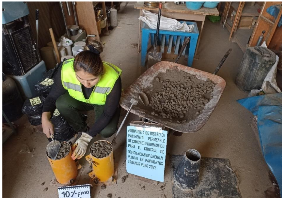
Figura 34. Enrasado de muestra en el molde
