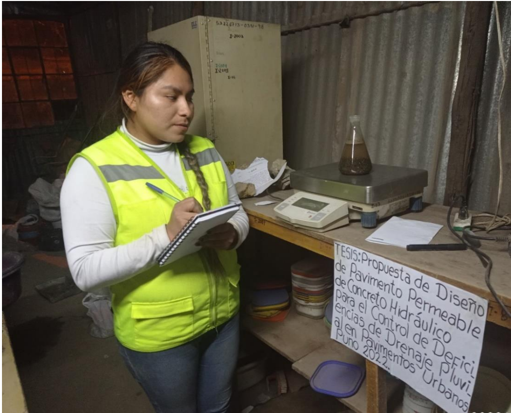
Pesado de matraz mas muestra completamente saturada
