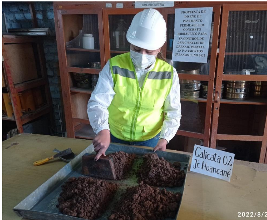
Figura 52. Método de cuarteo en de la C-2
