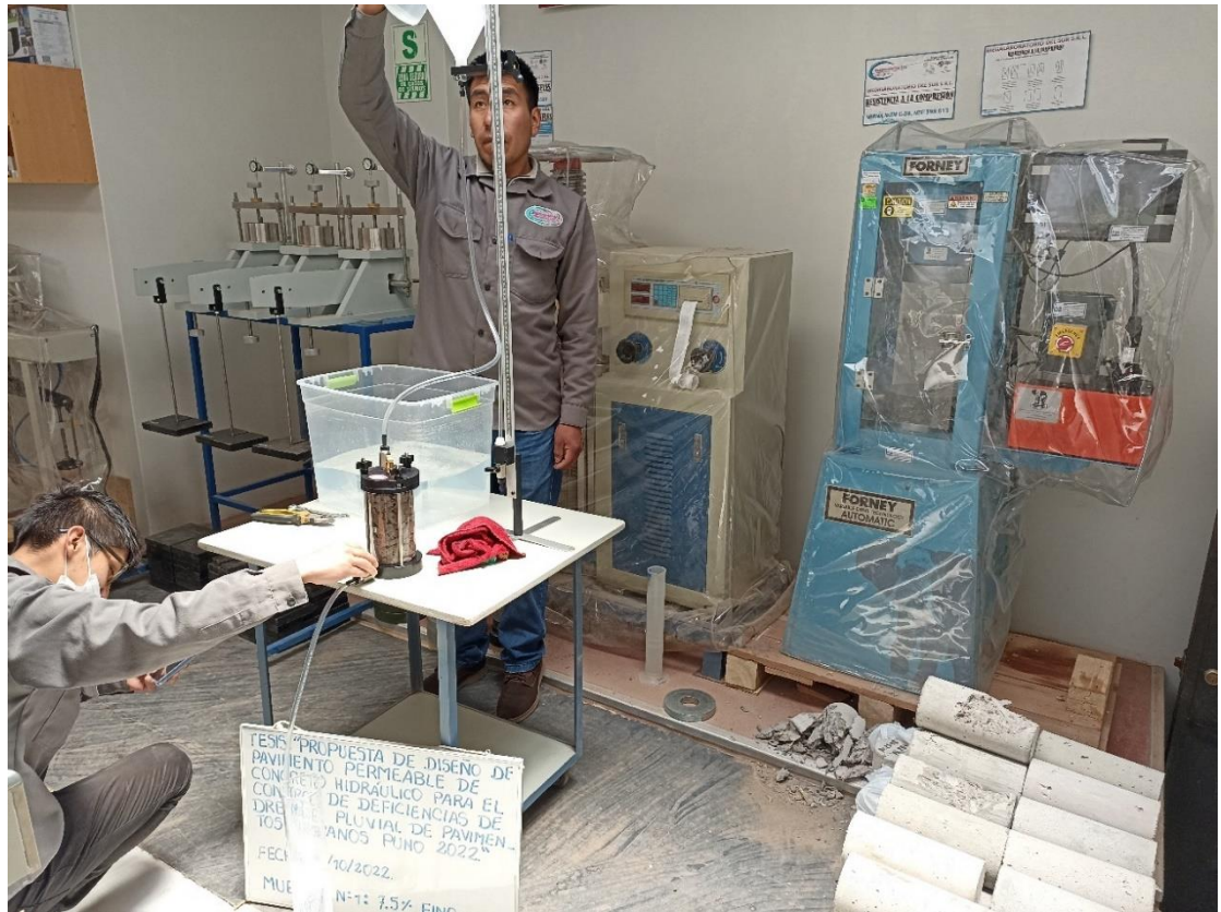
Prueba de permeabilidad con carga constante de agua
