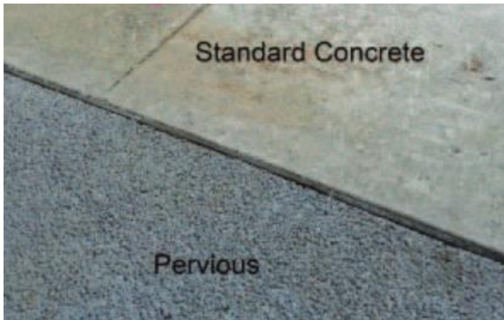
Figura 6. Comparación de hormigón estándar y penetrable
