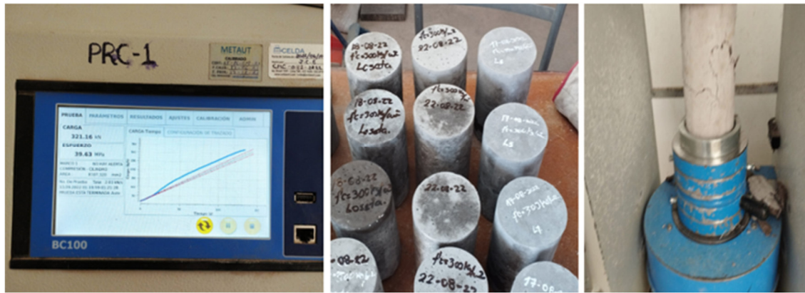
Figura 41. Preparación y ensayo Especímenes cilíndricos (ASTM D4832).
