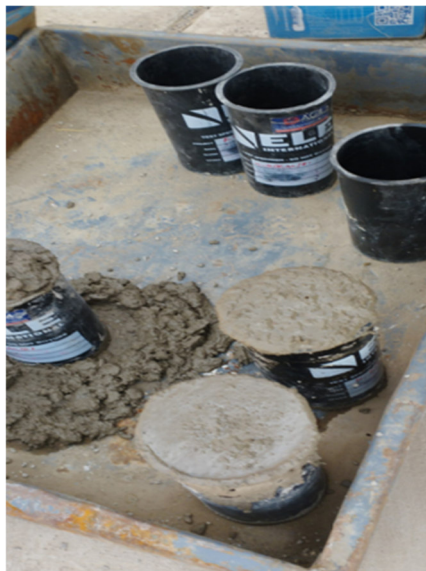
Figura 40. Prueba a compresión de cilindros de relleno fluido de resistencia controlada (ASTM C 39 / C 39M) Fuente Elaboración propia.
