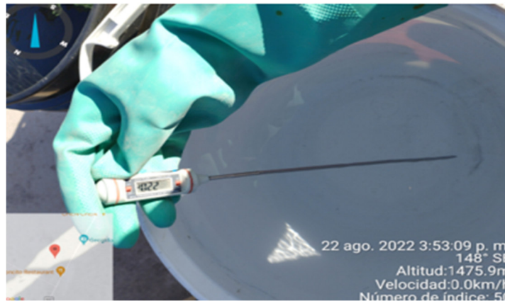
Figura 36. Verificación de temperatura del agua.
