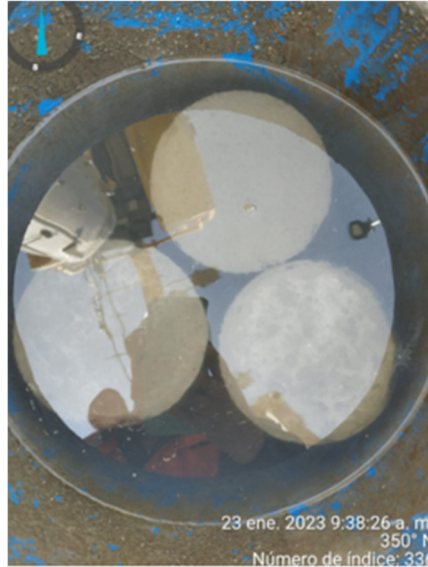
Figura 52. Toma de muestras de la mezcla cementicia, sellado hidráulico. Fuente: Elaboración propia
