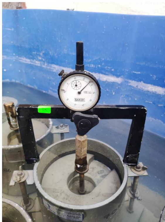
Fotografía 18. Vista y control del hinchamiento o volumen de esponjamiento de las muestras de suelo estudiadas.
