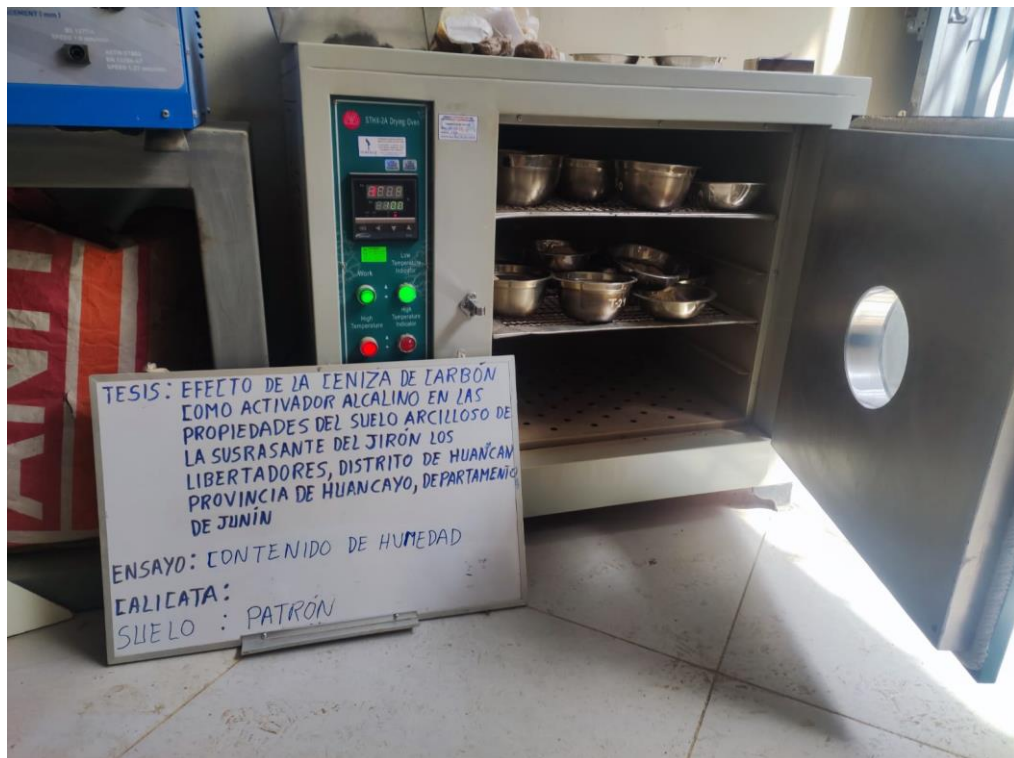
Fotografía 3. Vista de las muestras de suelo en el horno respectivo para estimar el contenido de humedad de la muestra patrón.
