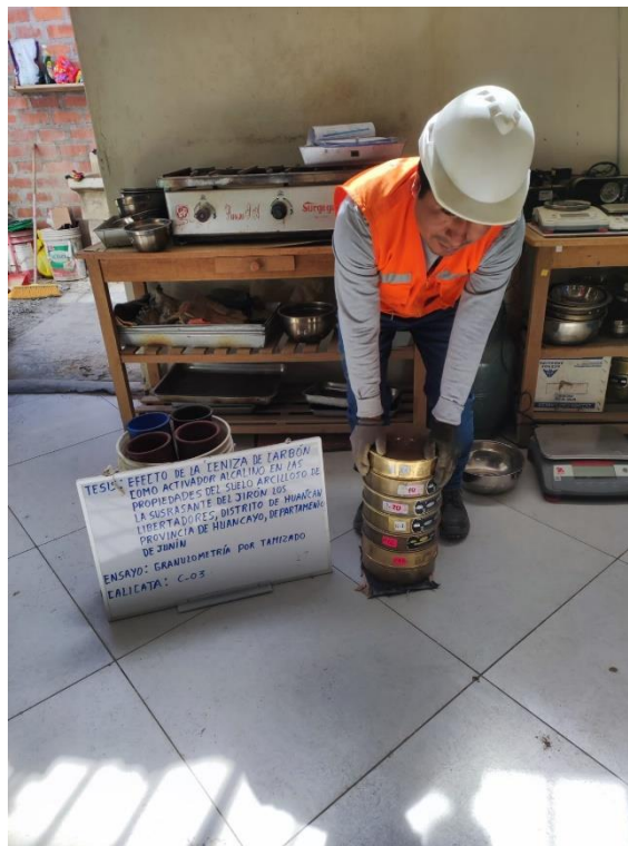
Fotografía 10. Procesamiento del tamizaje del material utilizado en el desarrollo de la investigación.
