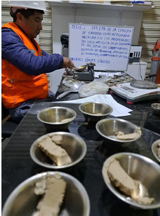
Fotografía 11. Vista del procedimiento para la determinación del límite líquido de las muestras de suelos.
