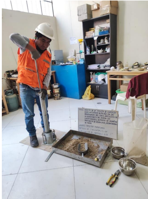
Fotografía 15. Ejecución del ensayo Proctor de la muestra patrón, respetando las normativas establecidas.
