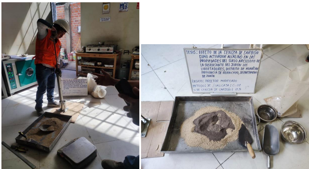
Figura 23. Vista de la ejecución del ensayo de Proctor modificado y de los equipos necesarios.
