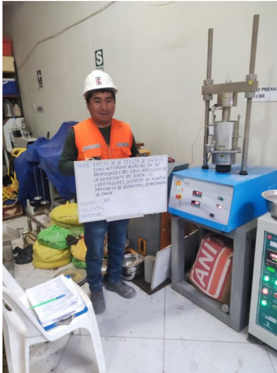
Fotografía 19. Vista del procedimiento de estimación del valor de CBR del suelo patrón.
