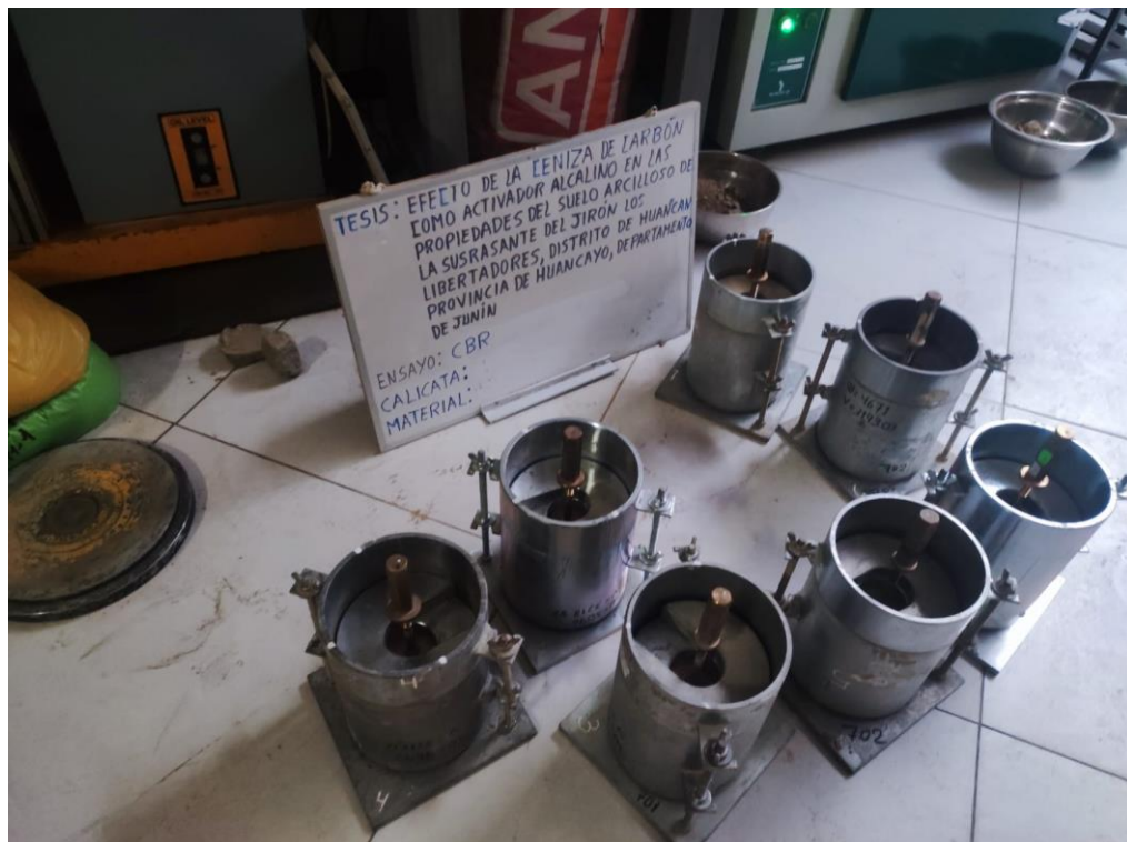
Fotografía 16. Vista de los moldes obtenidos después del ensayo Proctor, los cuales posteriormente serán sumergidos.
