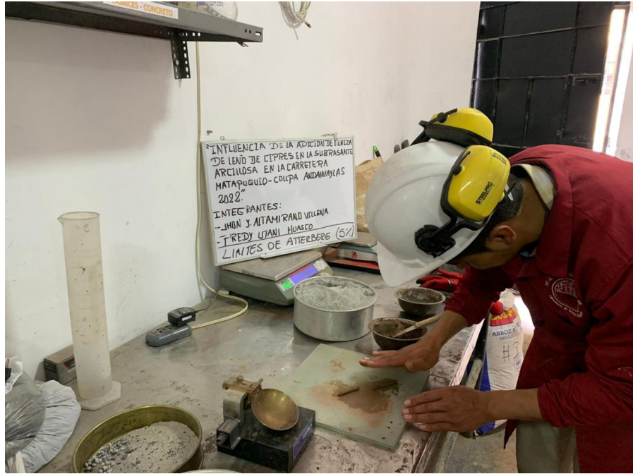
Figura 7. Hilo de suelo arcilloso – límite líquido
