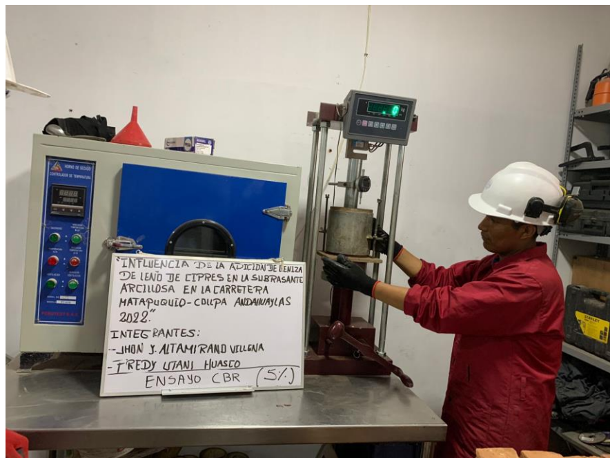
Figura 9. Ensayo de CBR 1
