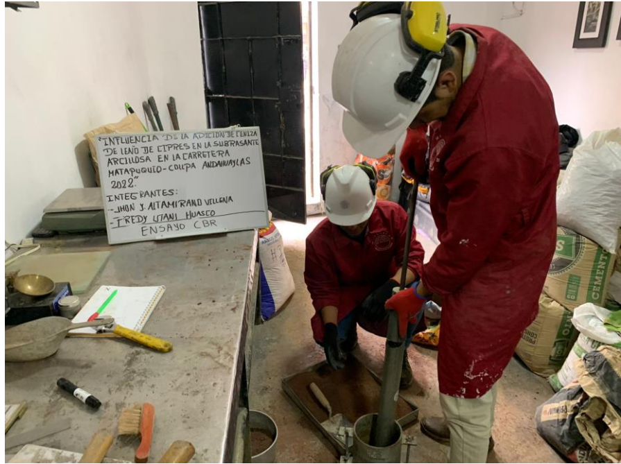
Figura 8. Preparación de material para ensayo de CBR
