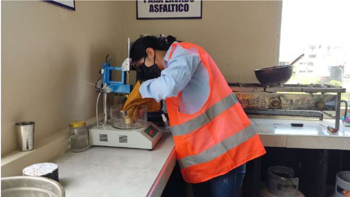
Anexo 21: Colocado de la muestra para en ensayo de penetración
