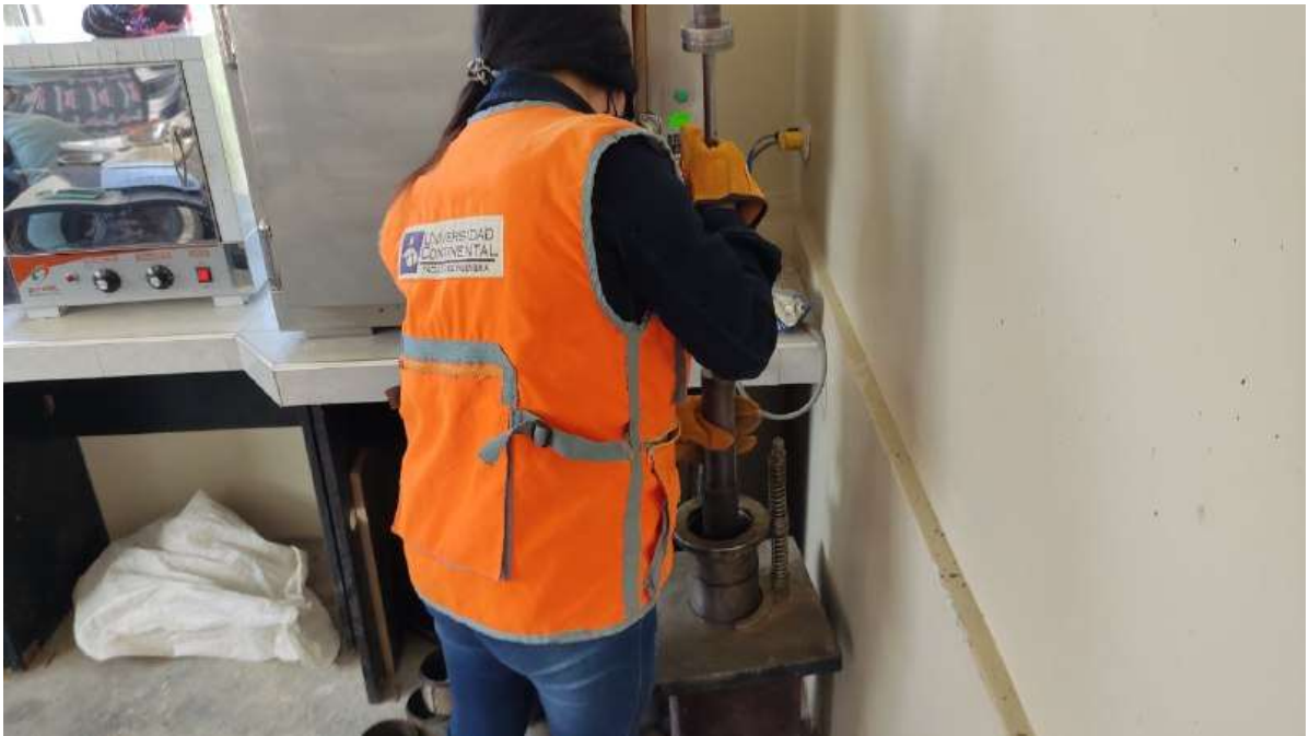
Anexo 38: Compactación de la mezcla 75 golpes por cara
