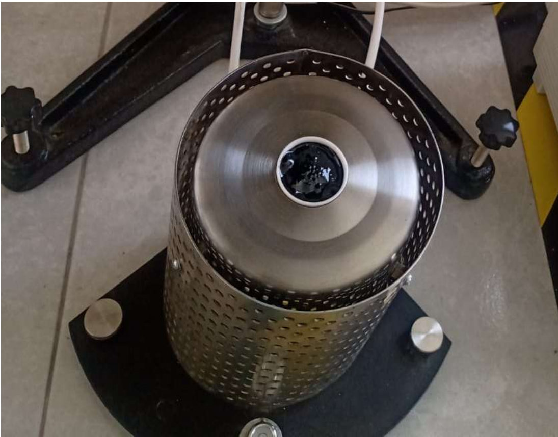
Anexo 17: fenómeno de ebullición del ligante asfáltico modificado con guinda pulverizada
