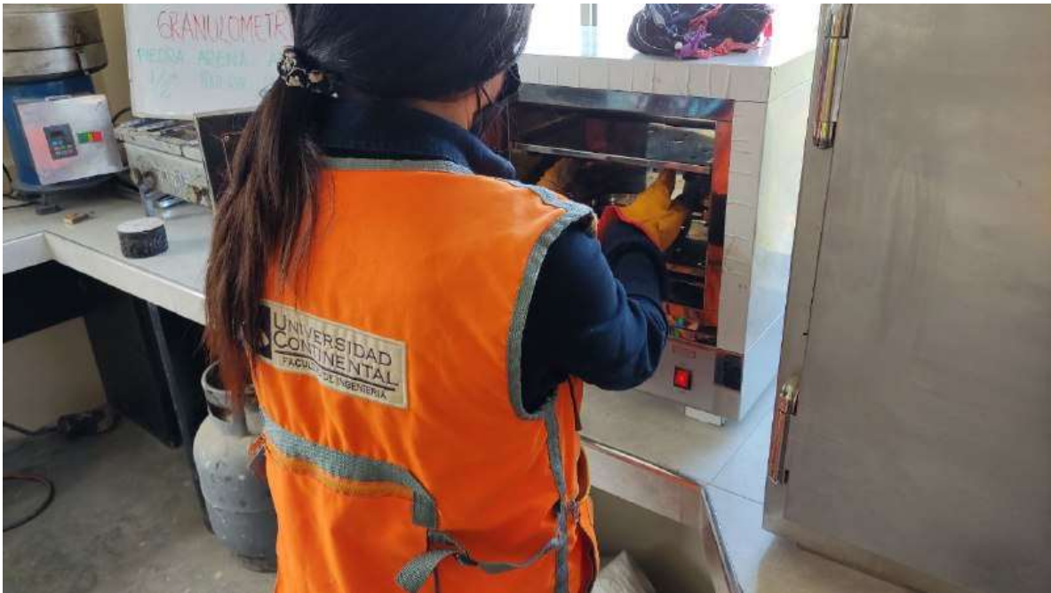
Anexo 28: Acondicionamiento del asfalto PEN 85-100 a una temperatura 150 y 160°C
