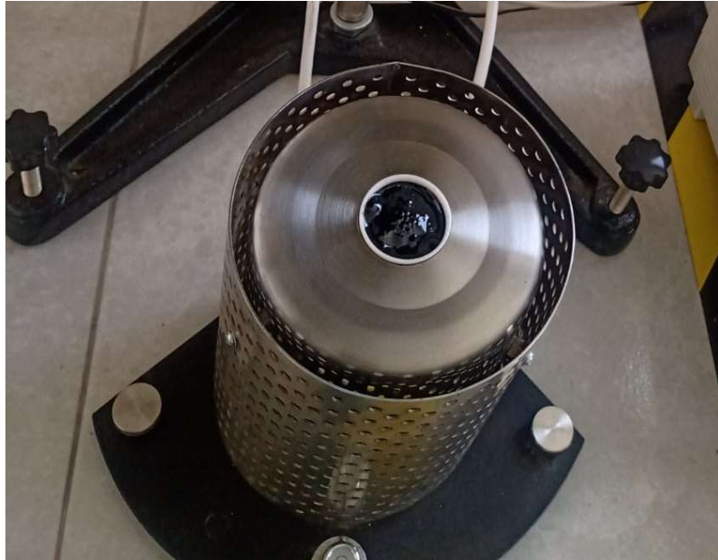
Figura 18: Cemento asfáltico PEN 85-100 modificado con guinda en proceso de ebullición
