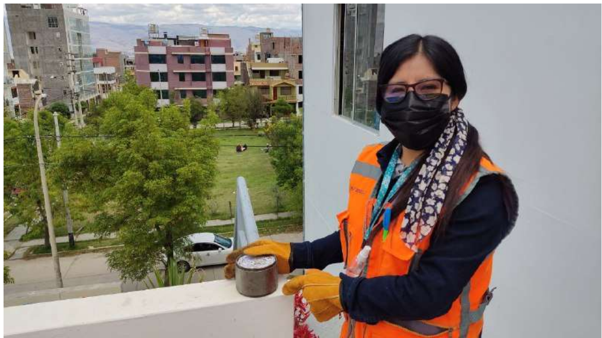
Anexo 40: Colocado de la muestra compactada a temperatura ambiente para su enfriamiento
