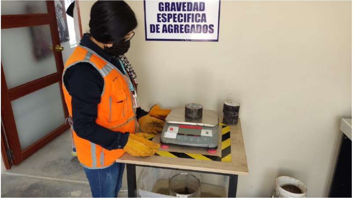
Anexo 43: Peso en seco de briqueta para el cálculo del porcentaje de vacíos
