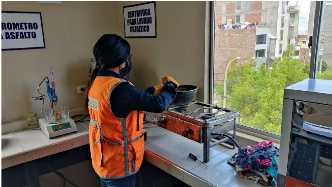
Anexo 31: Acondicionamiento a temperatura para la mezcla de agregado y asfalto
