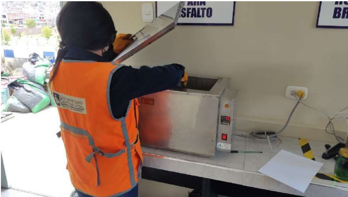
Anexo 46: Acondicionamiento de las muestras en baño maría a 60°C por 30 min para el ensayo con la prensa Marshall
