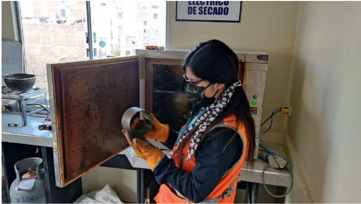
Anexo 29: Acondicionamiento de los accesorios (molde base y cabezal) para la compactación de briqueta
