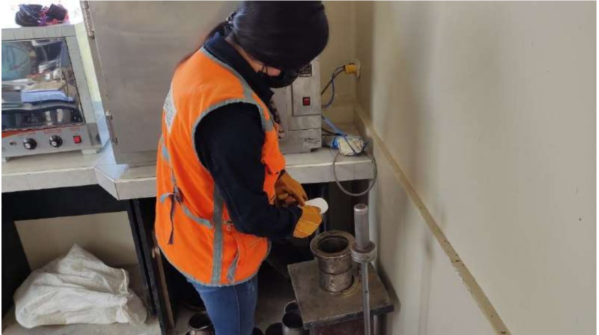
Anexo 37: colocado del papel filtro sobre la mezcla asfáltica para la compactación
