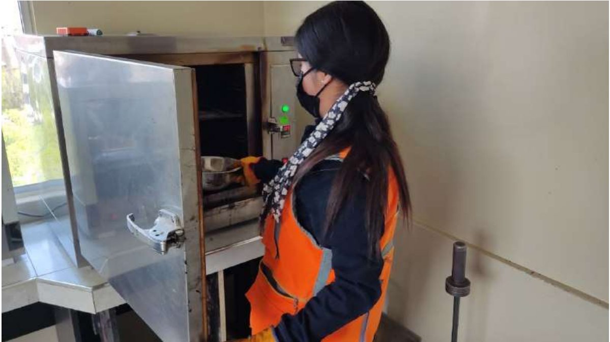
Anexo 27: Acondicionamiento de la mezcla de agregados a una temperatura 150 y 160°C
