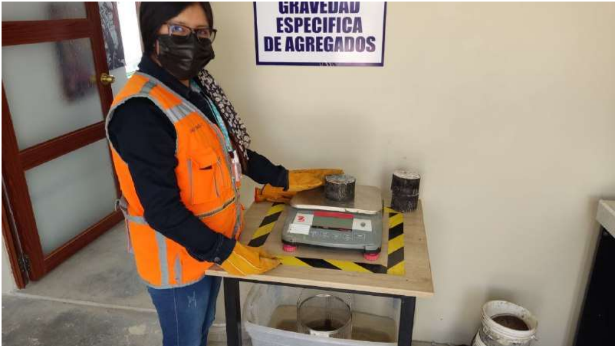
Anexo 45: Peso en parcialmente seco de briqueta para el cálculo del porcentaje de vacíos
