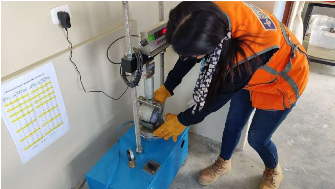
Anexo 48: Colocado de briqueta para el ensayo de Marshall
