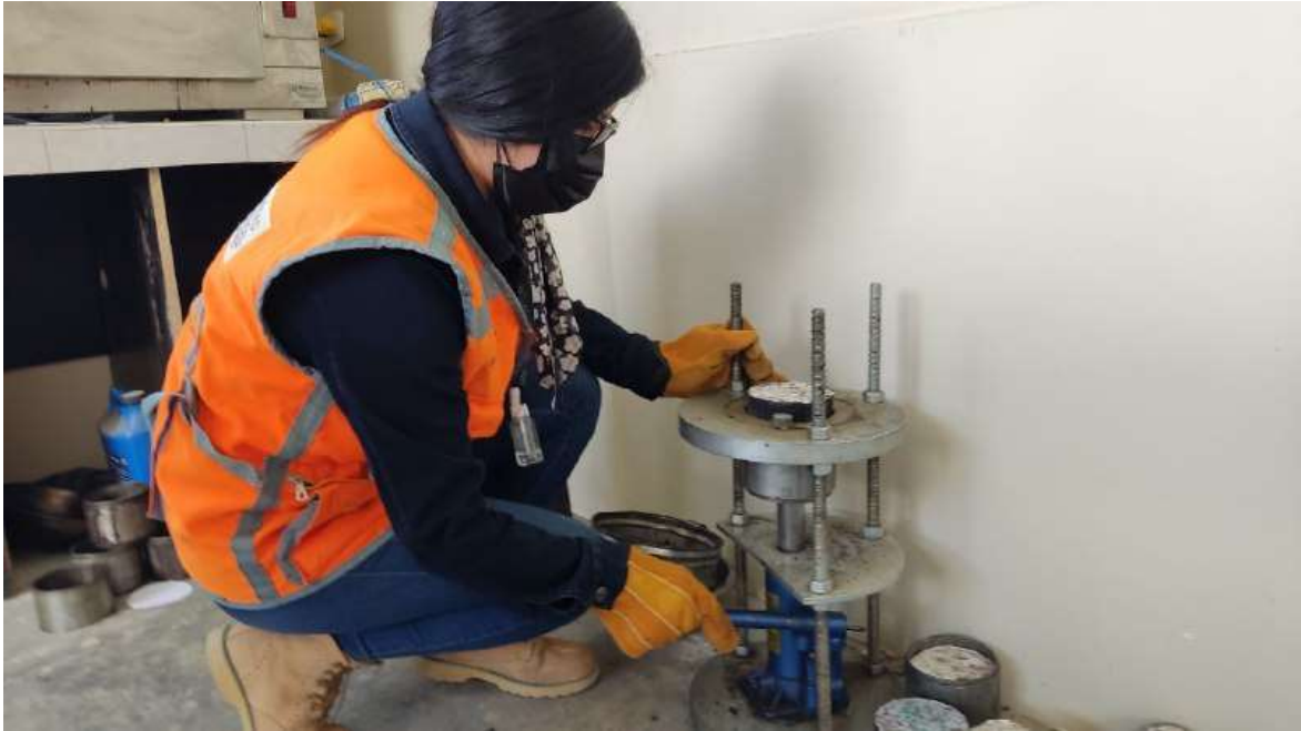
Anexo 41: desencofrado de la muestra
