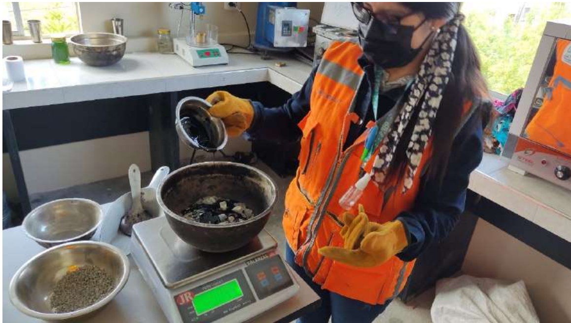
Anexo 30: pesado del ligante asfáltico a una temperatura de 160°C sobre el agregado acondicionado para la mezcla asfáltica.
