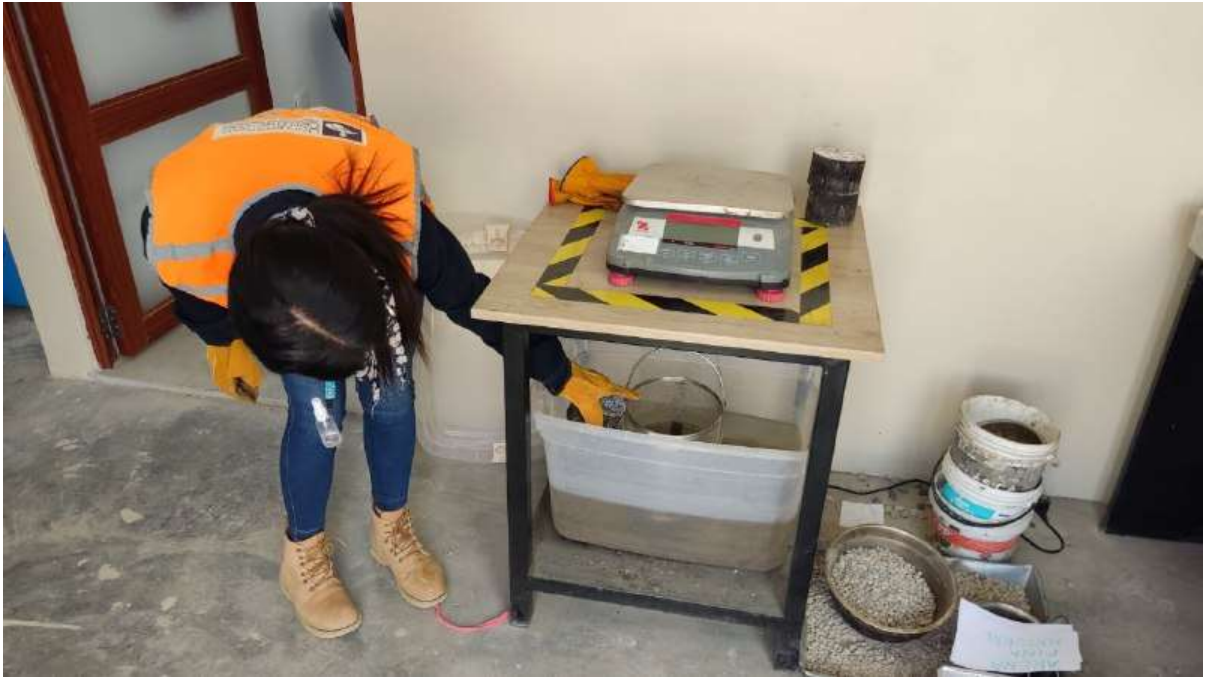
Anexo 44: Peso en sumergido de briqueta para el cálculo del porcentaje de vacíos
