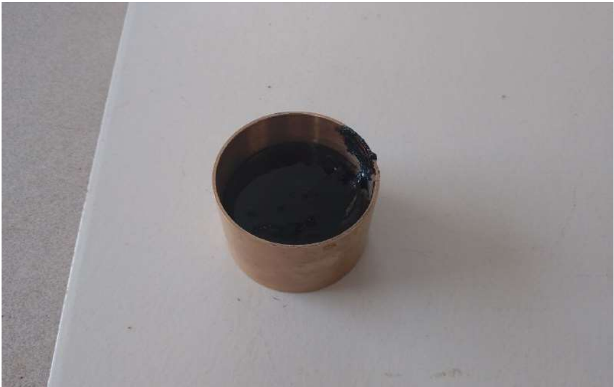
Anexo 20: Muestra lista en el recipiente para el ensayo de penetración.
