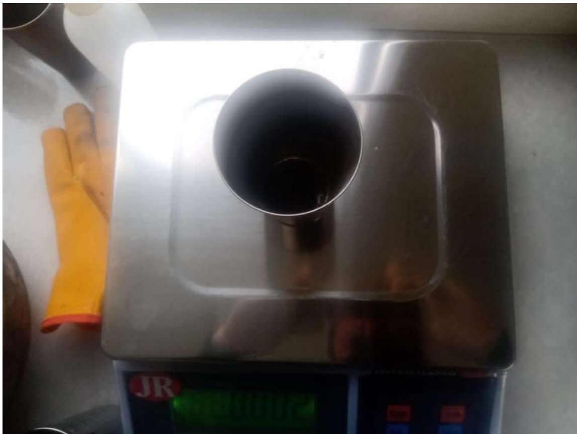
Anexo 7: Acondicionamiento del asfalto para los ensayos de viscosidad
