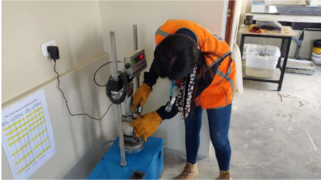
Anexo 49: colocado del dial a la prensa de Marshall
