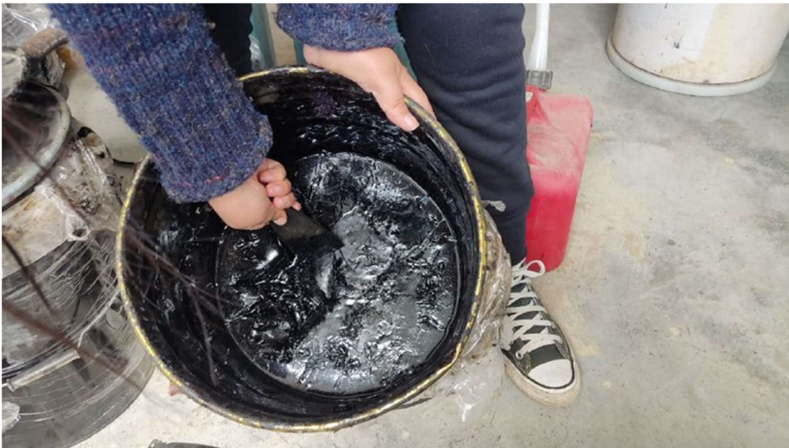
Anexo 18: extracción del ligante asfáltico para los ensayos de penetración
