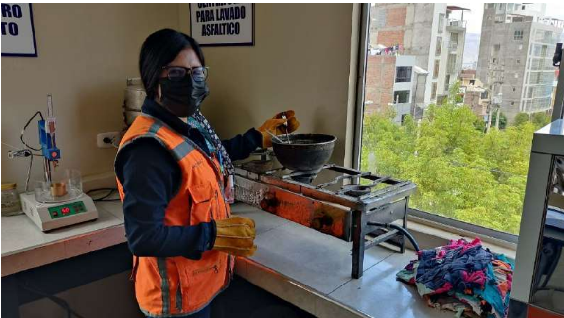
Anexo 32: toma de la temperatura de la mezcla asfáltica para mantenerlo a 160 °C
