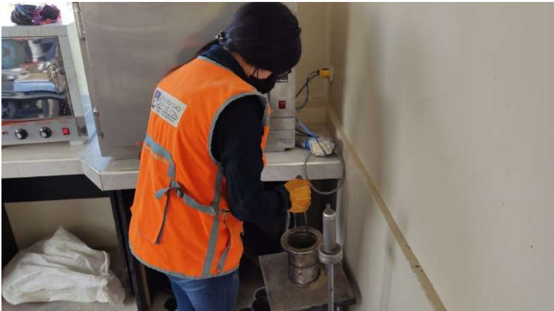
Anexo 36: Achurado de la mezcla asfáltica en caliente a 25 golpes (15 a los lados y 10 al centro)
