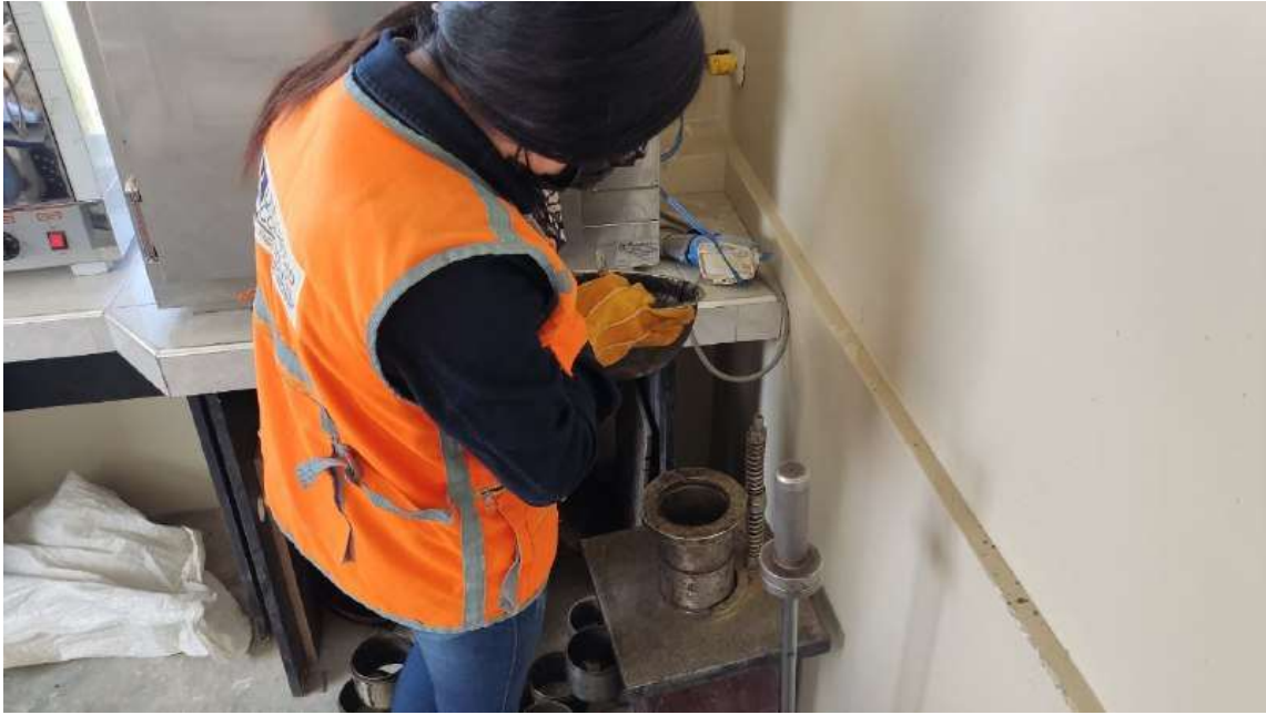
Anexo 35: Vertiendo la mezcla asfáltica al molde
