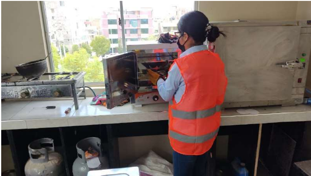
Anexo 7: Acondicionamiento del asfalto para los ensayos de viscosidad
