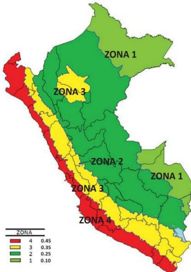
Figura 14. Zonas sísmicas. Tomada de RNE E-030.
