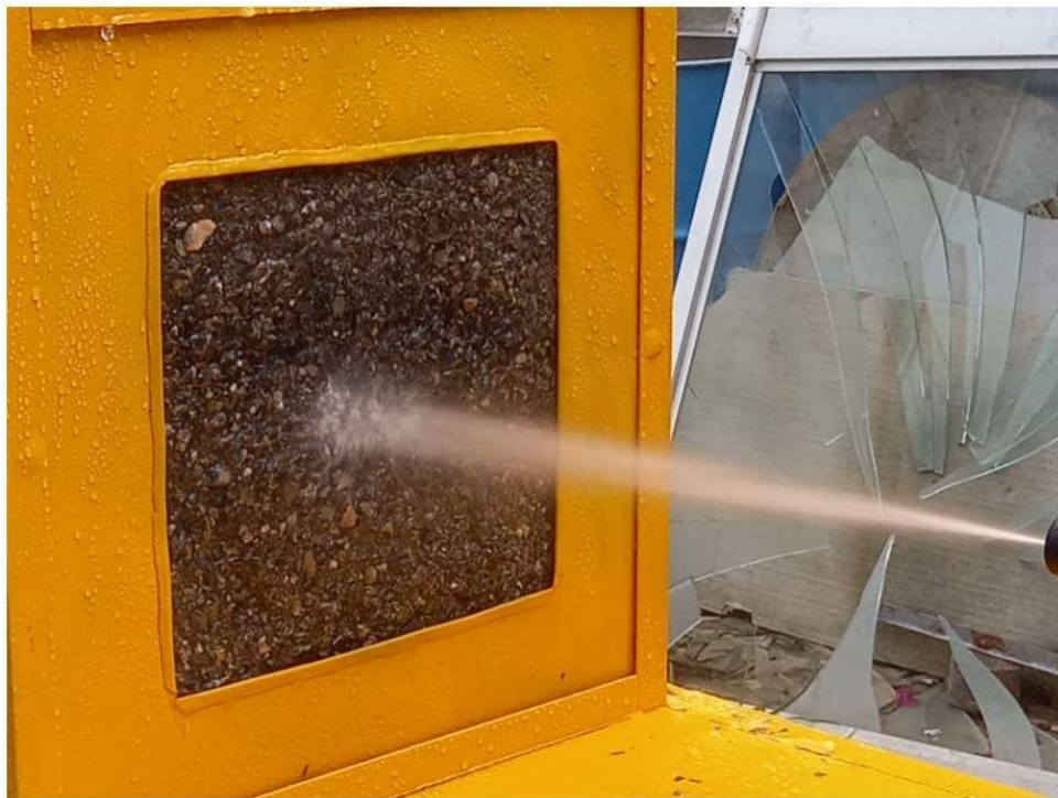
Ilustración 22 Ensayo de erosión acelerada de Geelong para la muestra con G5
