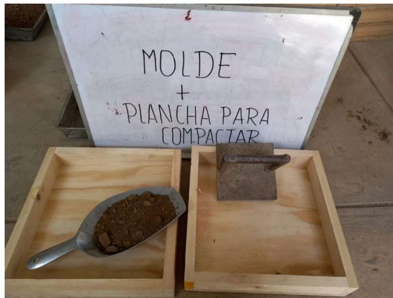
Ilustración 19 Molde y Plancha compactadora
