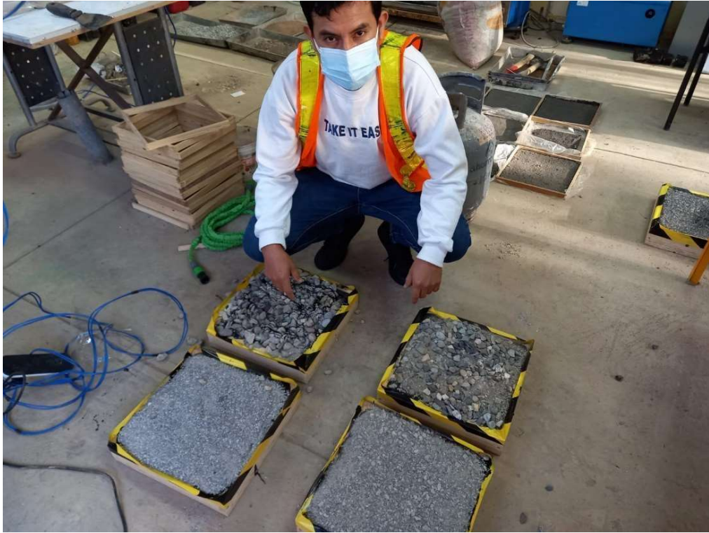
Ilustración 76 Tratamiento Superficial De Base Granular
