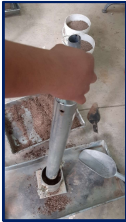
Compactación del material granular en el molde de 6''
