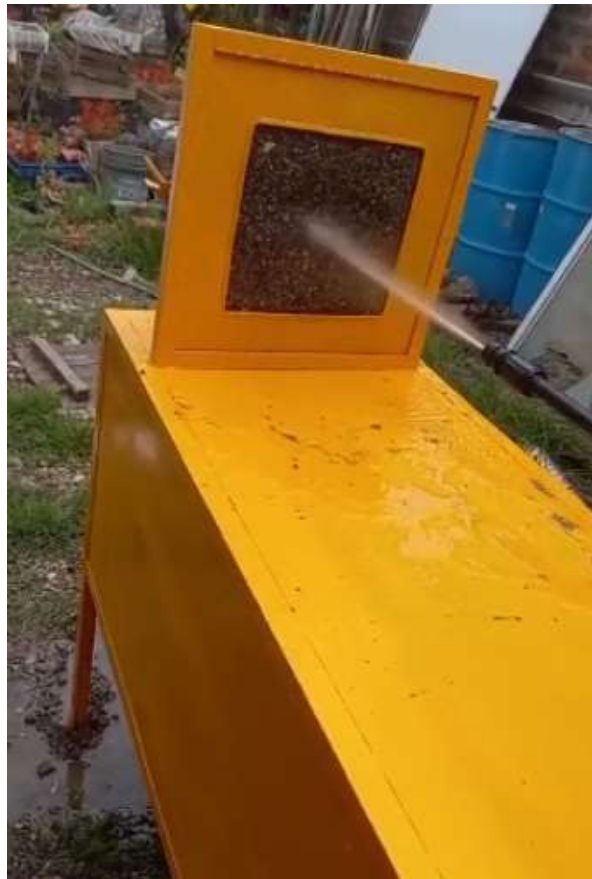
Ilustración 23 Ensayo de erosión acelerada de Geelong – chorros 15 min
