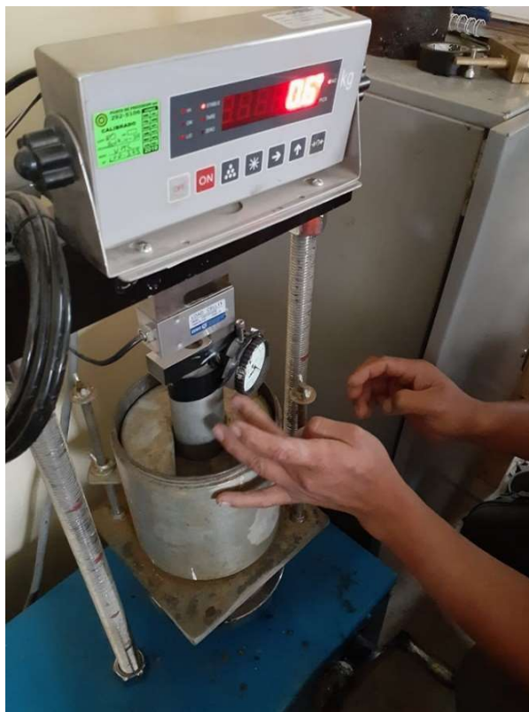
Ensayo de penetración
