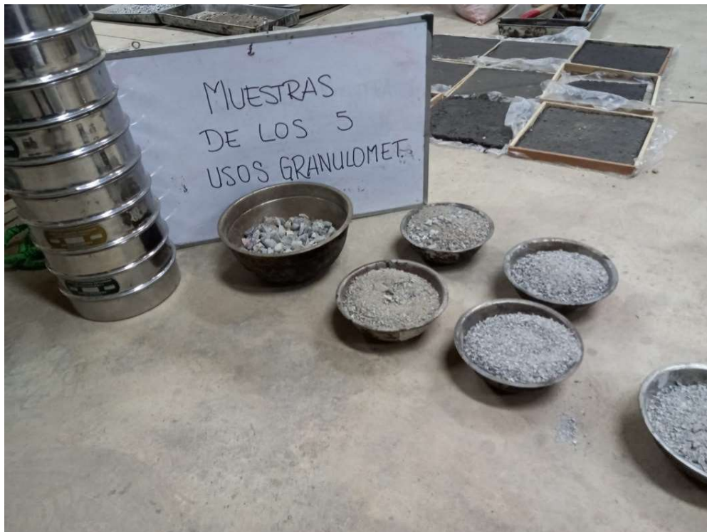
Ilustración 75 Usos granulométricos para el tratamiento superficial
