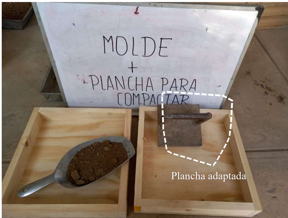
Ilustración 66 Molde y Plancha compactadora
