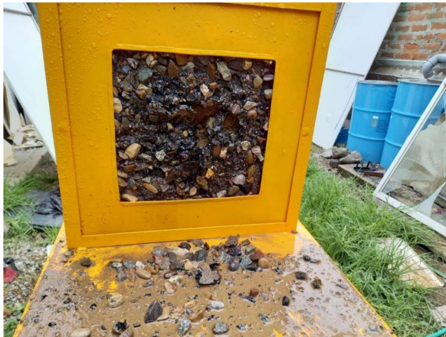
Ilustración 81 Daño por Erosión
