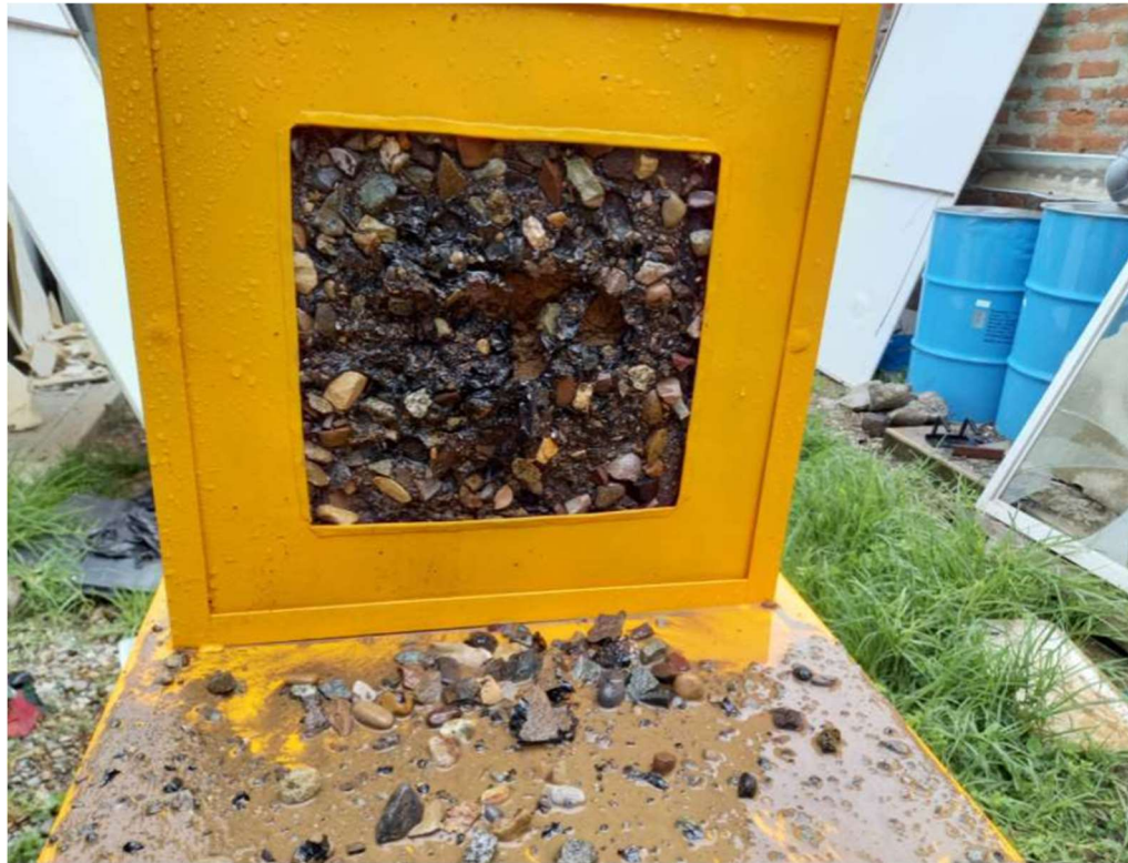
Ilustración 25 Muestra erosionada después del ensayo de Geelong
