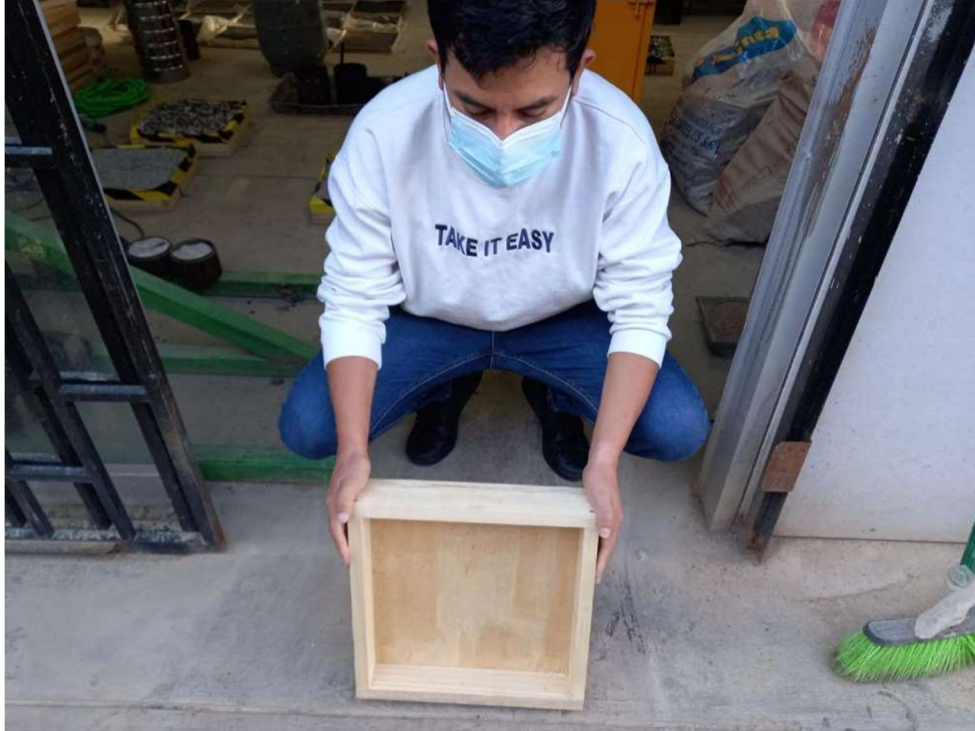
Ilustración 67 Molde de Compactación de 30cm x 30cm
