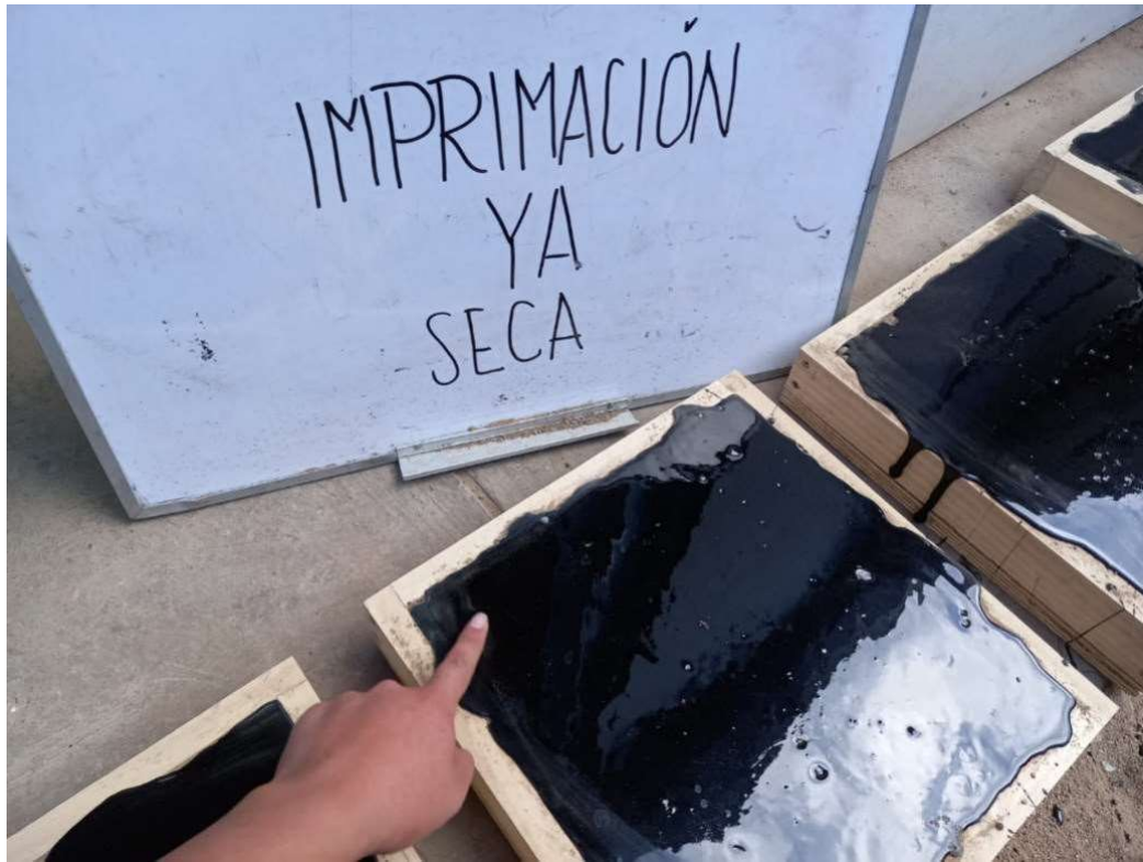
Ilustración 74 Imprimitación Seca a temperatura ambiente
