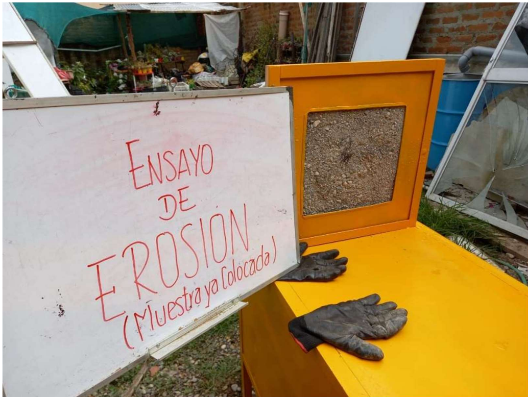
Ilustración 78 Muestra Colocada para el ensayo de Erosión por chorro
