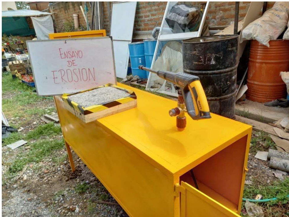
Ilustración 79 Equipo y Muestra Para el ensayo de daño por Erosión
