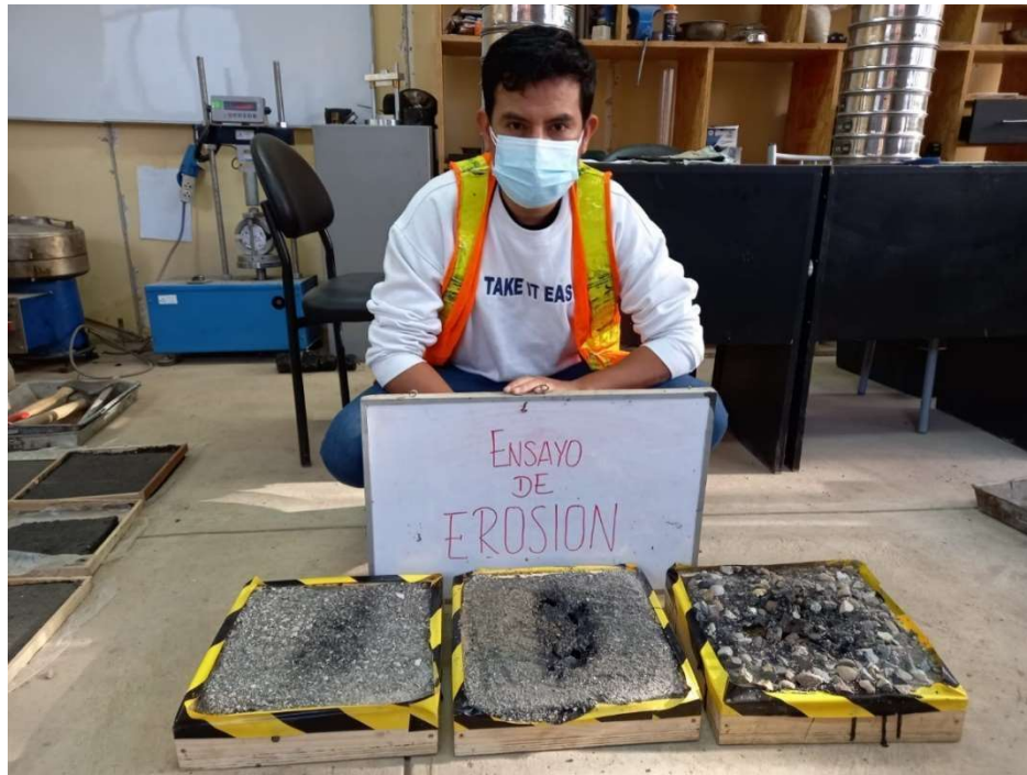
Ilustración 82 Severidad del daño de las muestras
