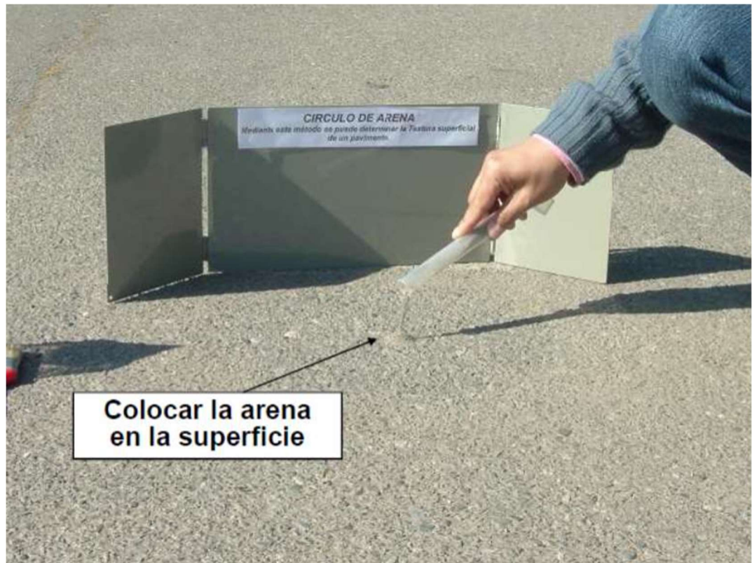
Ilustración 8 Vertido de la arena al pavimento
