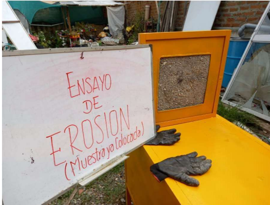
Ilustración 24 Ensayo de erosión acelerada de Geelong para la muestra con G6
