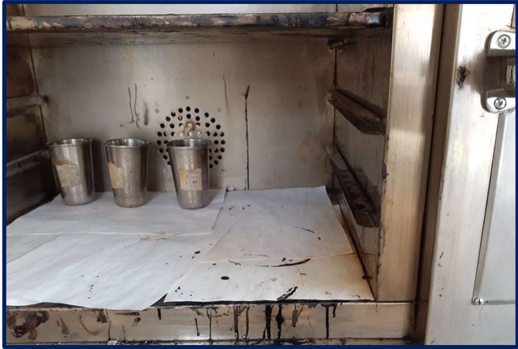
MUESTRA SACADA DEL MOLDE Y LLEVADA AL HORNO
