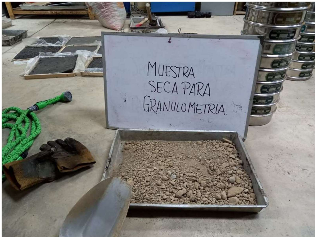
Ilustración 68 Muestra Seca para granulometría de la Base Granular
