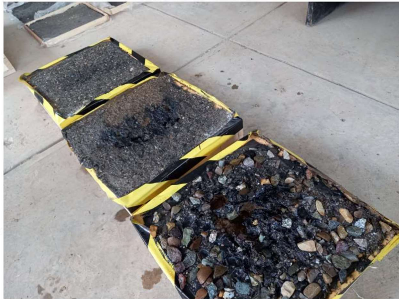
Ilustración 21 Moldes se 30cm x 30cm de tratamiento superficial
