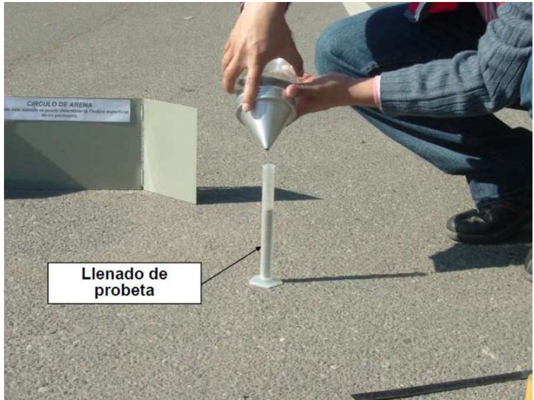
Ilustración 7 Medición de la cantidad arena para el ensayo
