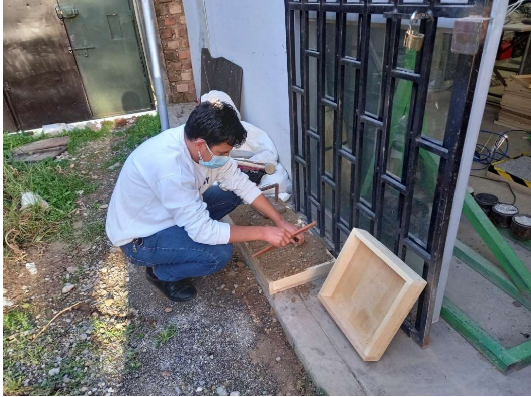
Ilustración 69 Base Granular en el Molde
