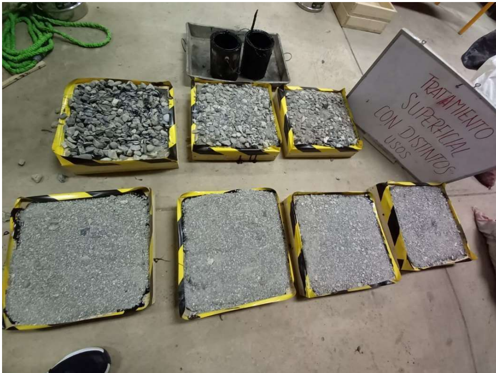
Ilustración 77 Tratamiento Superficial con distintos usos Granulométricos
