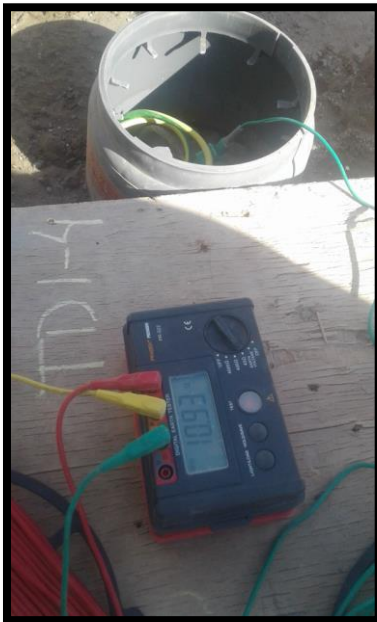
Imagen 216 Prueba de resistencia del pozo a tierra.
