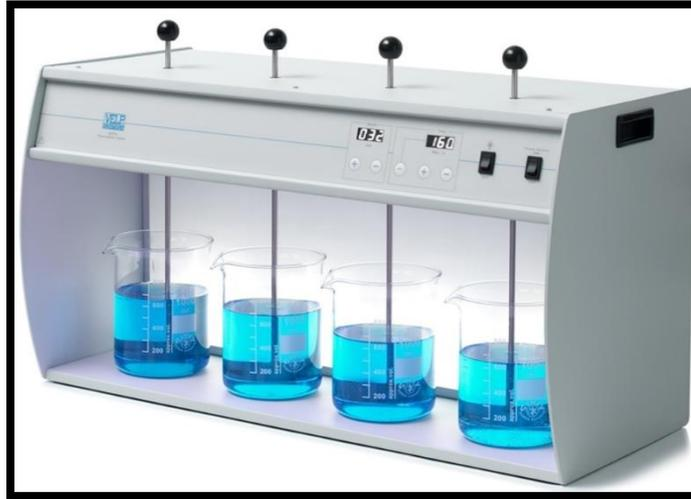
**Figura 1.** Imagen de un equipo para prueba de jarras
