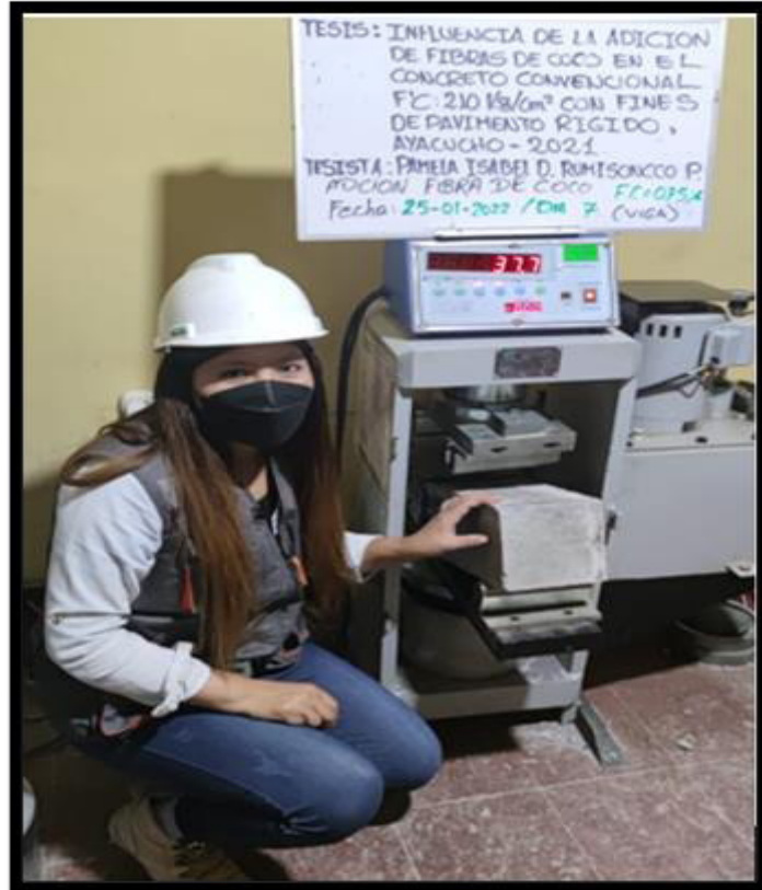
Fotografía 14. Ensayo a la flexión con carga en cada tercio según la ASTM C78.
