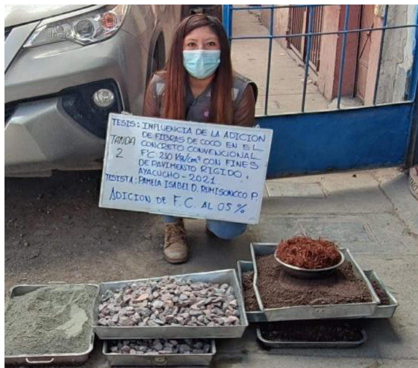
Fotografía 8. Pesaje de los materiales para la elaboración de concreto 210 kg/cm 2 con 0.50% de fibra de coco.
