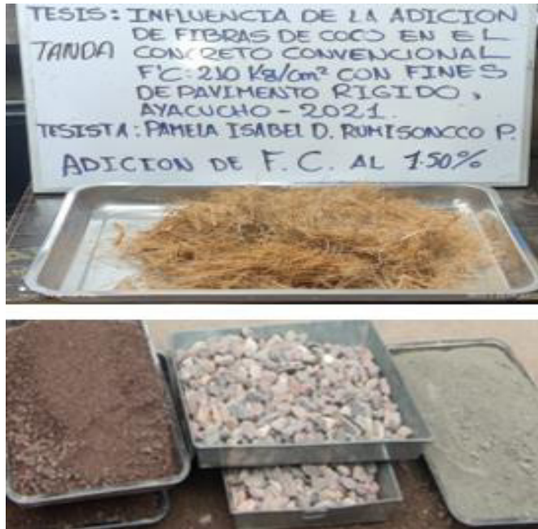
Fotografía 11. Pesaje de los materiales para la elaboración de concreto 210 kg/cm 2 con 1.50% de fibra de coco.
