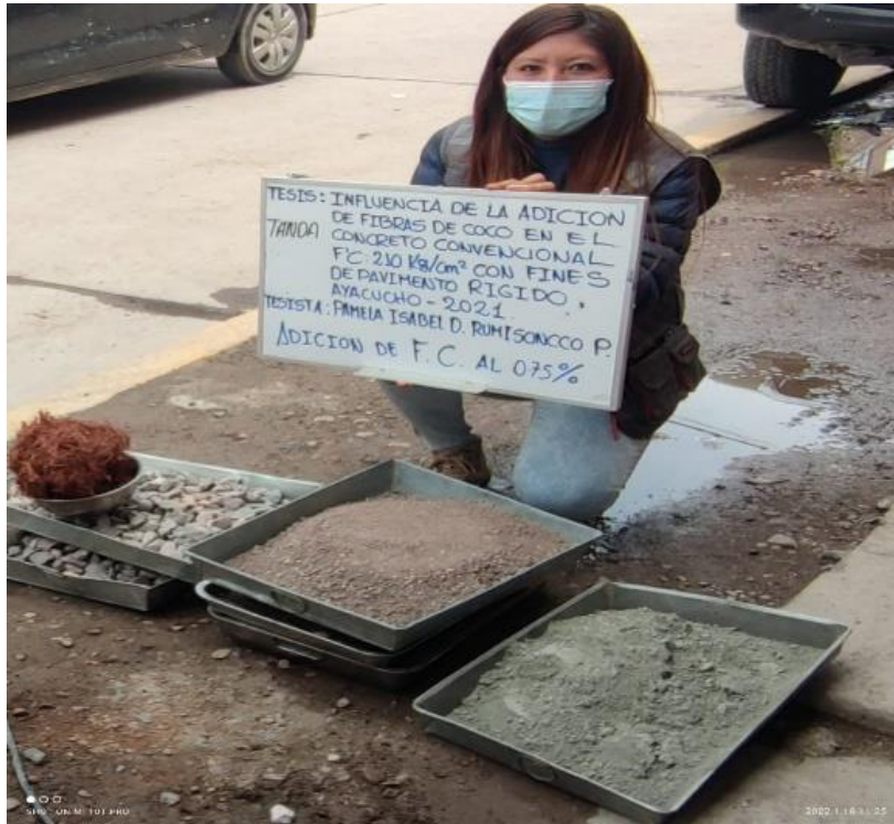
Fotografía 9. Pesaje de los materiales para la elaboración de concreto 210 kg/cm 2 con 0.75% de fibra de coco.
