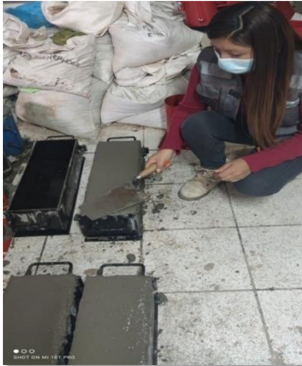
Fotografía 13. Colocación de la mezcla en especímenes prismáticos para el ensayo a flexión según la ASTM C78
