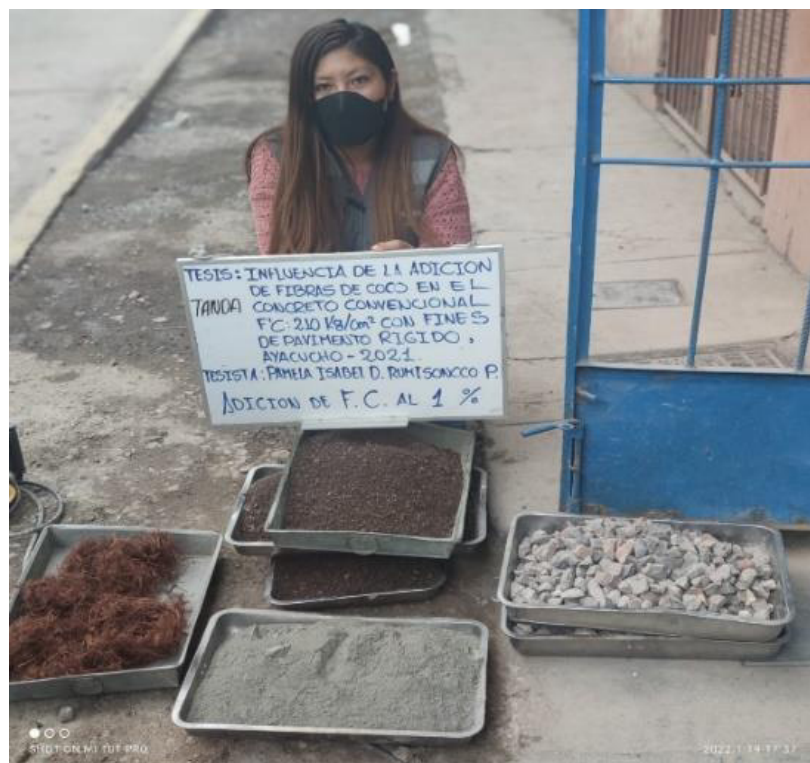
Fotografía 10. Pesaje de los materiales para la elaboración de concreto 210 kg/cm 2 con 1.00% de fibra de coco
