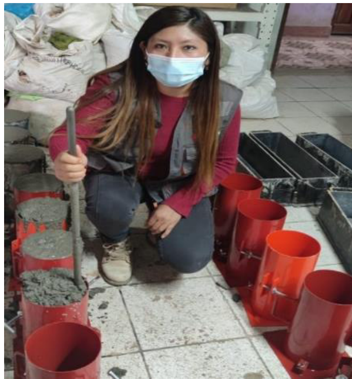
Fotografía 12. Colocación de la mezcla en probetas cilíndricas para el ensayo a compresión según la NTP 339.034.
