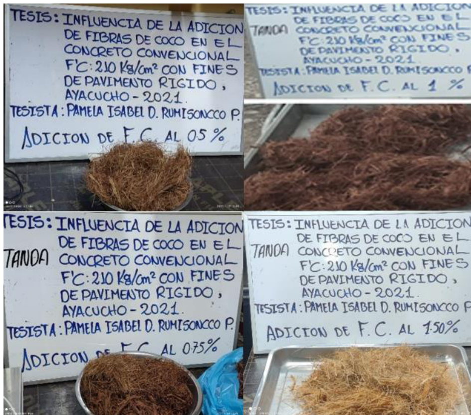
Fotografía 7. Pesaje de dosificación de 0.50%, 0.75%, 1%, 1.50% de fibra de coco.
