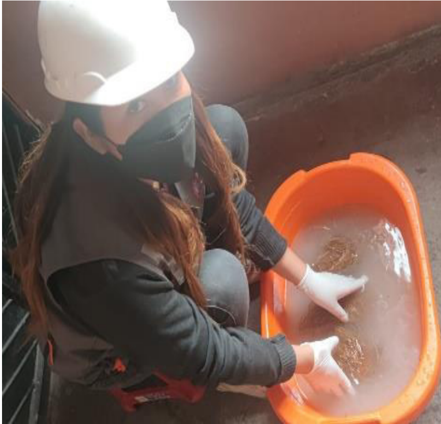
Fotografía 5. Tratamiento de las fibras de coco.
