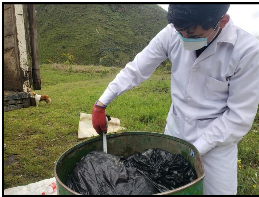
Fotografía 10 Medición de la altura libre del cilindro para determinar la densidad de residuos sólidos.
