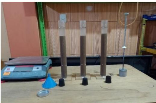
**Figura 47:** Ensayo equivalente de arena.
