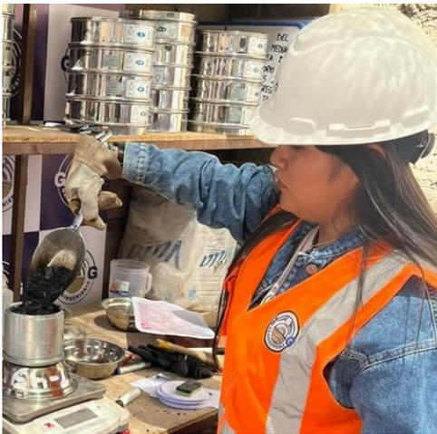
**Figura 60:** Colocación de Mezcla en probeta
