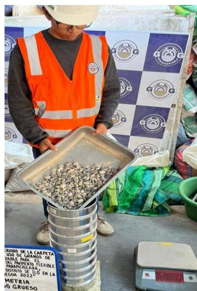
**Figura 54:** Tamizado agregado grueso.
