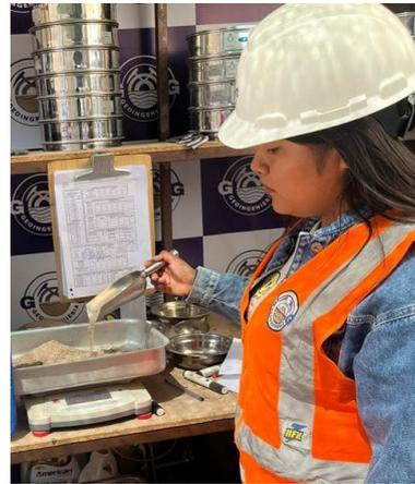
**Figura 57:** Dosificación del agregado para diseño de Mezcla.
