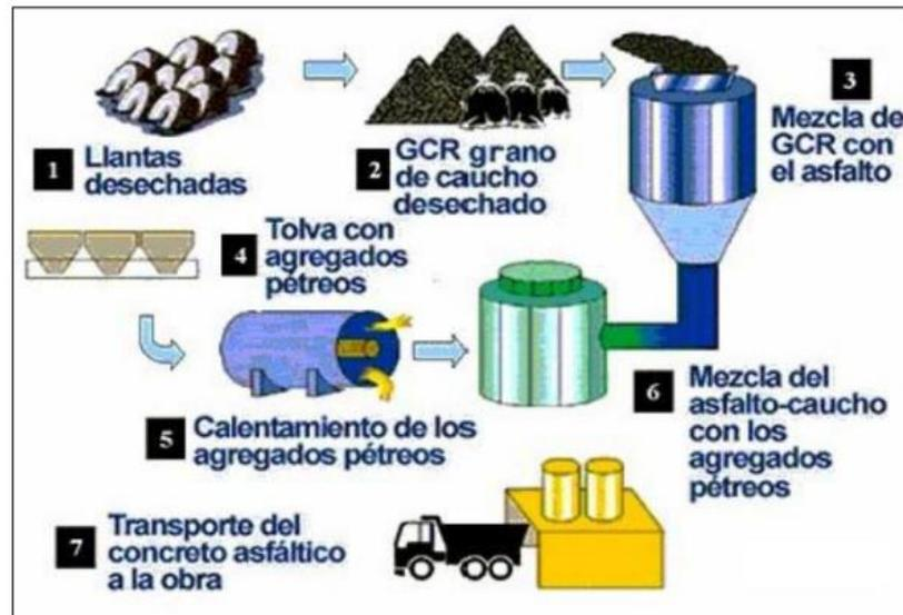
*Figura 8:* Proceso de Modificación por la vía húmeda
