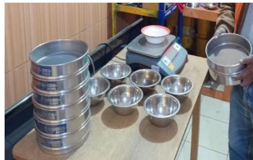
**Figura 46:** Análisis Granulométrico por Tamizado
