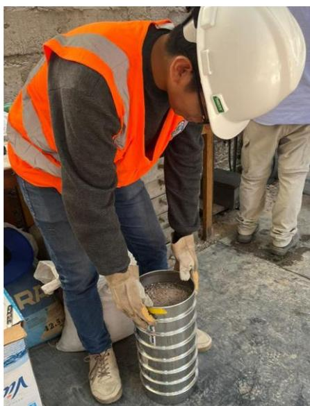
**Figura 53:** Tamizado agregado fino.
