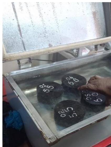
**Figura 63:** Sumergido de briqueta Baño Térmico
