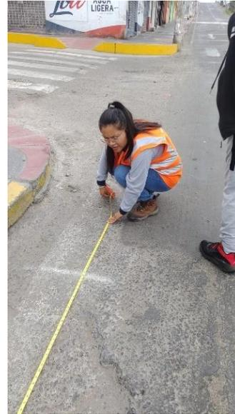
**Figura 41:** Medición de exudación.
