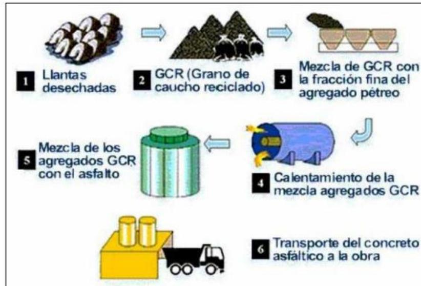
**Figura 9:** Proceso de Modificación por vía seca
