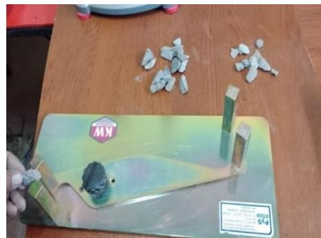
**Figura 48:** Ensayo de partículas chatas y alargadas.
