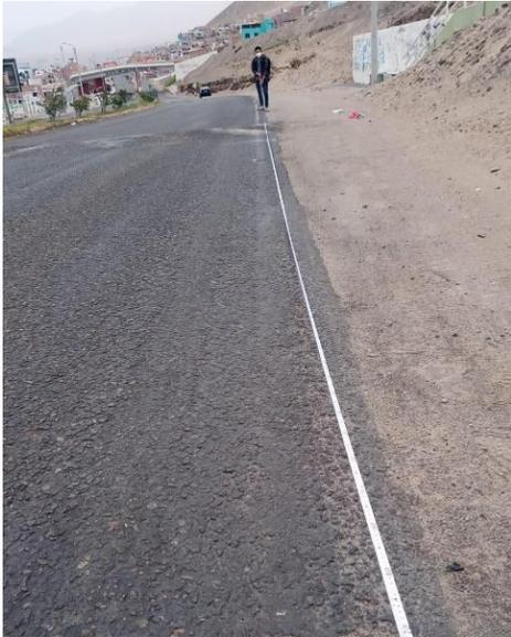
**Figura 40:** Medición de tramo 35m.
