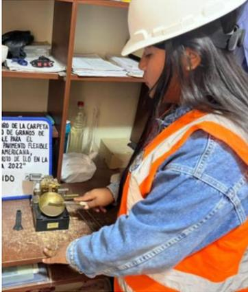
**Figura 49:** Ensayo de Índice de plasticidad-
