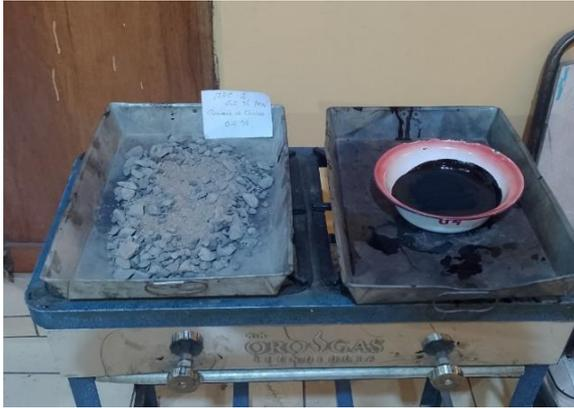
**Figura 58:** Procedimiento de calentado de agregado y PEN 60/70.
