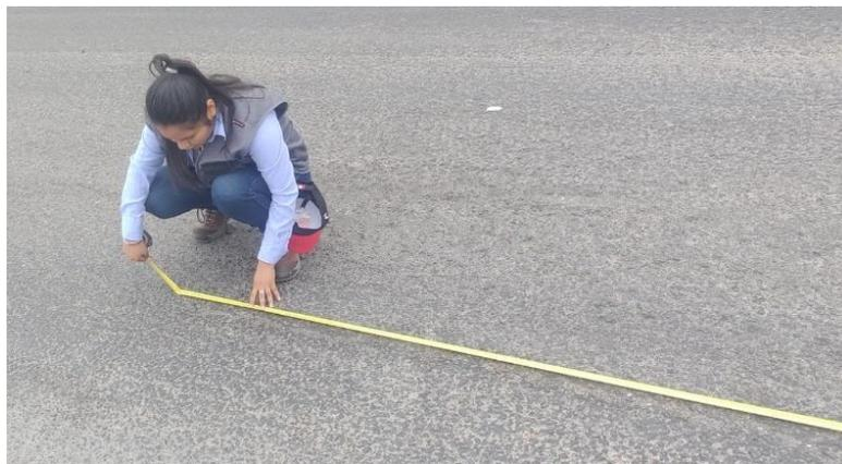
**Figura 42:** Medición de grieta longitudinal y transversal.
