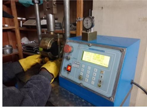
**Figura 65:** Ensayo Marshall, estabilidad y flujo.
