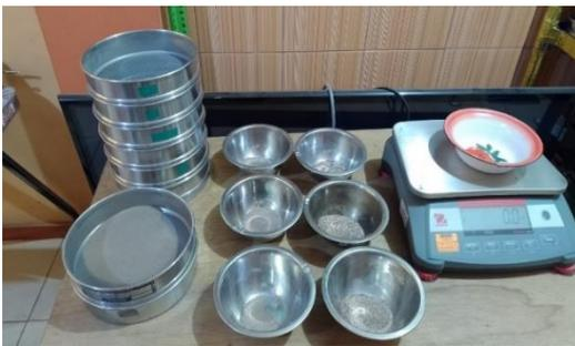
**Figura 45:** Análisis Granulométrico por Tamizado
