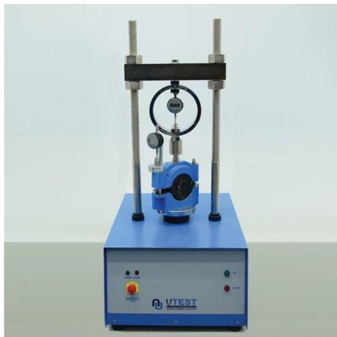
**Figura 5:** Máquina usada para el Método Marshall
