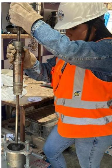
**Figura 62:** Moldeo de briqueta Marshall,
