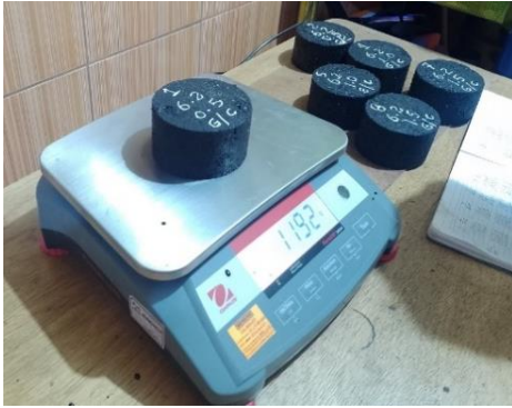
Figura 64: Determinación de peso unitario.
