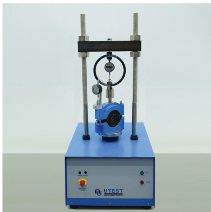
Figura 5: Máquina usada para el Método Marshall Fuente: UTEST
