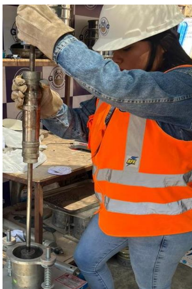
Figura 62: Moldeo de briqueta Marshall, 75 golpes por lado Fuente: Elaboración propia
