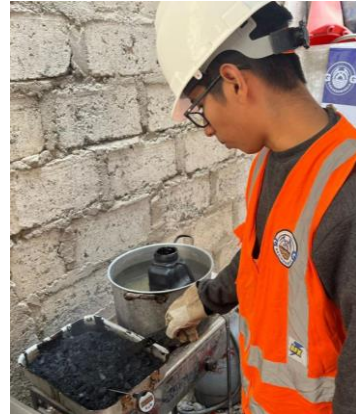
Figura 59: Mezcla de agregados + C. Asfáltico. Fuente: Elaboración Propia.
