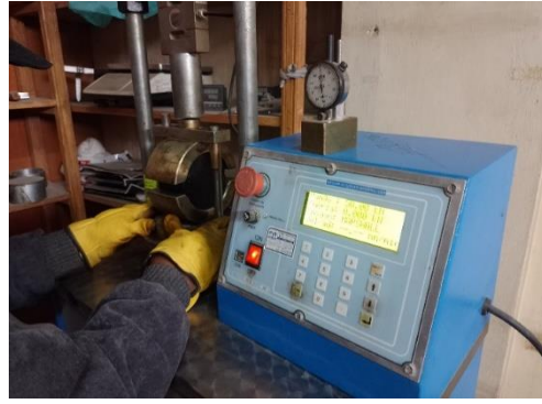
Figura 65: Ensayo Marshall, estabilidad y flujo.
