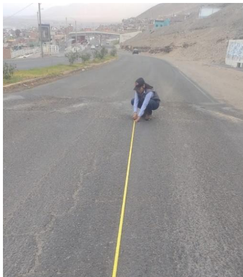
Figura 14: Medición de fallas con el Flexómetro Fuente: Elaboración Propia
