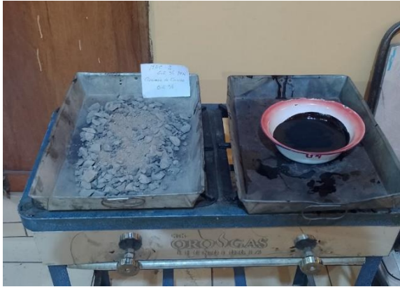
Figura 58: Procedimiento de calentado de agregado y PEN 60/70. Fuente: Elaboración Propia.
