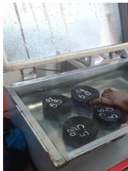
Figura 63: Sumergido de briqueta Baño Térmico con el agua a 60 °C por 30 minutos. Fuente: Elaboración propia
