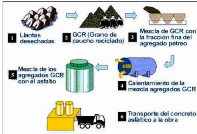
Figura 9: Proceso de Modificación por vía seca
