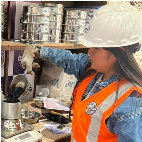
Figura 60: Colocación de Mezcla en probeta Fuente: Elaboración Propia.
