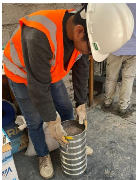
Figura 53: Tamizado agregado fino. Fuente: Elaboración Propia.
