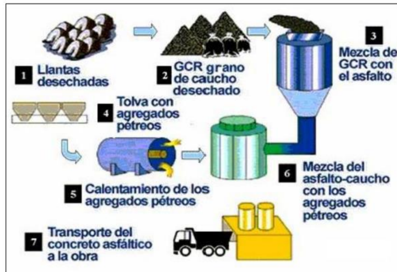
Figura 8: Proceso de Modificación por la vía húmeda
