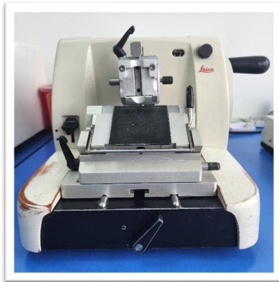
**Figura 5** *Micrótopo de tipo Minot. Foto tomada en el Laboratorio Diagnosis S.A.C.*
