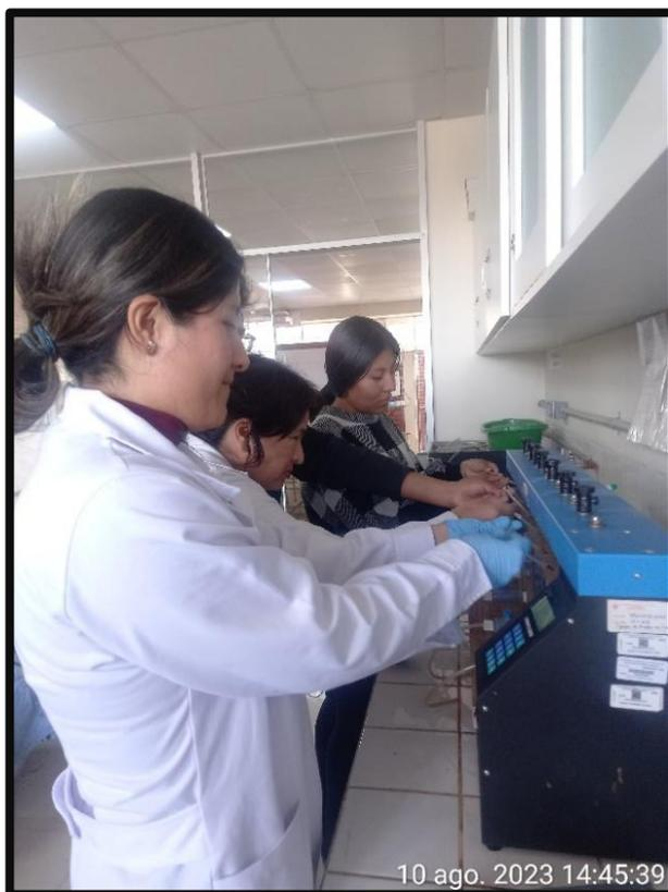
*Nota.* Agregación de l coagulante en la mezcla rápida
