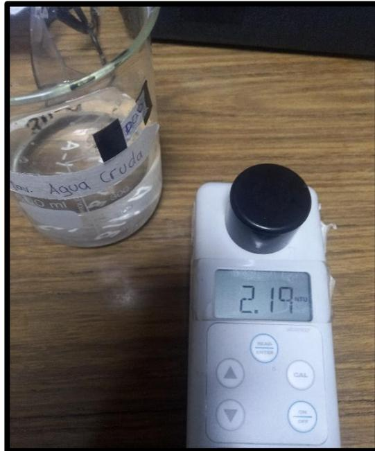
*Nota.* Medición de turbidez de la muestra después de la prueba de jarras (Prueba 1)
