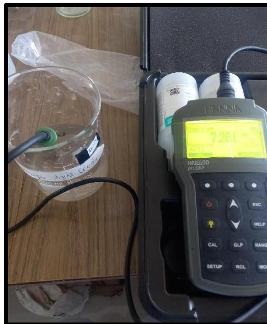
*Nota..* Medición de pH de la muestra después de la prueba de jarras (Prueba 3 y 4)
