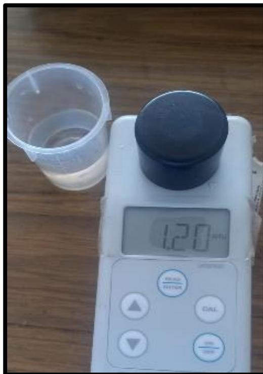
*Nota.* Medición de turbidez de la muestra después de la prueba de jarras (Prueba 4)
