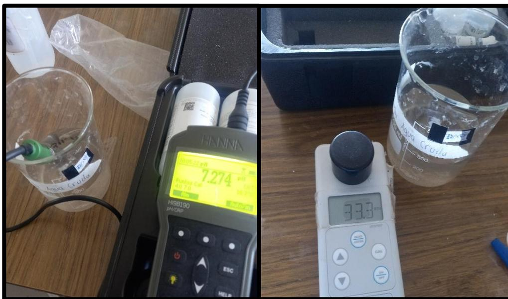
*Nota.* Medición de parámetros fisicoquímicos de las muestras de agua cruda antes del ensayo de Jarras (Pruebas 3 y 4)
