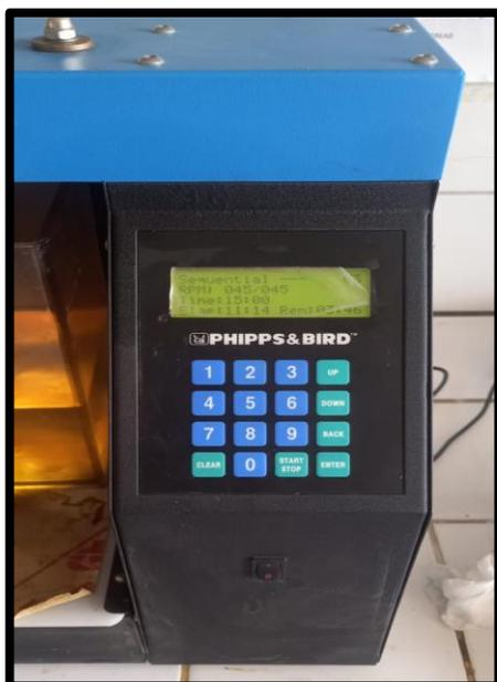
*Nota.* Programación del equipo para ensayo de jarras
