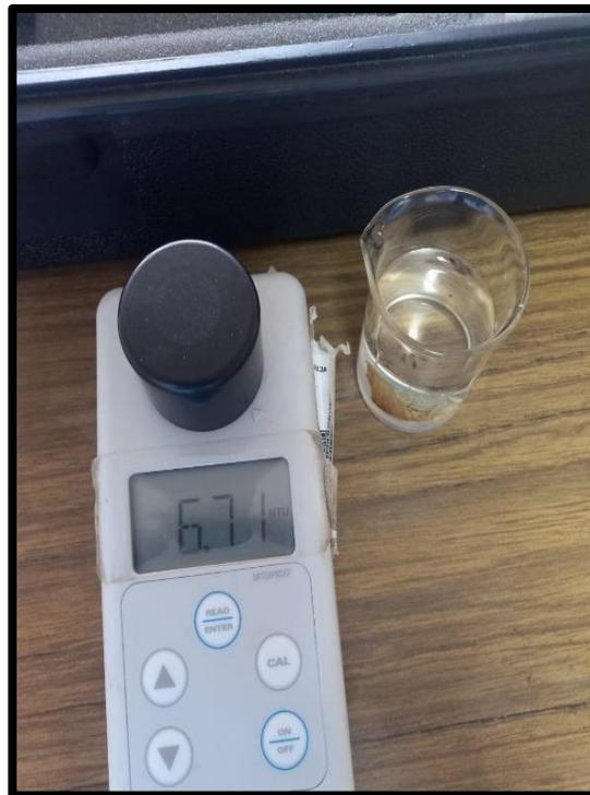
*Nota.* Medición de turbidez de la muestra después de la prueba de jarras (Prueba 2)
