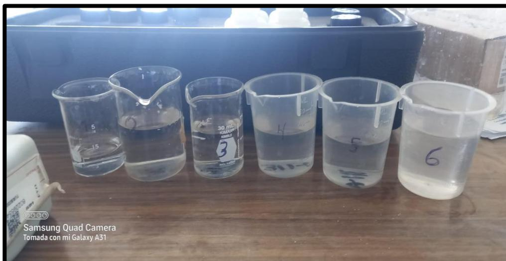
*Nota.* Medición de parámetros fisicoquímicos de las muestras de agua cruda después del ensayo de jarras
