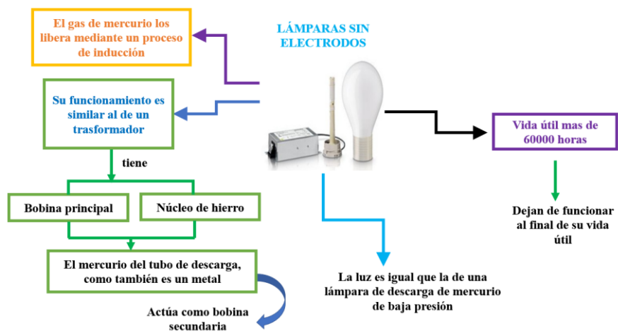
Figura 9. Principios de la lámpara de Electrodo
