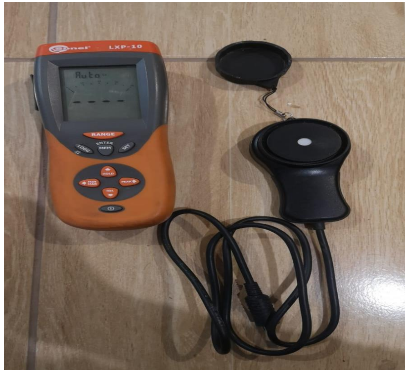
Figura 24. Luxómetro Sonel lxp-10A
