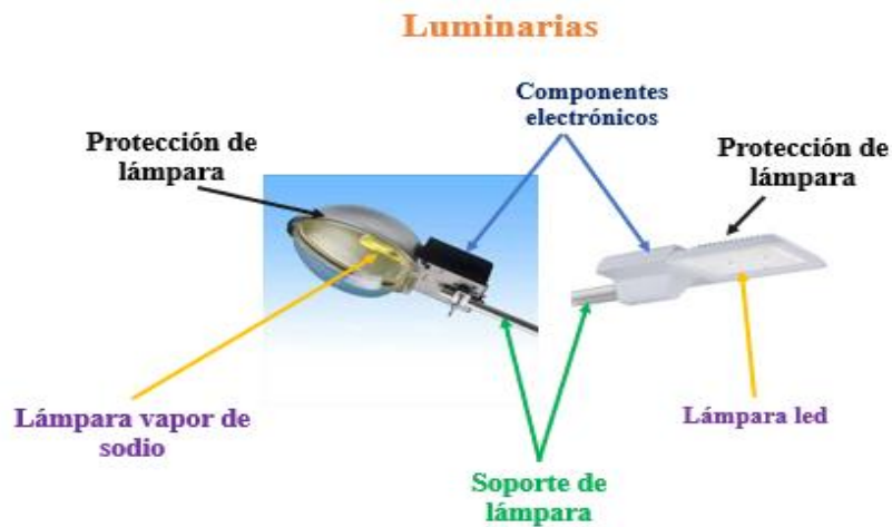
Figura 3. Diferencia de Luminarias Vapor de Sodio y Luminarias de tecnología Led
