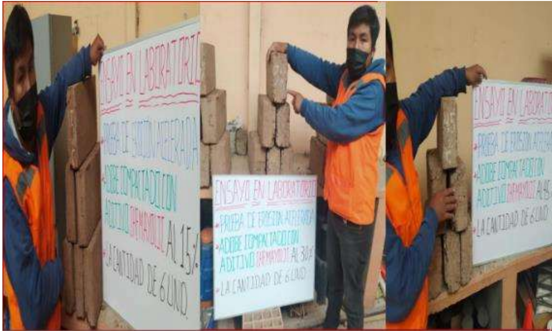
Prueba De Erosión Acelerada - Con La Mezcla De Los Aditivos Sika-1 y CHEMAYOLIC
