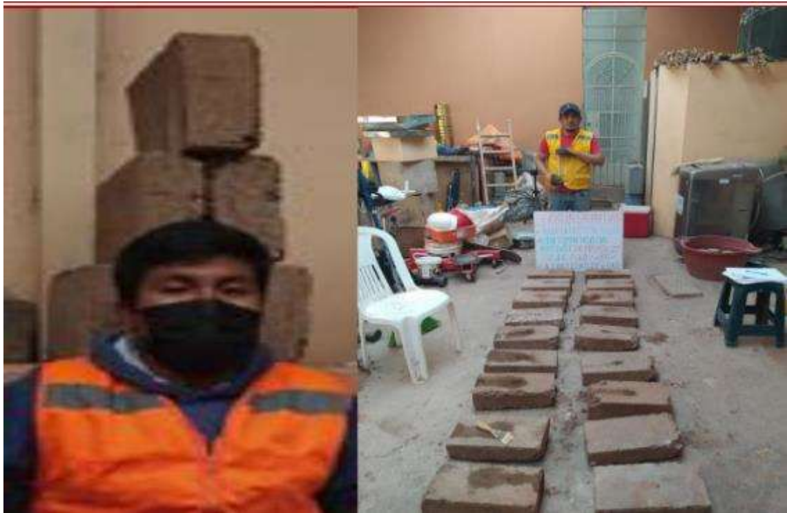
Prueba De Erosión Acelerada - Con Presencia De Aditivo Sika-1
