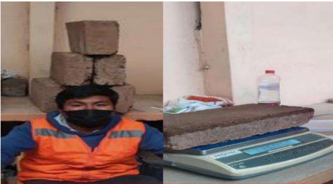
Prueba De Succión - Con El Aditivo Sika-1
