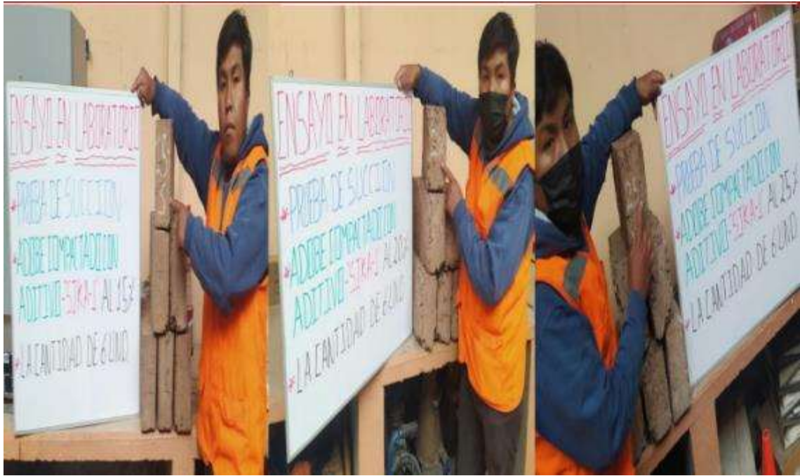
Prueba De Succión - Con El Aditivo CHEMAYOLIC
