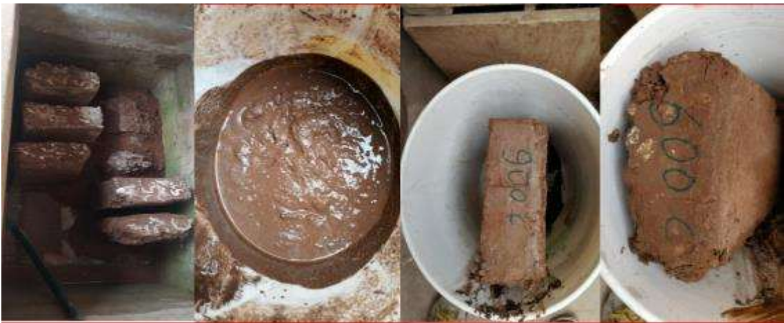
Prueba De Succión - Sin Presencia de Aditivo
