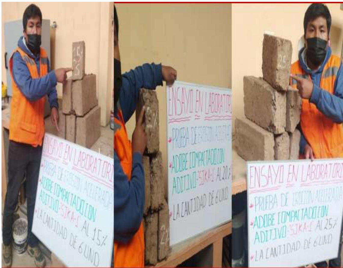
Prueba De Erosión Acelerada - Con Presencia De Aditivo CHEMAYOLIC
