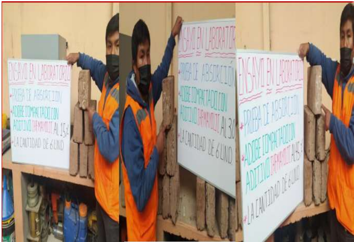
Prueba De Absorción - La Combinación De Los Dos Aditivos Sika-1 y CHEMAYOLIC
