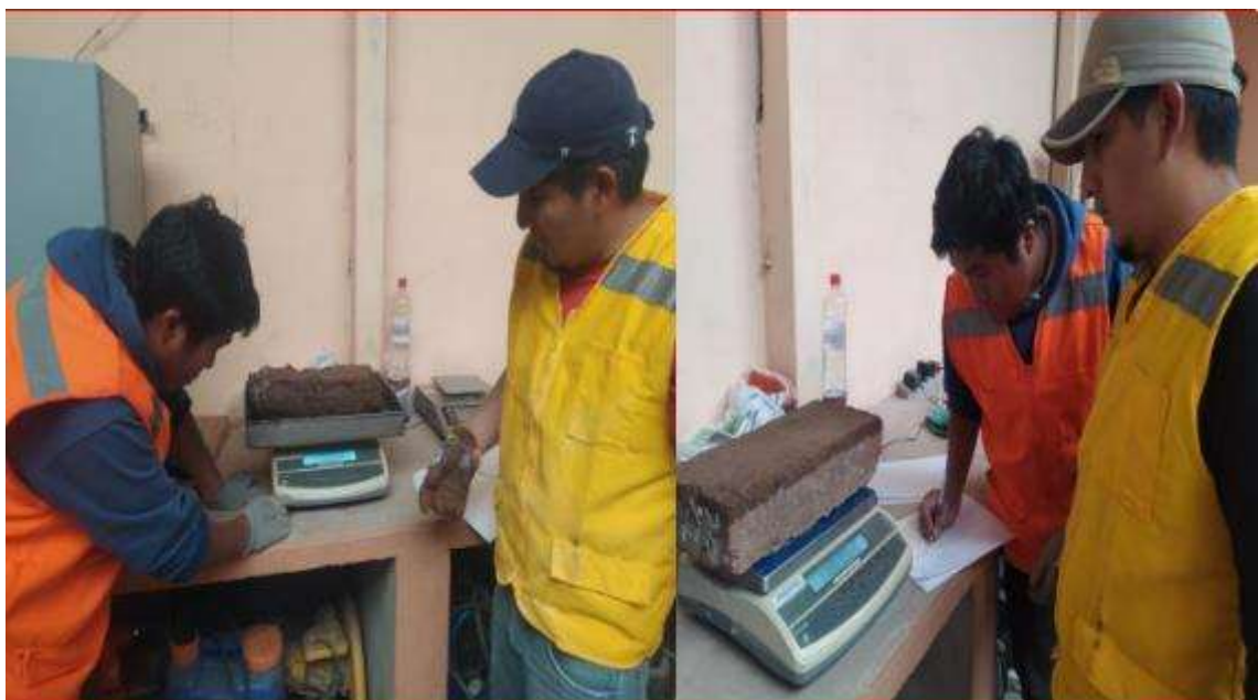
Prueba De Erosión Acelerada - Sin Presencia De Aditivo
