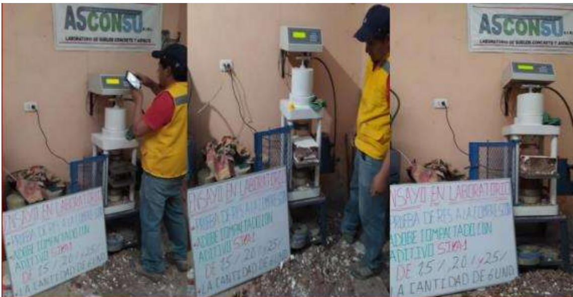
Prueba De Resistencia A La Compresión - Con El Aditivo CHEMAYOLIC
