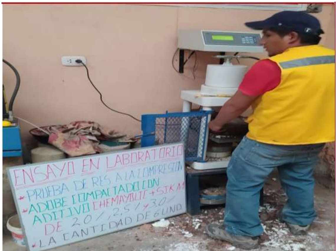
Prueba De Resistencia A La Compresión - Con La Mezcla De Los Aditivos Sika-1 y CHEMAYOLIC
