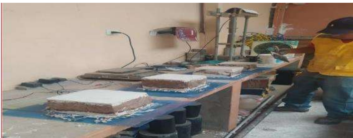
Prueba De Resistencia A La Compresión - Con El Aditivo Sika-1
