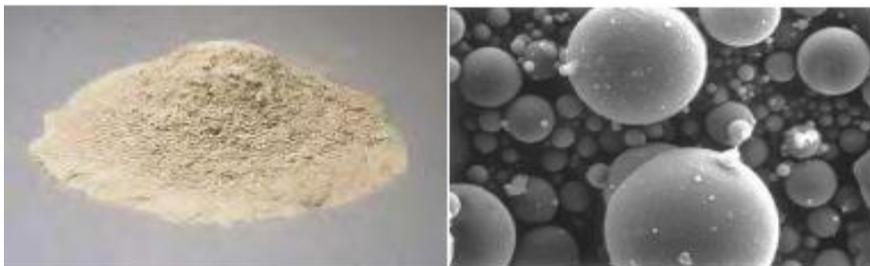
**La Norma ASTM C 618-03** posee dos clases de cenizas:
