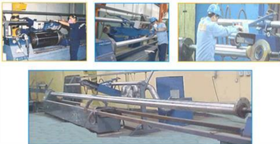
Figura N° 12 Proceso de pulido de vástago
