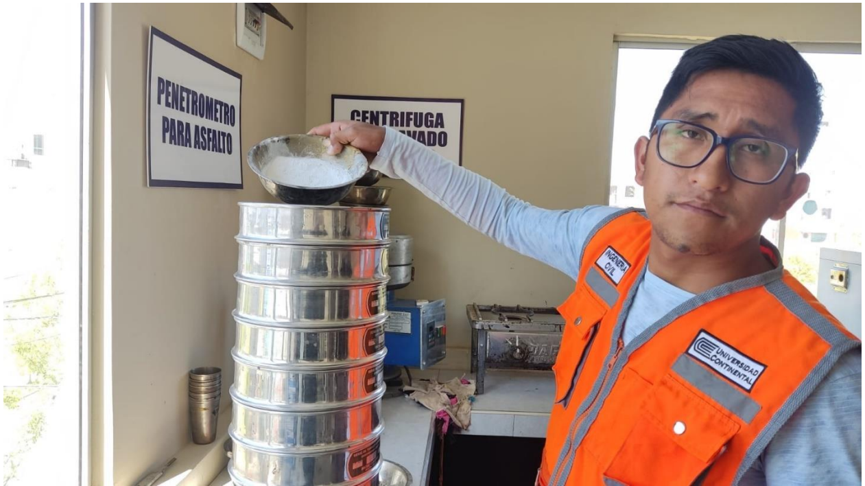
Fotografía 5: Tamizado de filler (cal).
