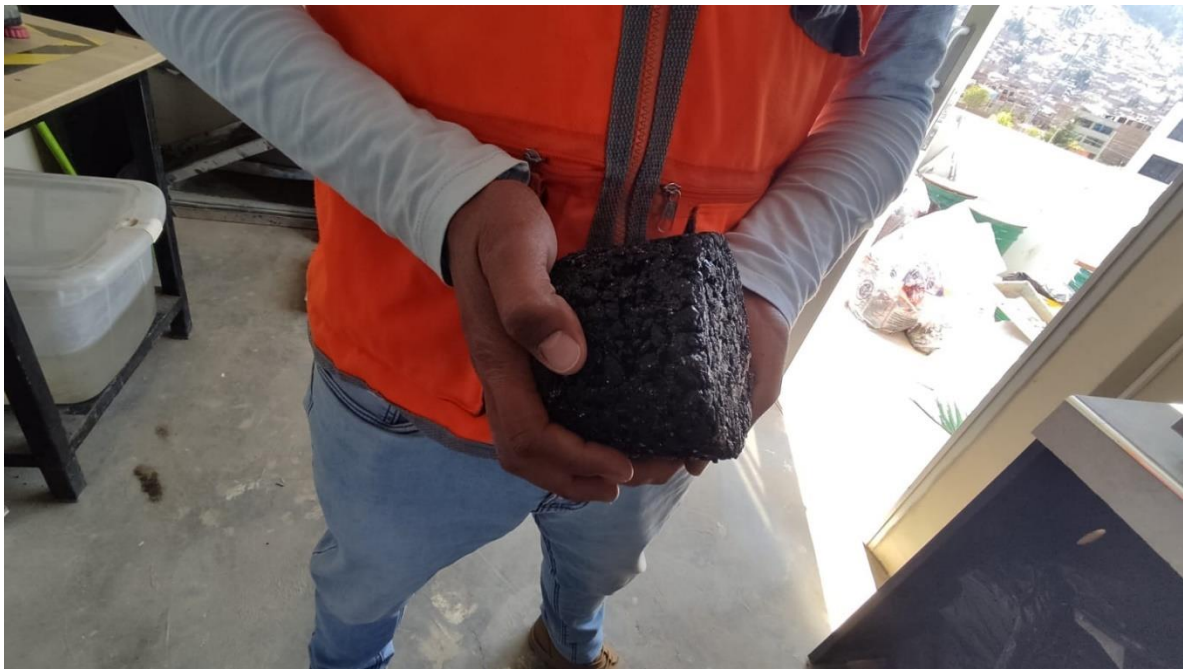
Figura 15: briqueta de mezcla asfáltica drenante
