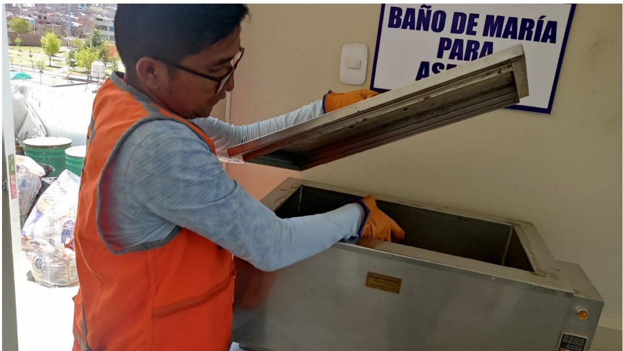
Fotografía 26: Acondicionamiento de muestra en baño maría a 60°C por 30 minutos para ensayo con la prensa de Marshall.
