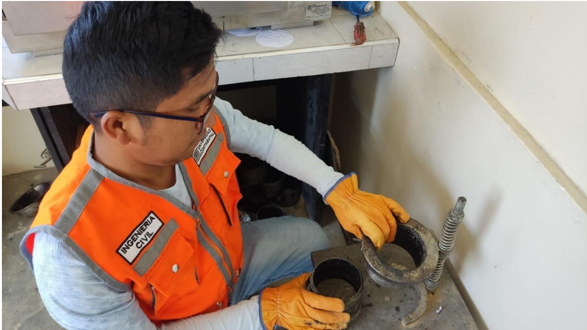
Fotografía 15: Colocado de los materiales del pedestal para a elaboración de briquetas de acuerdo al porcentaje de contenido de ligante asfáltico (4%, 4.5%, 5%, 5.5%, 6% y 6.5%).
