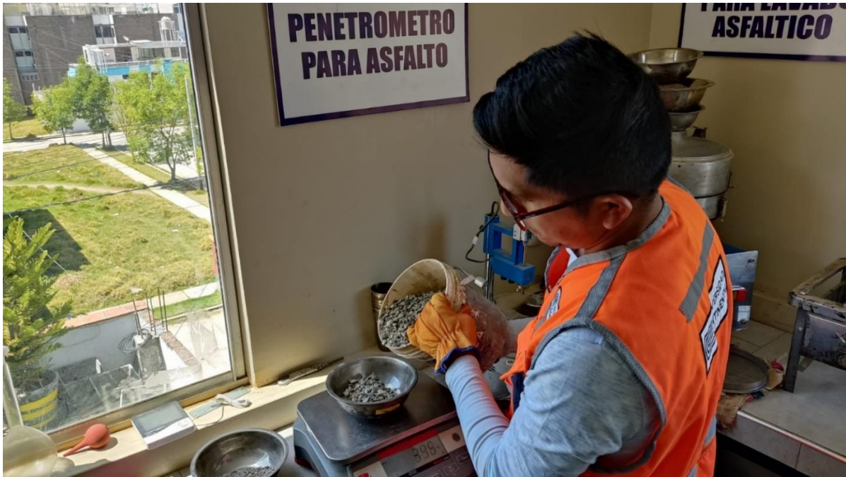
Fotografía 9: Pesado de agregado para elaboración de briquetas de acuerdo al porcentaje de contenido de ligante asfáltico (4%, 4.5%, 5%, 5.5%, 6% y 6.5%).
