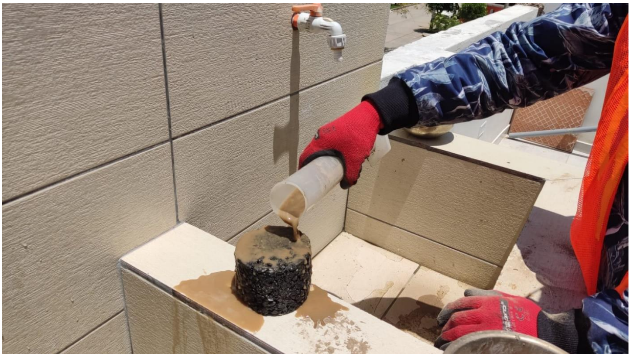
Fotografía 40: Para la sedimentación de briquetas se vierte la mezcla con sedimentos sobre las muestras cada 24h o menos de acuerdo que la muestra se seque hasta taponear las partes abiertas de la briqueta casi en su totalidad.
