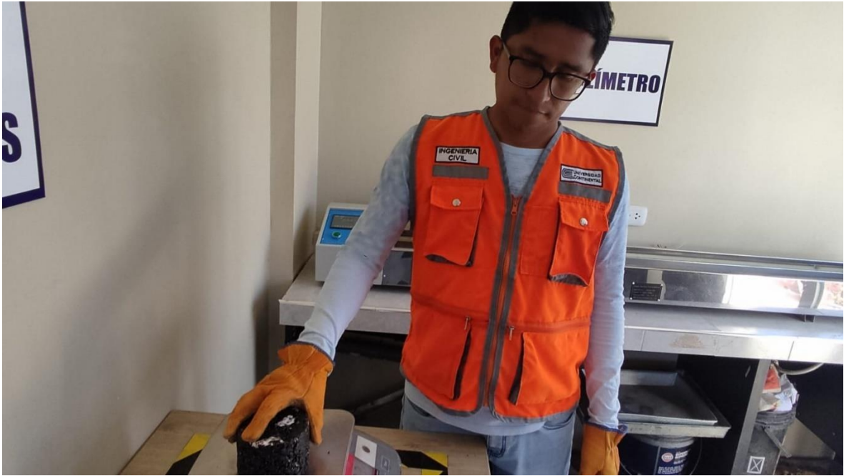
Fotografía 23: Para la obtención del porcentaje de vacíos se pesa la muestra en seco.
