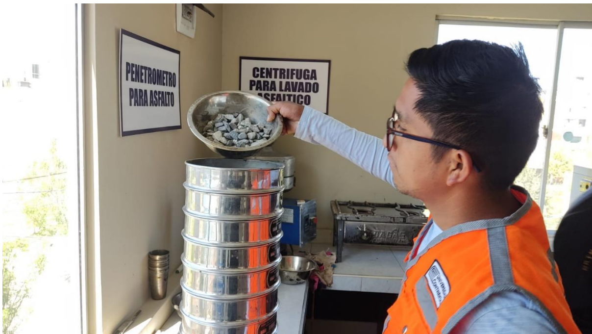
Fotografía 2: Tamizado de 3kg de agregado de piedra chancada de 1/2".
