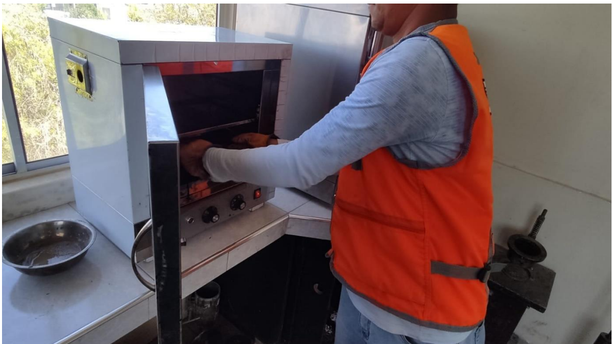
Fotografía 8: Horneado de cemento asfáltico PEN 85-100 con polímeros para elaboración de briquetas.
