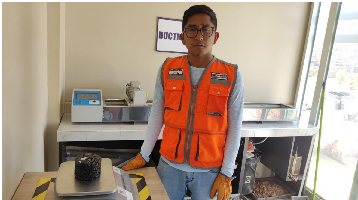
Fotografía 30: Para el ensayo de cántabro en seco se pesa la muestra a temperatura ambiente.
