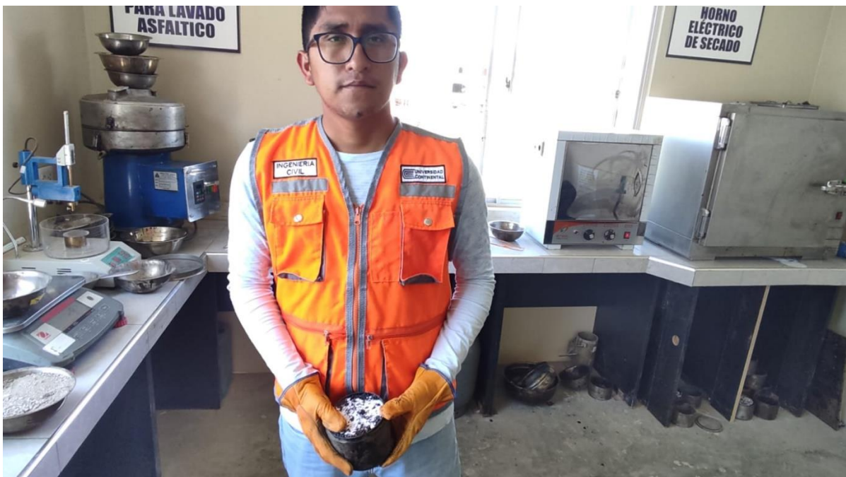
Fotografía 20: Obtención de la briqueta de acuerdo al porcentaje de contenido de ligante asfáltico (4%, 4.5%, 5%, 5.5%, 6% y 6.5%).
