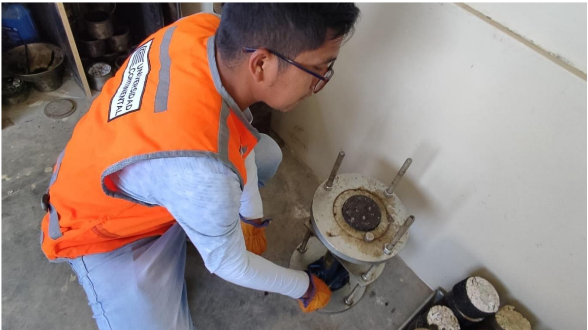
Fotografía 22: Desencofrado de la briqueta de acuerdo al porcentaje de contenido de ligante asfáltico (4%, 4.5%, 5%, 5.5%, 6% y 6.5%).
