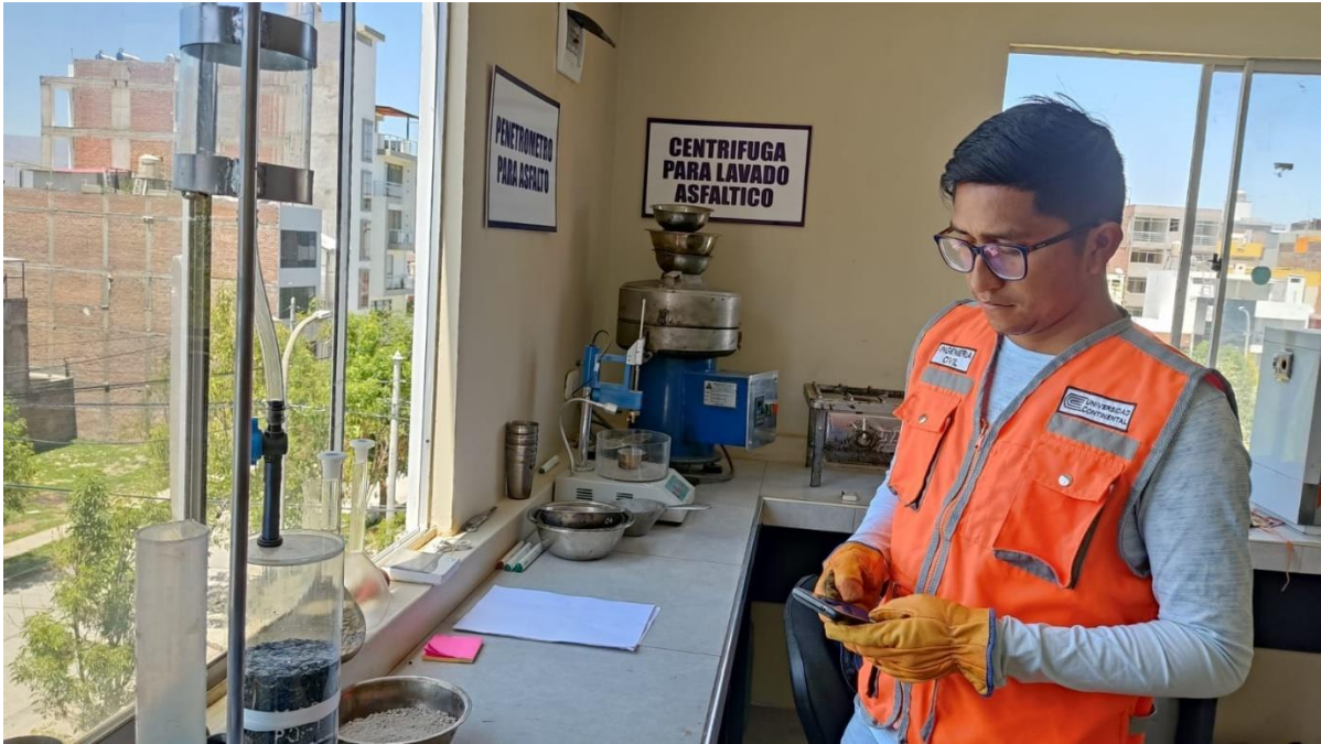
Fotografía 37: Toma del tiempo de evacuación del agua por las partes abiertas de la briqueta
