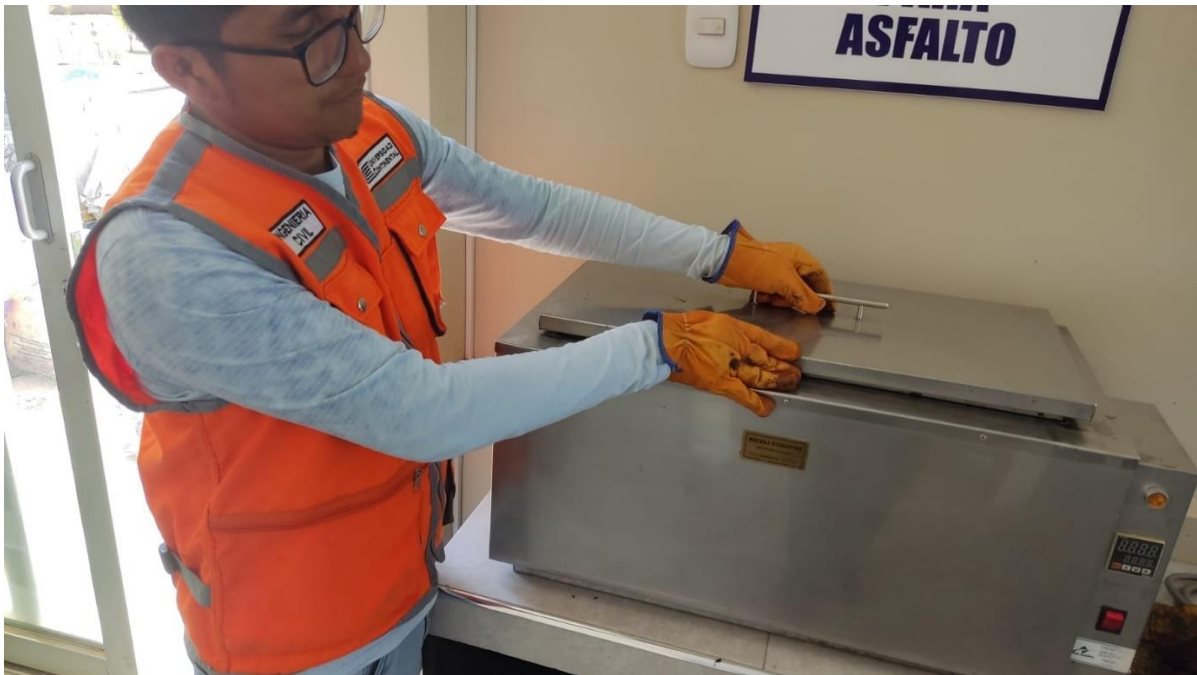
Fotografía 34: Para el ensayo de cántabro tras inmersión se coloca la muestra por 24h a 60°C.
