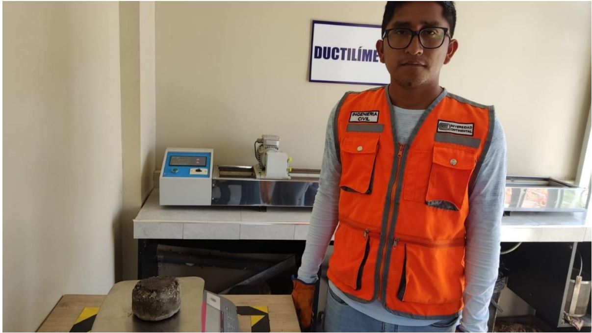
Fotografía 33: Pesado de la muestra después del ensayo en la maquina los ángeles.
