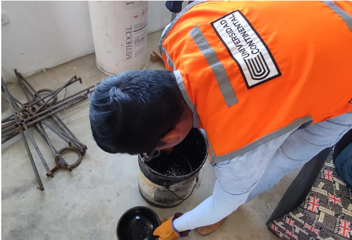
Fotografía 7: Extracción de cemento asfáltico PEN 85-100 con polímeros para elaboración de briquetas de acuerdo al porcentaje de contenido de ligante asfáltico (4%, 4.5%, 5%, 5.5%, 6% y 6.5%).
