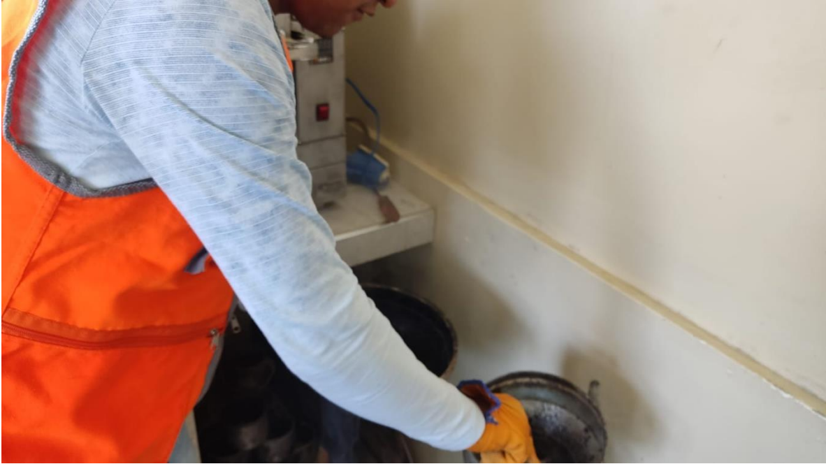
Fotografía 17: Colocado de la mezcla asfáltica de acuerdo al porcentaje de contenido de ligante asfáltico (4%, 4.5%, 5%, 5.5%, 6% y 6.5%).
