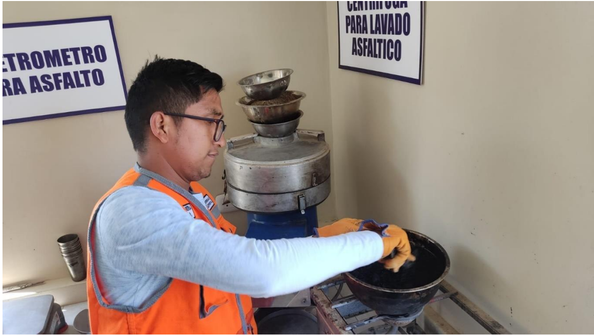
Fotografía 13: Toma de temperatura de mezcla asfáltica de acuerdo al porcentaje de contenido de ligante asfáltico (4%, 4.5%, 5%, 5.5%, 6% y 6.5%).
