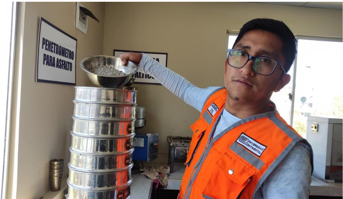
Fotografía 4: Tamizado de 1.5kg de agregado de arena zarandeada.
