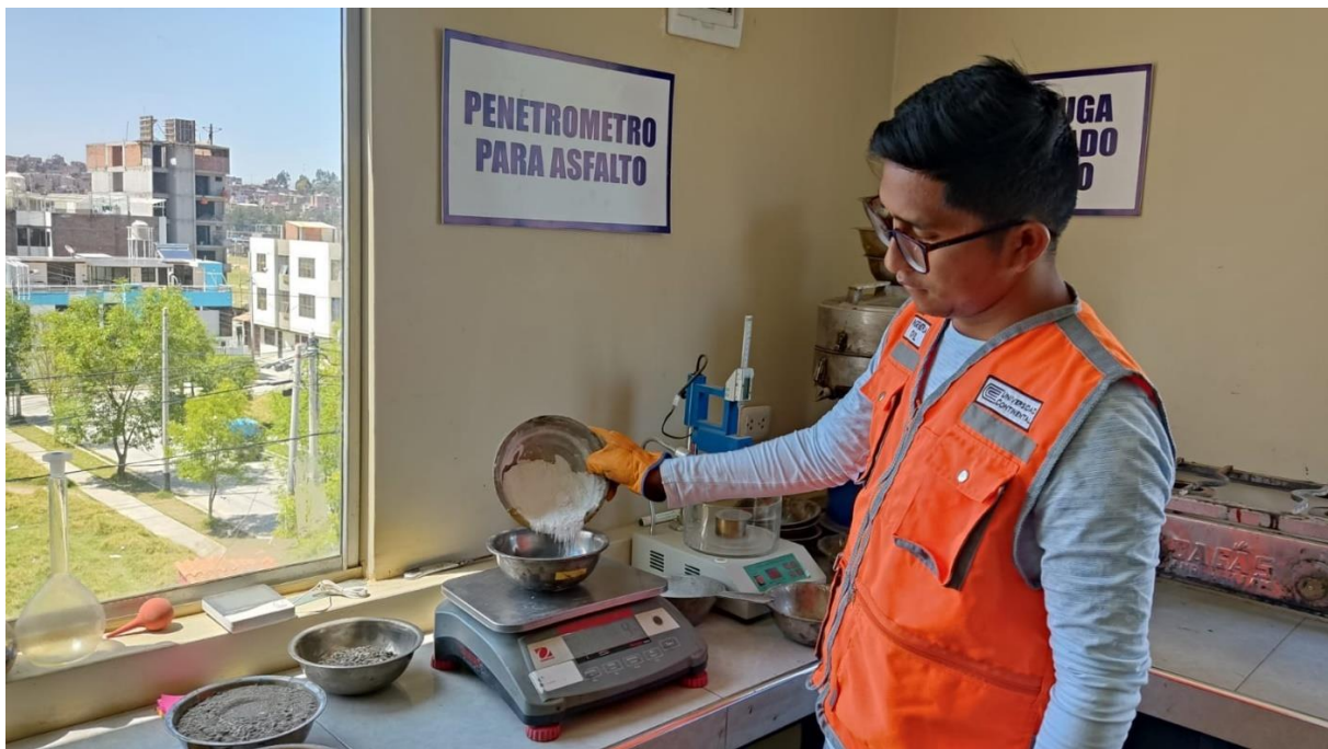
Fotografía 10: Pesado de filler para elaboración de briquetas de acuerdo al porcentaje de contenido de ligante asfáltico (4%, 4.5%, 5%, 5.5%, 6% y 6.5%).
