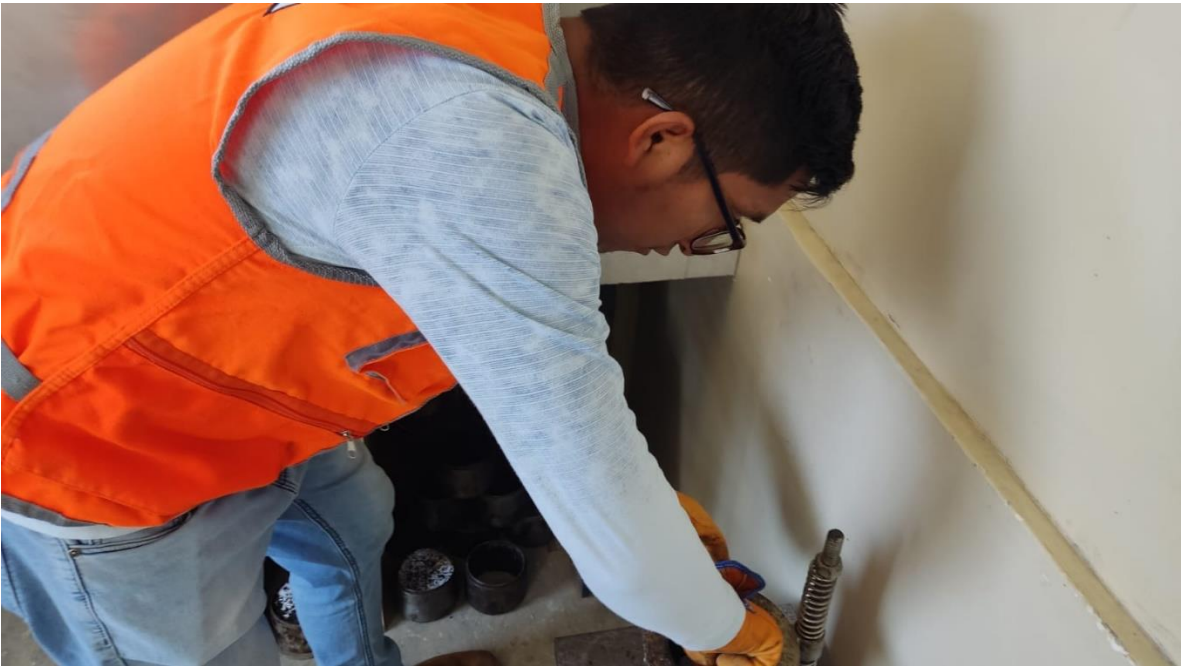
Fotografía 18: Colocado de papel filtro sobre la mezcla de acuerdo al porcentaje de contenido de ligante asfáltico (4%, 4.5%, 5%, 5.5%, 6% y 6.5%).
