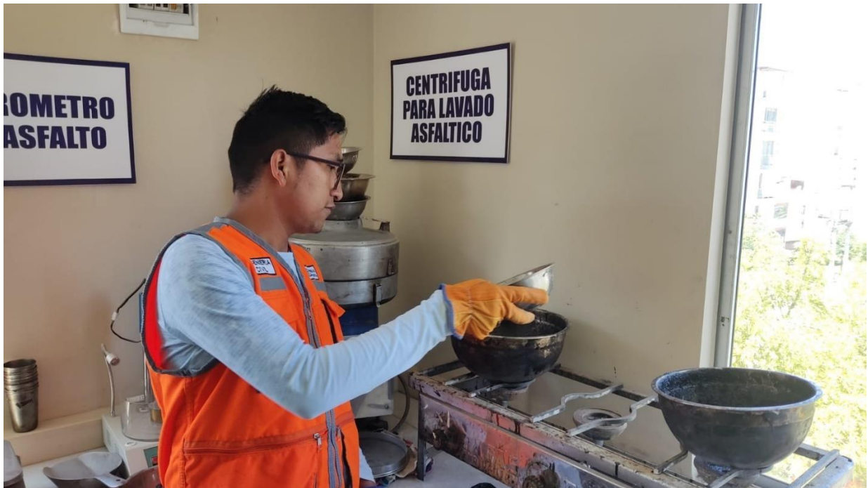
Fotografía 12: Mezcla de agregado, filler y ligante asfáltico modificado a temperatura de mezcla para elaboración de briquetas de mezcla asfáltica drenante de acuerdo al porcentaje de contenido de ligante asfáltico (4%, 4.5%, 5%, 5.5%, 6% y 6.5%).
