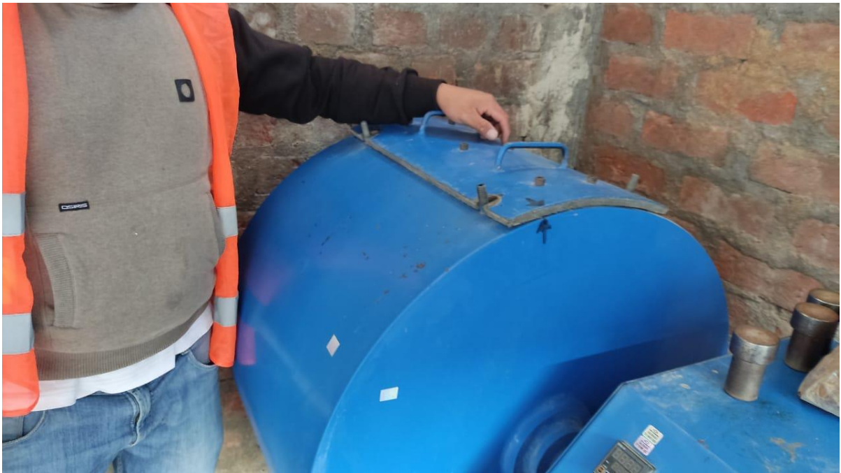
Fotografía 46: Ensayo de desgaste al cántabro con briquetas con mantenimiento.
