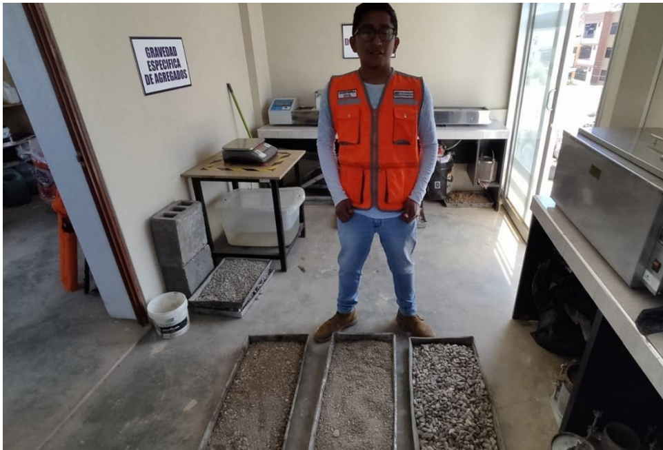
Fotografía 1: Agregados para la elaboración de briquetas: piedra chancada de 1/2", arena triturada y arena zarandeada.
