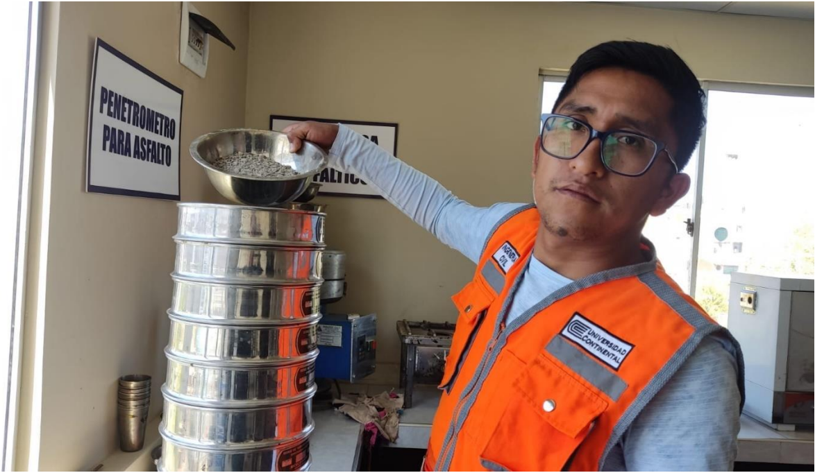
Fotografía 3: Tamizado de 1.5kg de agregado de arena triturada.
