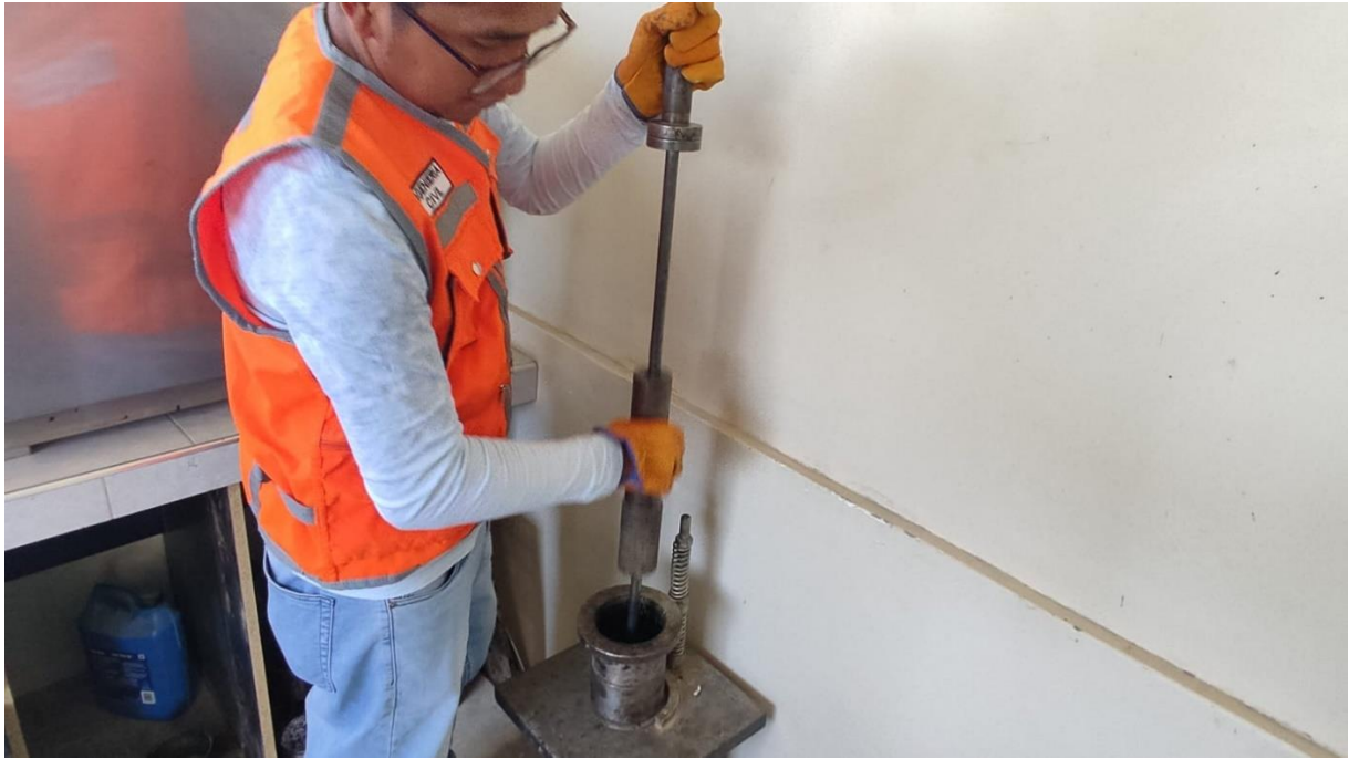
Fotografía 19: Compactación de la mezcla asfáltica de acuerdo al porcentaje de contenido de ligante asfáltico (4%, 4.5%, 5%, 5.5%, 6% y 6.5%) con 50 golpes.
