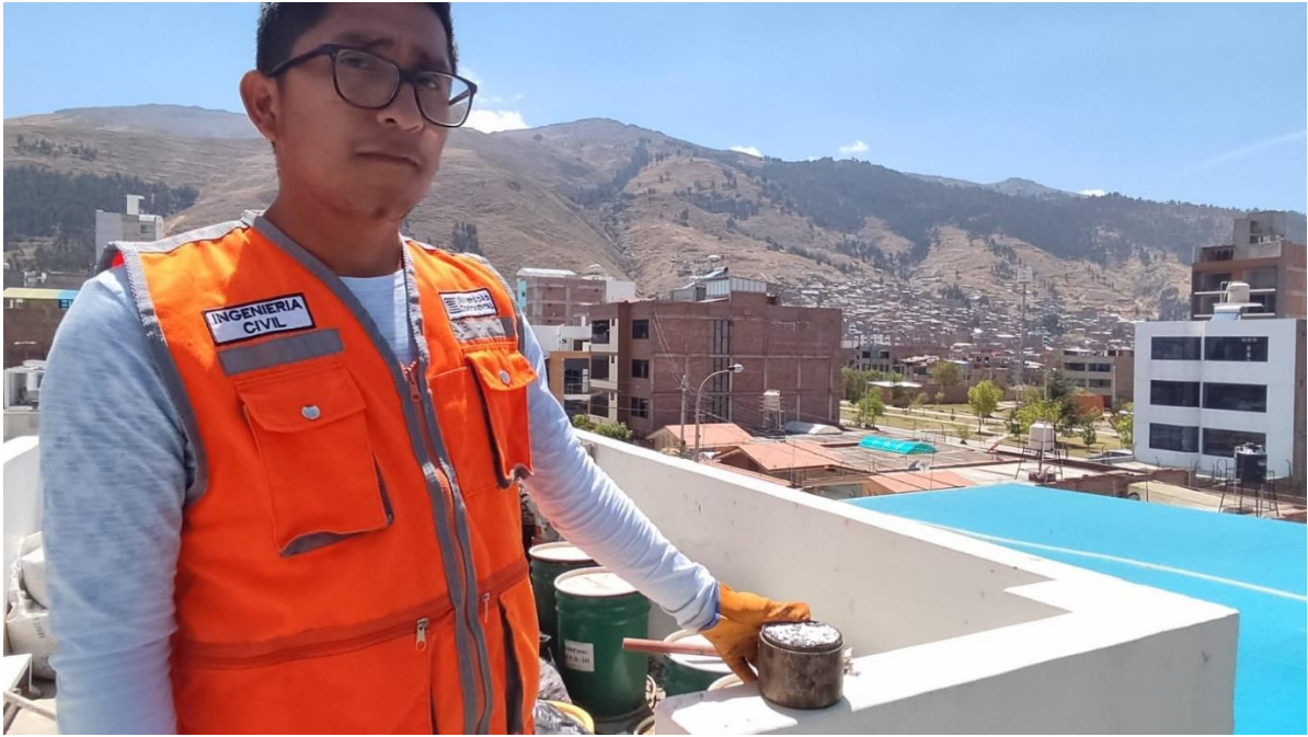
Fotografía 21: Enfriamiento de la briqueta con el molde a temperatura ambiente de acuerdo al porcentaje de contenido de ligante asfáltico (4%, 4.5%, 5%, 5.5%, 6% y 6.5%).
