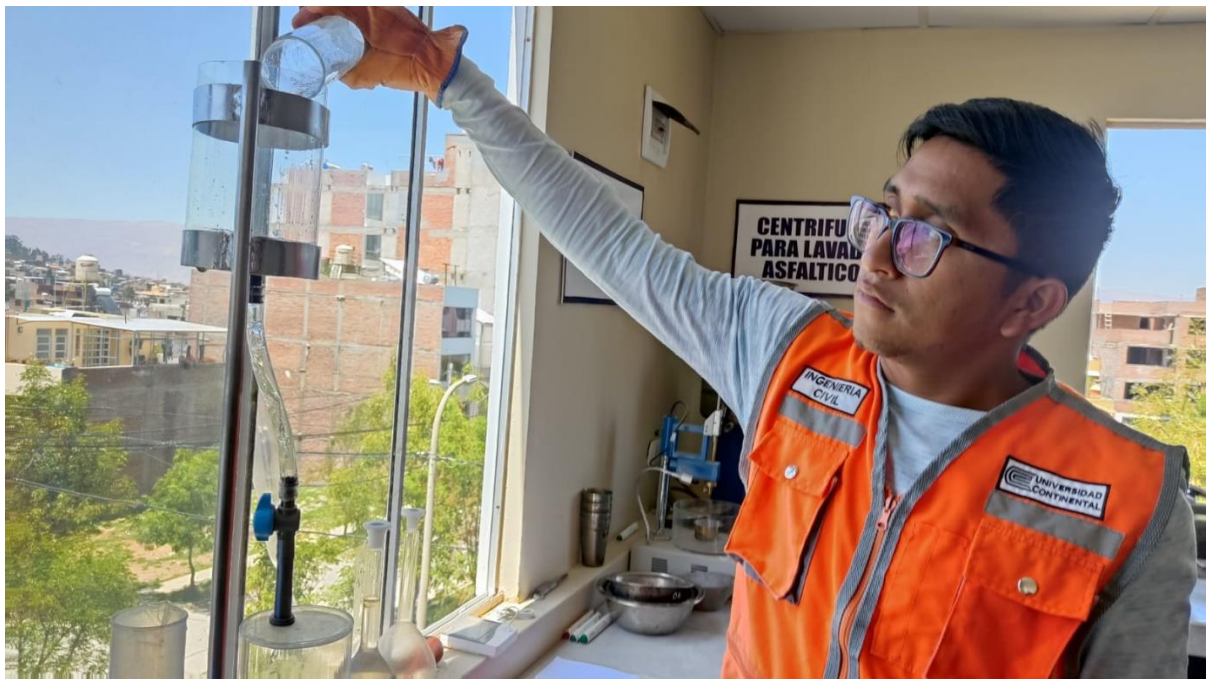
Fotografía 36: Vertimiento de 100ml de agua sobre la muestra.
