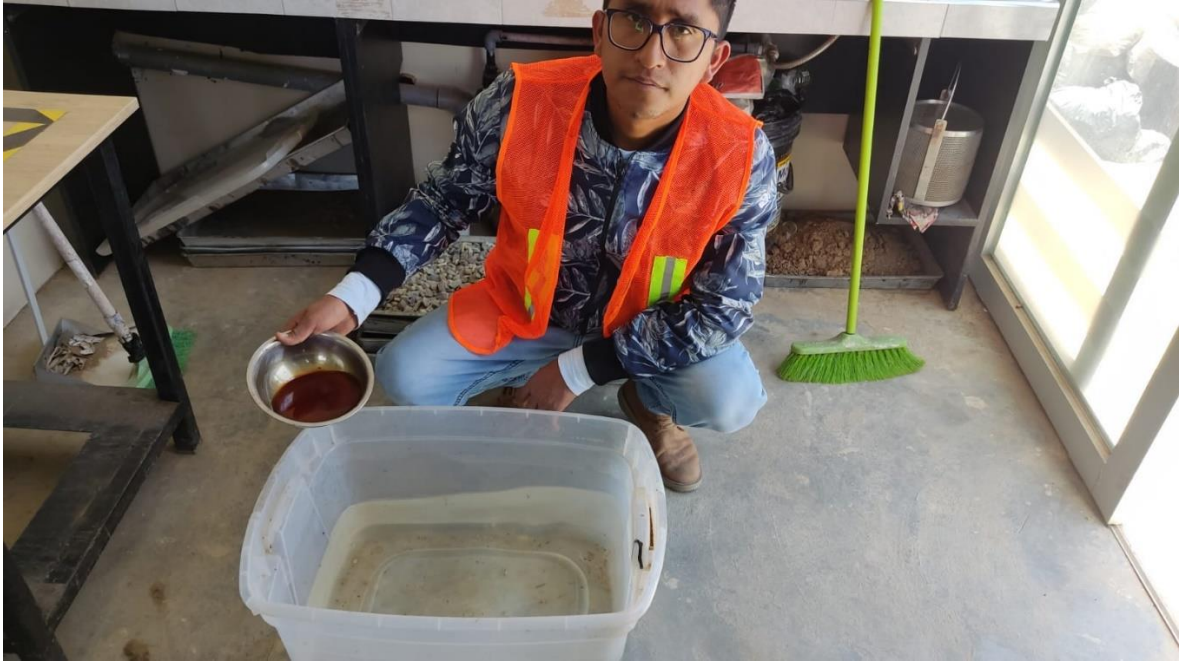
Fotografía 43: Mezclado del agua con tensoactivo de la palma en distintos porcentajes (0%, 10%, 15% y 20%)
