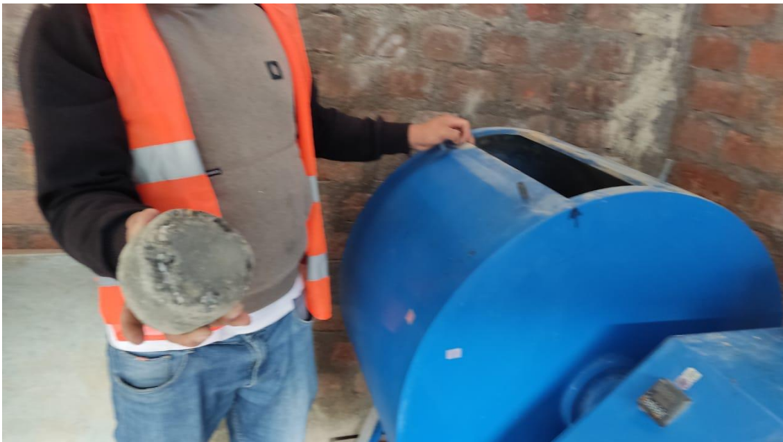
Fotografía 32: Después de 300 vueltas en la máquina de los ángeles se extrae la muestra y se limpia con una brocha para quitar las partículas desprendidas
