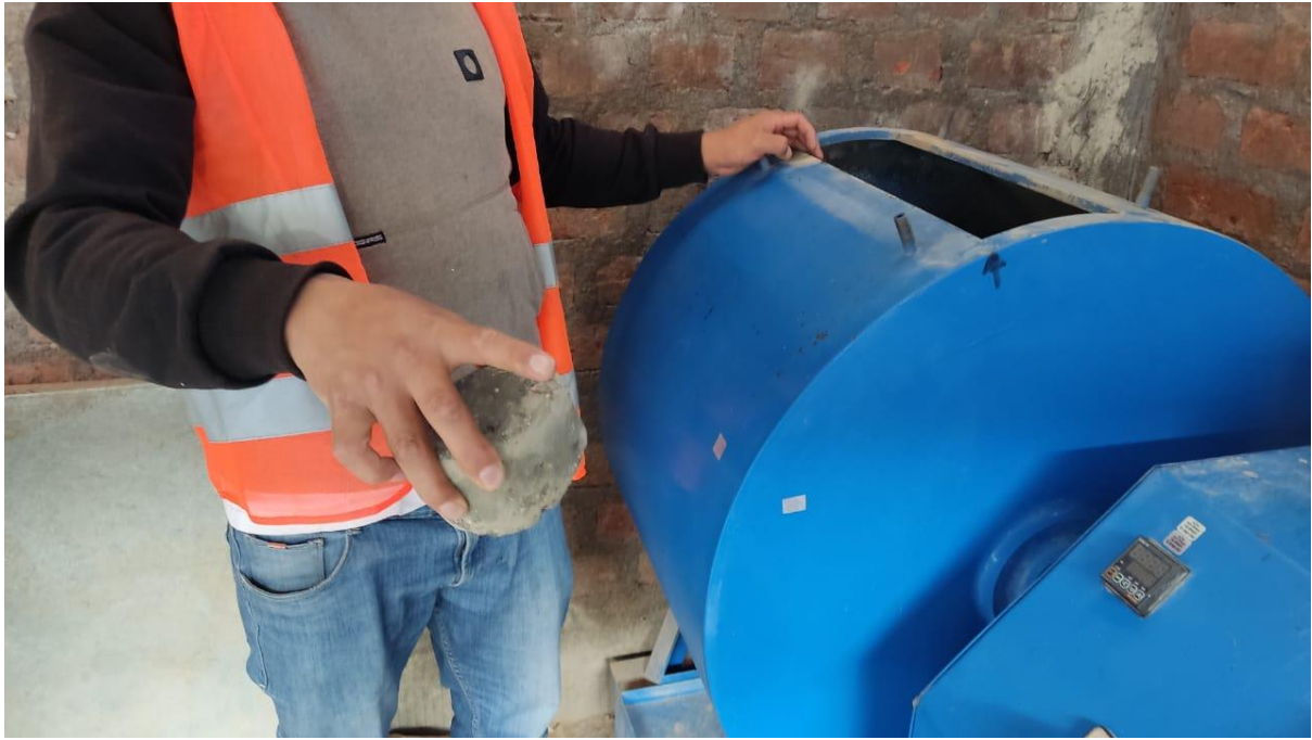
Fotografía 35: Extracción de la briqueta y limpiado para quitar el material excedente.
