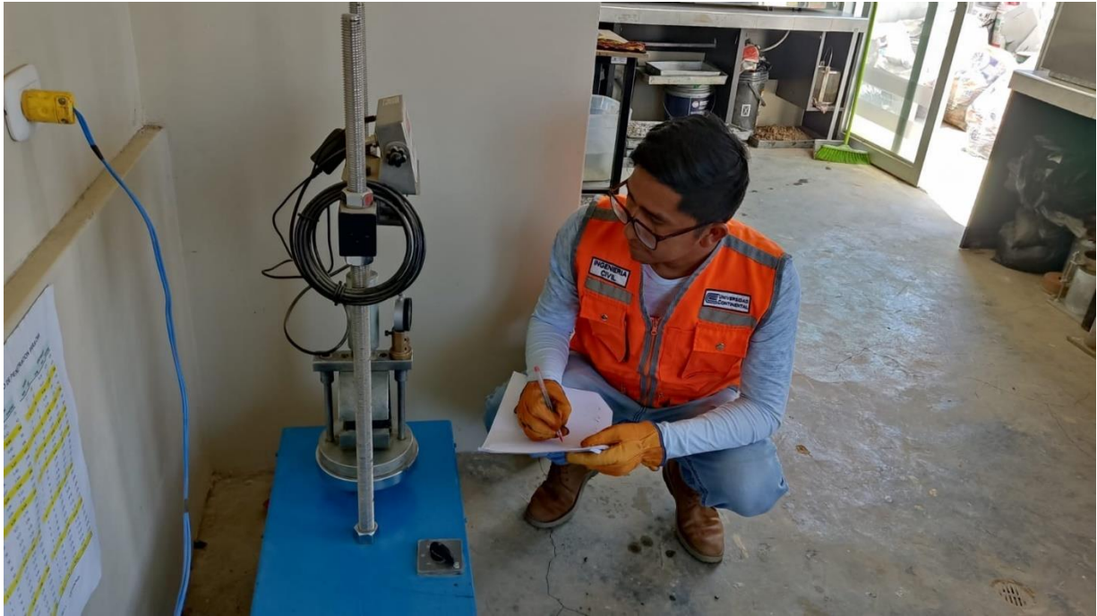
Fotografía 29: Toma de datos de la estabilidad y flujo de la muestra.
