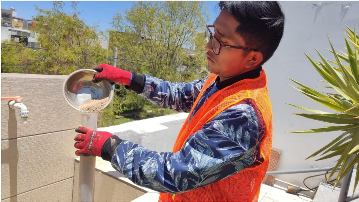
Fotografía 39: Mezcla de agua con el 20% de sedimentos con respecto del peso del agua.
