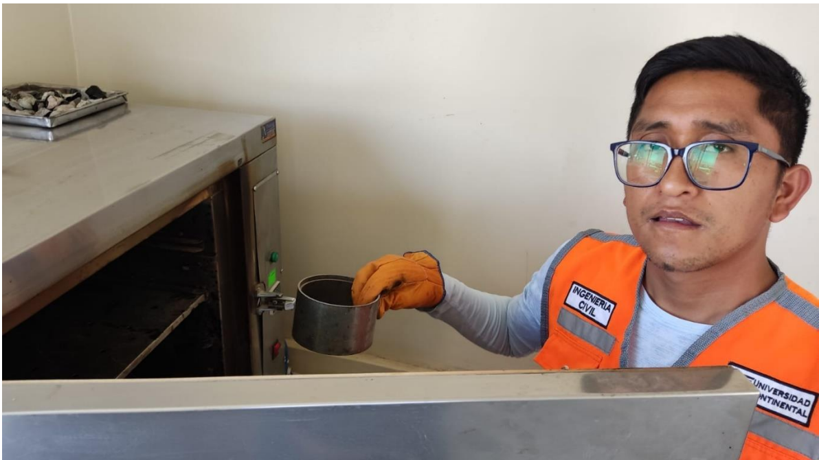
Fotografía 14: Acondicionamiento de los materiales del pedestal (molde de material, placa base y collarín) para la elaboración de briquetas de acuerdo al porcentaje de contenido de ligante asfáltico (4%, 4.5%, 5%, 5.5%, 6% y 6.5%).
