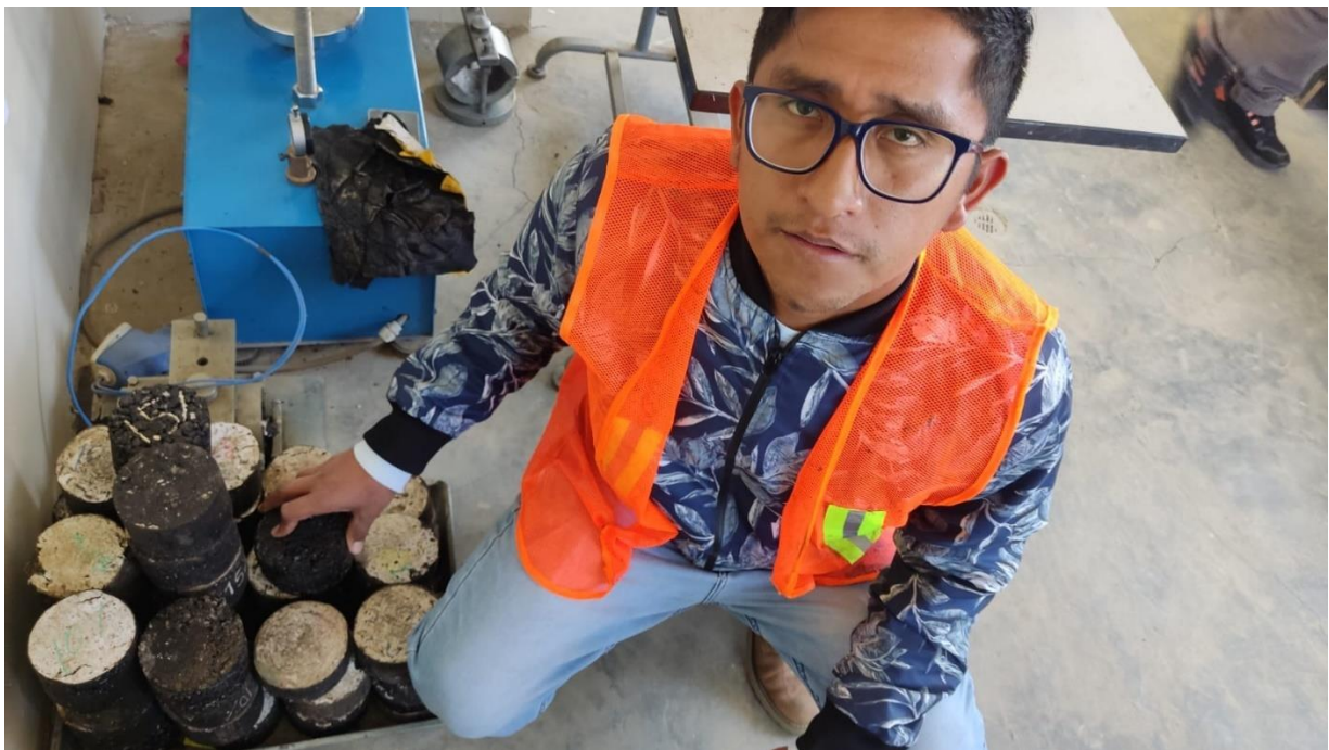
Fotografía 38: Elaboración de briquetas con el óptimo contenido de asfalto.
