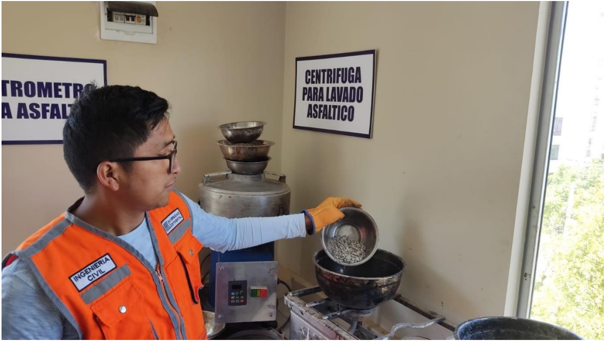
Fotografía 11: Preparado de agregado a temperatura de mezcla para la elaboración de briquetas de acuerdo al porcentaje de contenido de ligante asfáltico (4%, 4.5%, 5%, 5.5%, 6% y 6.5%).
