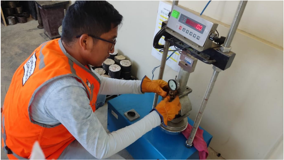
Fotografía 45: Ensayo de Marshall para briquetas con mantenimiento.
