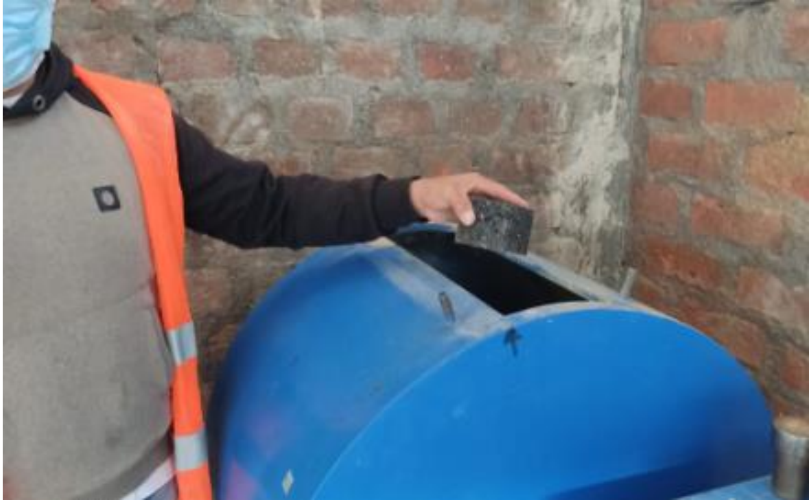
Fotografía 31: Colocado la muestra en la maquinaria de abrasión los ángeles sin la carga de abrasiva de las bolas.
