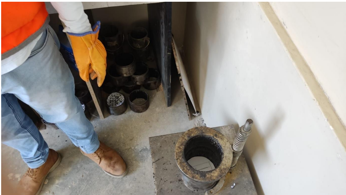
Fotografía 16: Colocado de papel filtro dentro del molde del pedestal de acuerdo al porcentaje de contenido de ligante asfáltico (4%, 4.5%, 5%, 5.5%, 6% y 6.5%).
