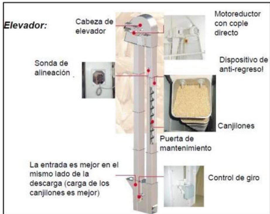
Figura 32. Elevador de transporte en operación. Tomada de “Revista de equipos”, por BUHLER. 2018. (16)
