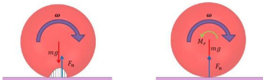
Figura 95. Distribución de carga en la zona de contacto. Diseño propio.
