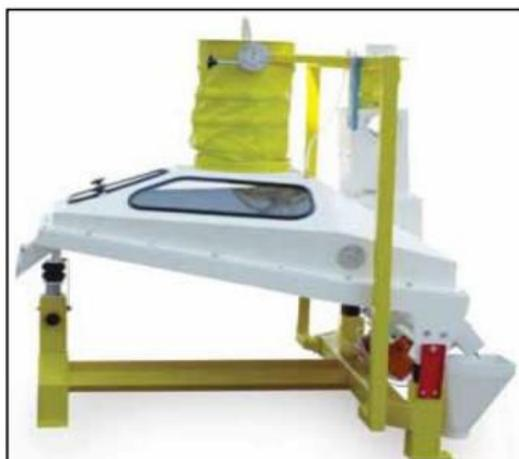
Figura 39. Exterior de la mesa DENSIMETRICA de la marca ALAPALA. Tomada de “Revista de equipos”, por ALAPALA, 2018. (16)
