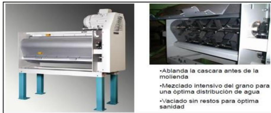
Figura 43. Perspectiva exterior e interior del rociador intensivo BUHLER. Tomada de “Revista de equipos”, por BUHLER. 2018. (16)
