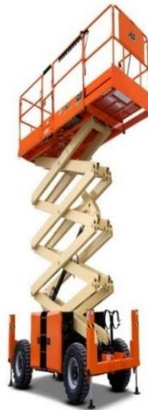
*Figura 64.* Elevador de tijera Motorizado de JLG 430 LRT. Tomada de “Aplicaciones que requieren grandes espacios de trabajo”, por MAQCEN. (28)
