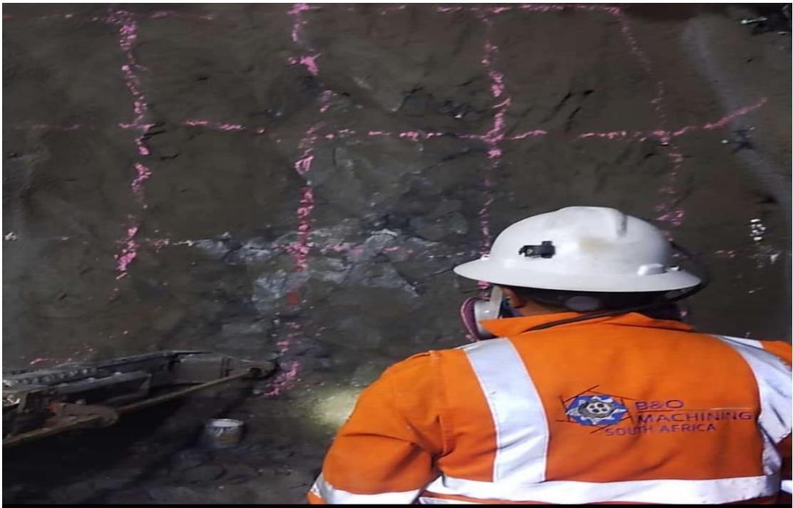
Correcto pintado de la malla de perforación
