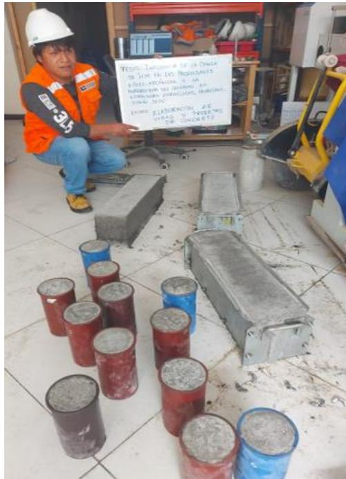
**Figura 64.** Elaboración de probetas cilíndricas y vigas prismáticas, según ASTM C 31/C 31M-09<sup>a</sup>.
