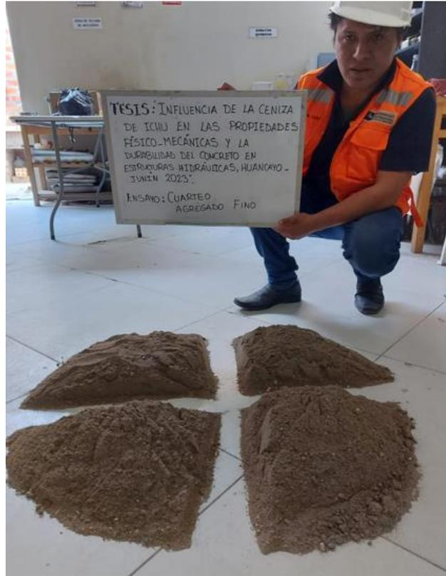
**Figura 42.** Cuarteo de agregado fino
