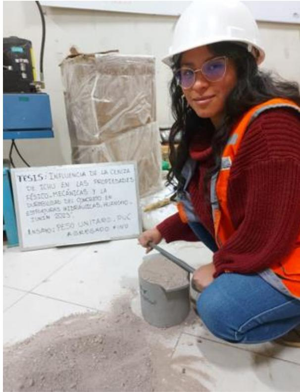
**Figura 46.** Peso unitario compactado de agregado fino, según ASTM C29 y MTC E-203.
