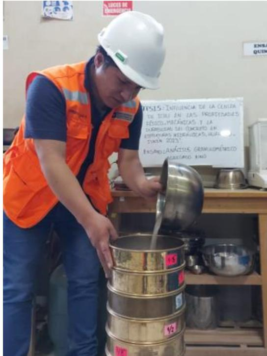
**Figura 44.** Ensayo de análisis granulométrico según NTP 400.012.2013, ASTM C136.
