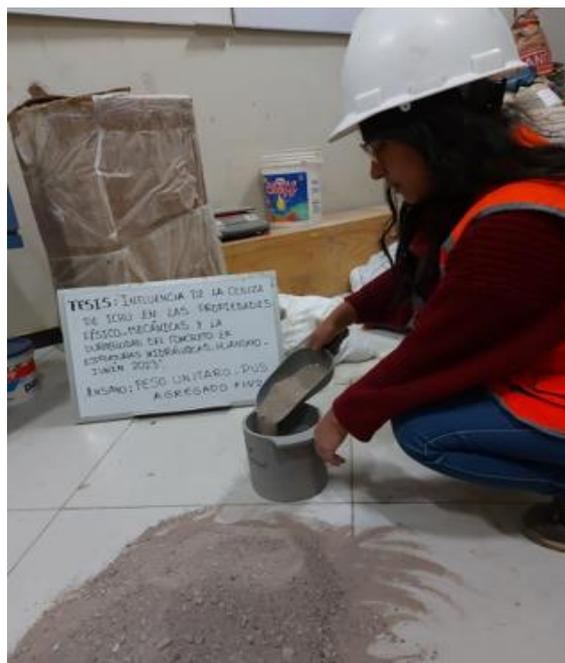
**Figura 45.** Peso unitario suelto de agregado fino, según ASTM C29 y MTC E-203.
