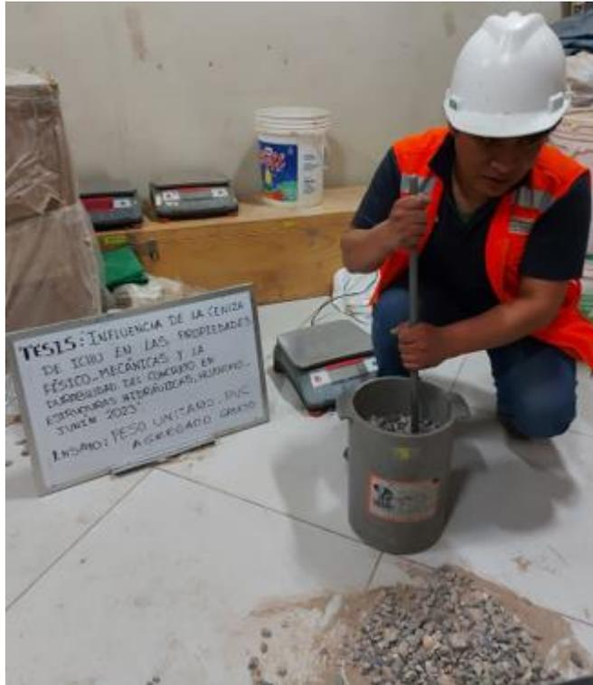
**Figura 56.** Peso unitario compactado de agregado grueso, según NORMA ASTM C29, MTC E-203
