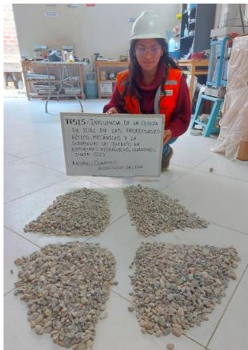
**Figura 51.** Cuarteo de agregado grueso, según la NTP 339.089.
