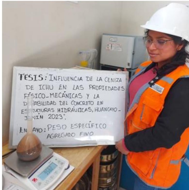
**Figura 48.** Peso específico agregado fino, según NORMA ASTM C127.
