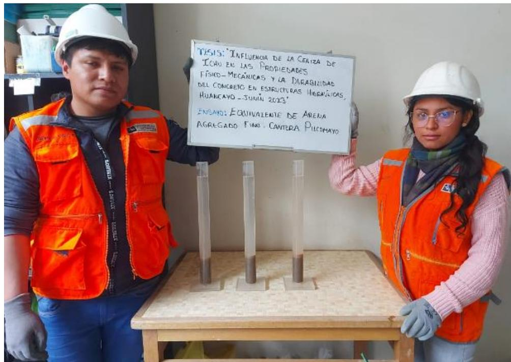
**Figura 49.** Equivalente de arena natural, según MTC E – 114.
