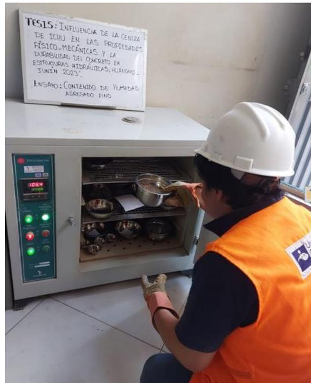
**Figura 43.** Ensayo de contenido de humedad según NTP 339.185.
