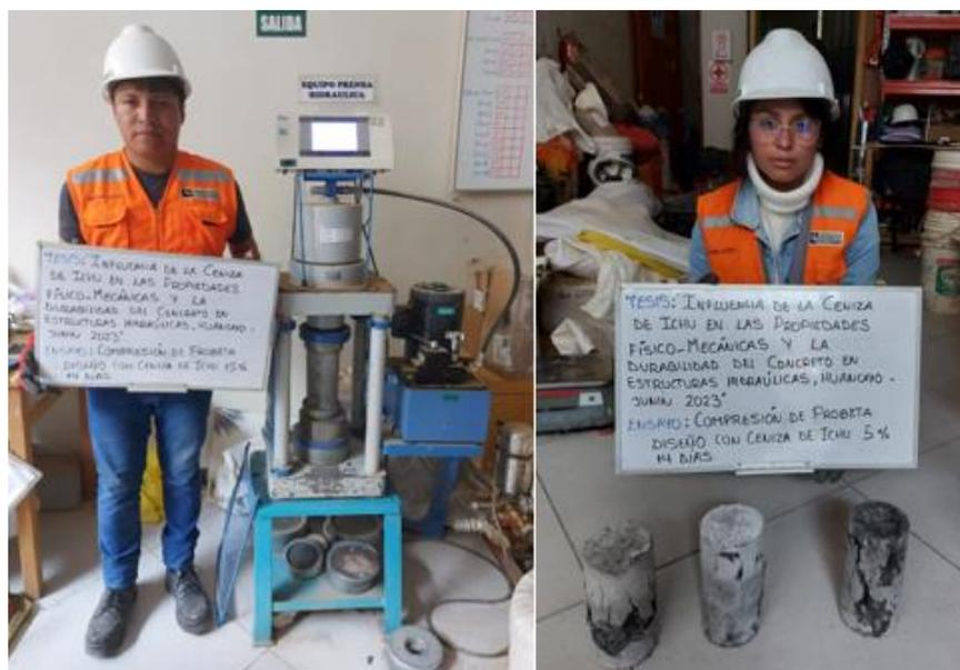
**Figura 67.** Determinación de la resistencia a la compresión, según NTP 339.034:15 - ASTM C39 / C39M - 17
