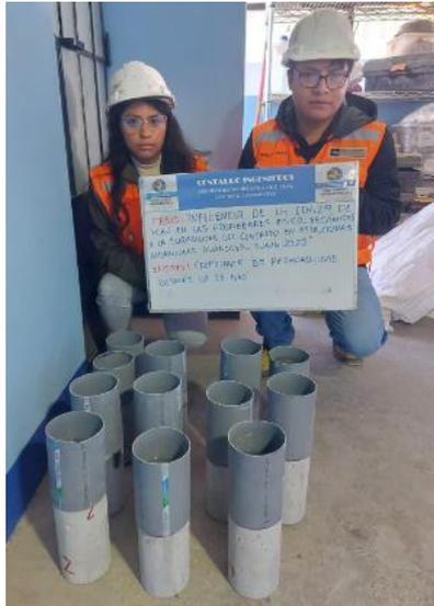
*Figura 72. Preparación de probetas, según NTC 4483*
