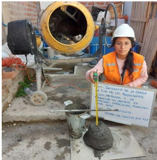
**Figura 59.** Determinación del asentamiento en el concreto, según ASTM C143/C143M-20
