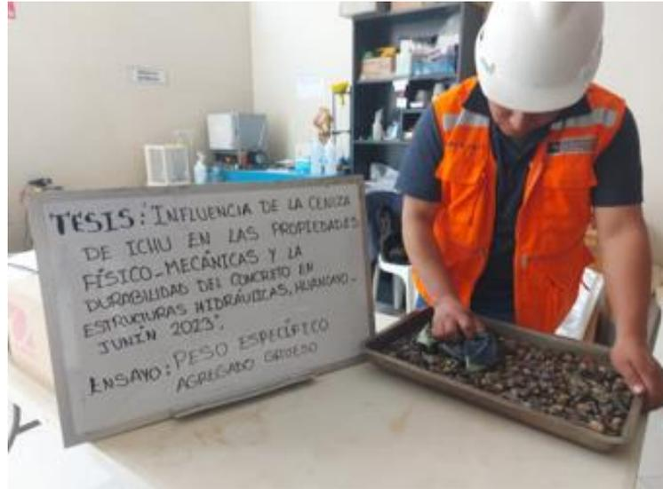
**Figura 54.** Secado superficial de agregado grueso, según NORMA ASTM C127 – 07
