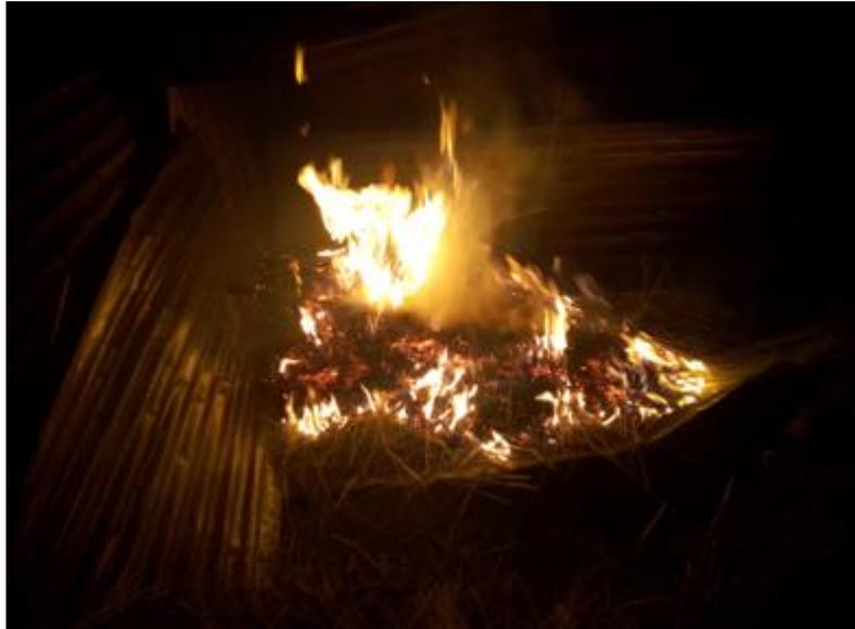
**Figura 31.** Calcinación para obtención de ceniza de ichu.
