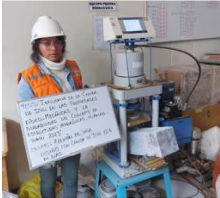
**Figura 68.** Determinación de la resistencia a la flexión, según ASTM C78/C78M – 18.
