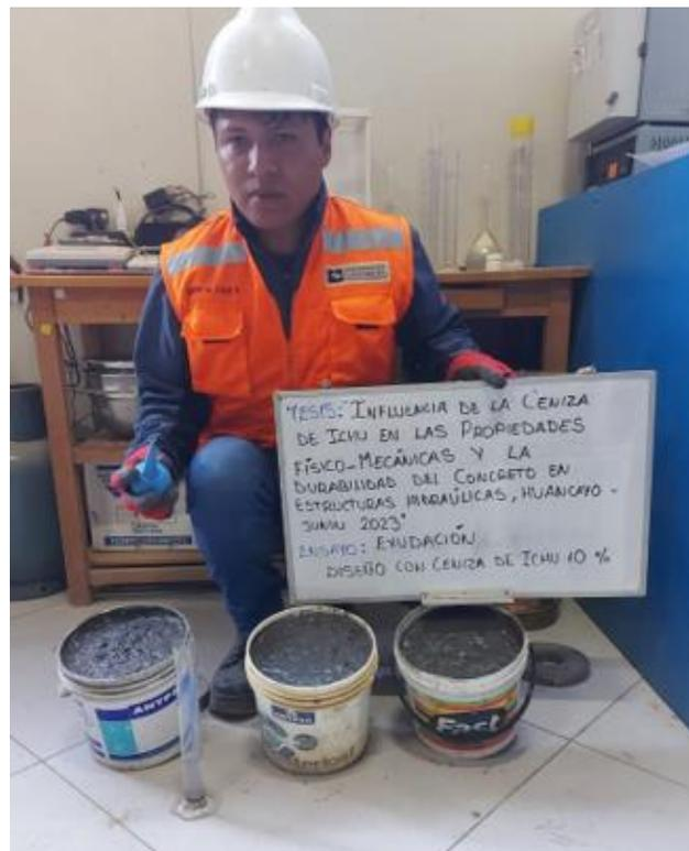
**Figura 63.** Determinación de la exudación del concreto, según NTP 339.077:2013
