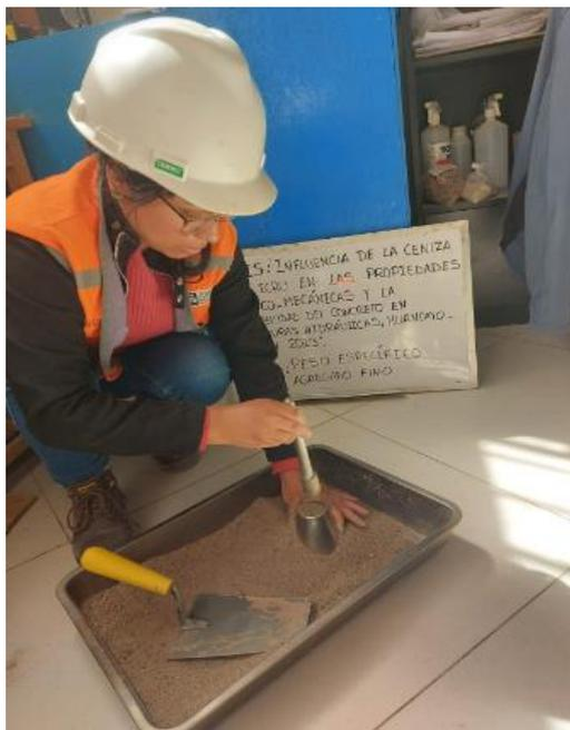
**Figura 47.** Verificación de presencia de humedad libre en el agregado fino, según NORMA ASTM C127
