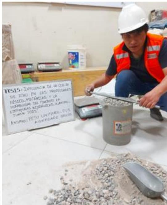
**Figura 57.** Peso unitario suelto de agregado grueso, según NORMA ASTM C29, MTC E-203
