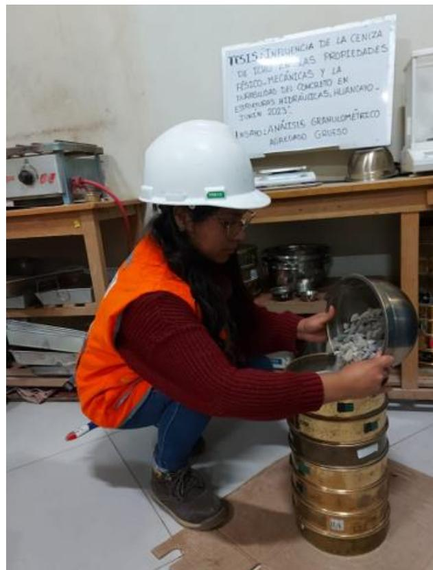
**Figura 53.** Ensayo de análisis granulométrico, según NORMA ASTM C136 - MTC E
