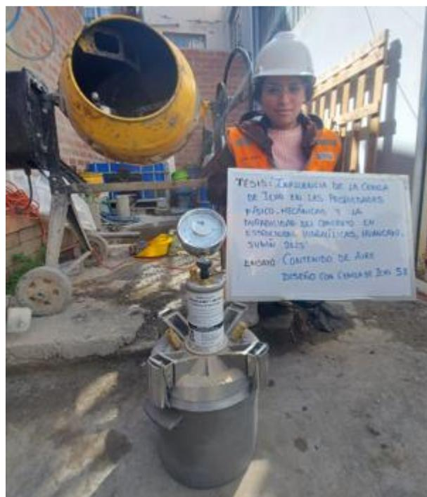
**Figura 61.** Determinación del contenido de aire en el concreto, según ASTM C138/C138M – 17a
