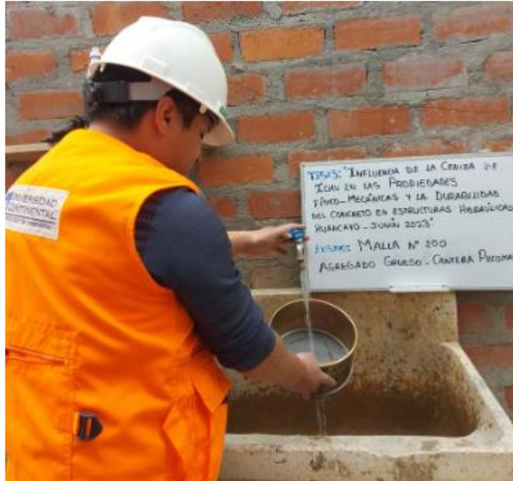
**Figura 58.** Material que pasa por la Malla N° 200 por lavado, según MTC E – 202.
