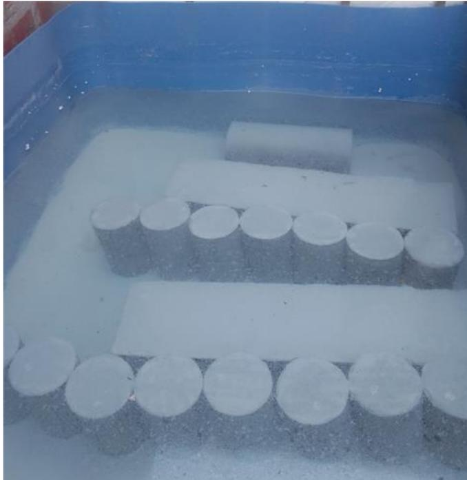
**Figura 66.** Curado de probetas y vigas, según su edad a ensayar, según ASTM C 31/C 31M-09<sup>a</sup>.
