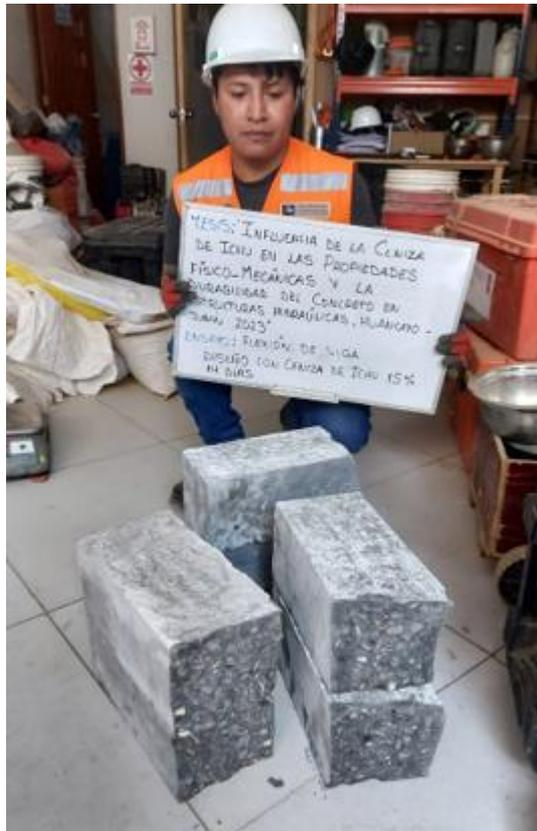
**Figura 69.** Rotura de vigas prismáticas, según ASTM C78/C78M – 18.
