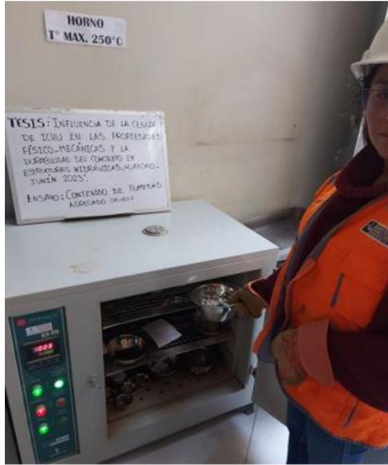
**Figura 52.** Ensayo de contenido de humedad, según NTP 339.185.
