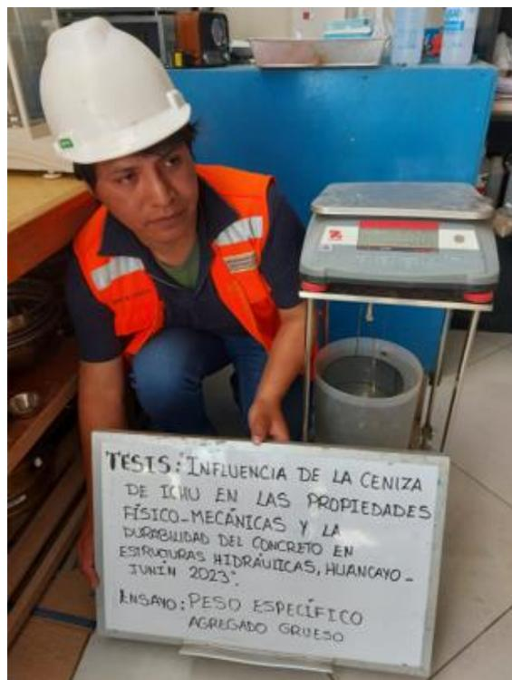
**Figura 55.** Peso específico de agregado grueso, según NORMA ASTM C127 - 07
