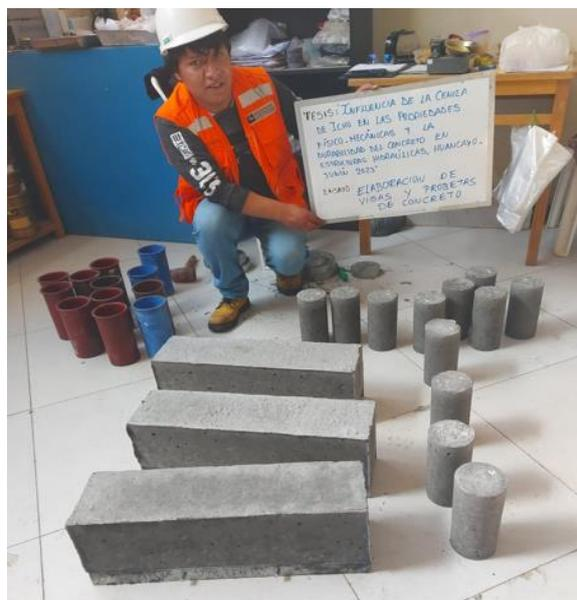
**Figura 65.** Desencofrado de probetas cilíndricas y vigas prismáticas, según ASTM C 31/C 31M-09<sup>a</sup>.
