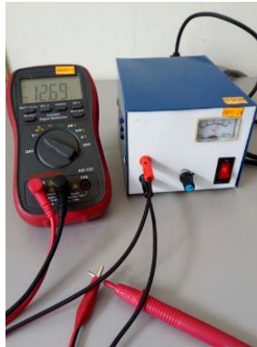
Figura 06: Medición del valor en la salida CC de la fuente de alimentación
