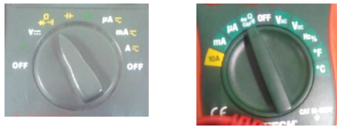
Figura 04: Selector del multímetro ubicado para medir el valor de una resistencia
