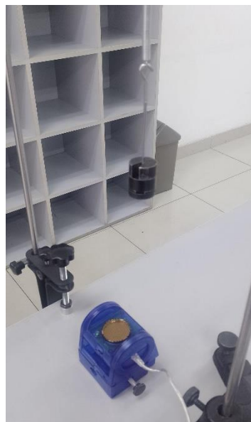
Figura 07: Montaje del sensor de posición
