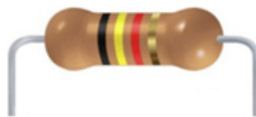
Figura 01: Resistencia típica mostrando su código de colores
