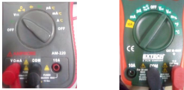
Figura 07: Selector del multímetro ubicado para medir el voltaje en CC
