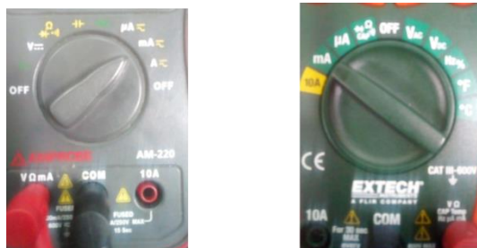
Figura 09: Selector del multímetro ubicado para medir intensidad de corriente en CC
