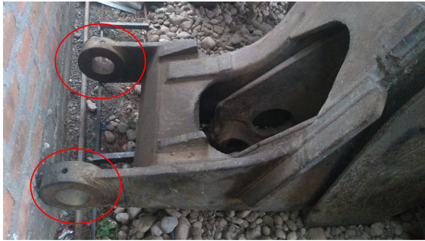
Figura 01. Se observa el desgaste de las articulaciones de los puños. taller de la empresa “Congere Mega Power”.
