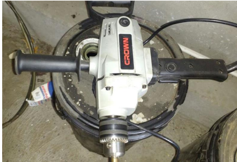
Figura 21. Taladro eléctrico portátil de tipo semi profesional marca “Crown”
