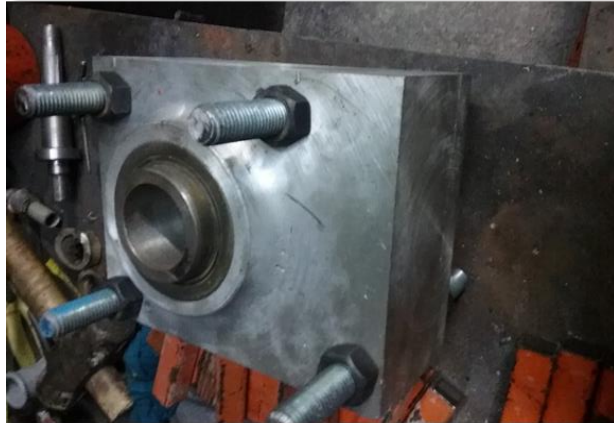
Figura 70. Fabricado de carcasa de sistema de transmisión.
