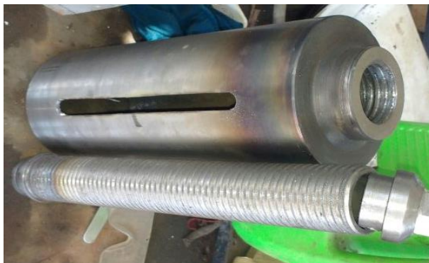
Figura 67. Husillo rosca ACME y carcasa de tornillo
