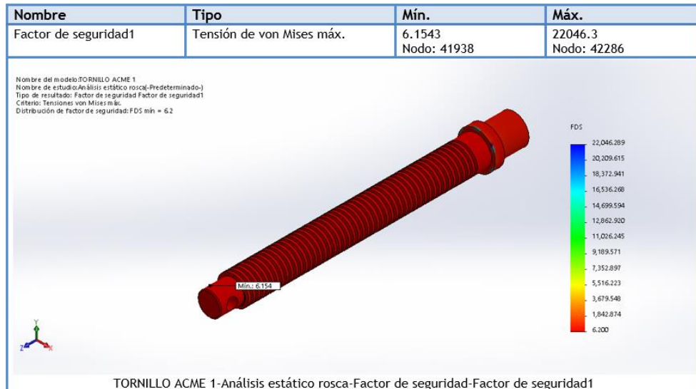
Figura 61. Análisis estático del husillo, factor de seguridad.
