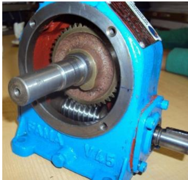
Figura 07. Reductor tornillo sinfín. Tomada de “Desarrollo tecnológico y construcción del conjunto corona-eje para reductor de velocidad”, por Acosta Daniel Andrés Arboleda et al. 2011, (18 p. 14).
