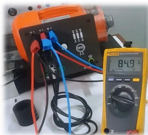
Figura 22 Simulación de baja tensión (Subtensión)
