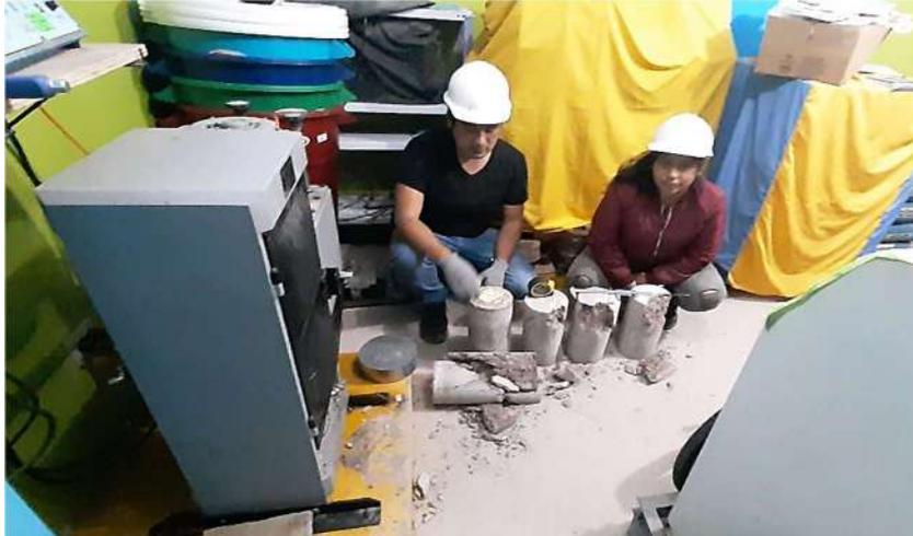
**Figura 44.** Fractura tipo (E) fracturas laterales, según la norma ASTM C-39, NTP 339.034. Fuente: Elaboración propia.
