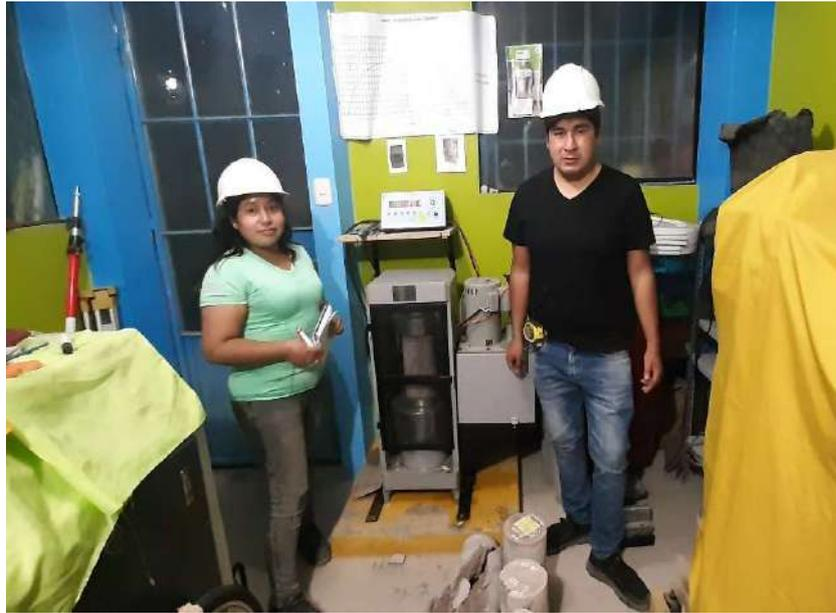
**Figura 74. Rotura de probetas con prensa hidráulica.**
