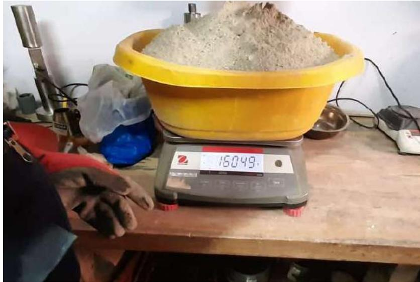
**Figura 8.** Peso de las cenizas de fondo tamizada. Fuente: Elaboración propia.
