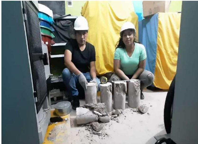
**Figura 75. Rotura de probetas con prensa hidráulica.**
