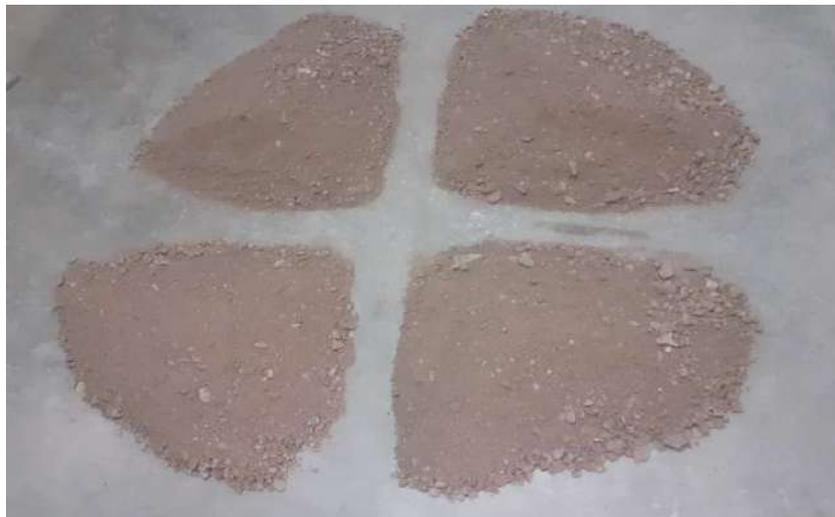
**Figura 21.** Cuarteo del agregado fino. Fuente: Elaboración propia.
