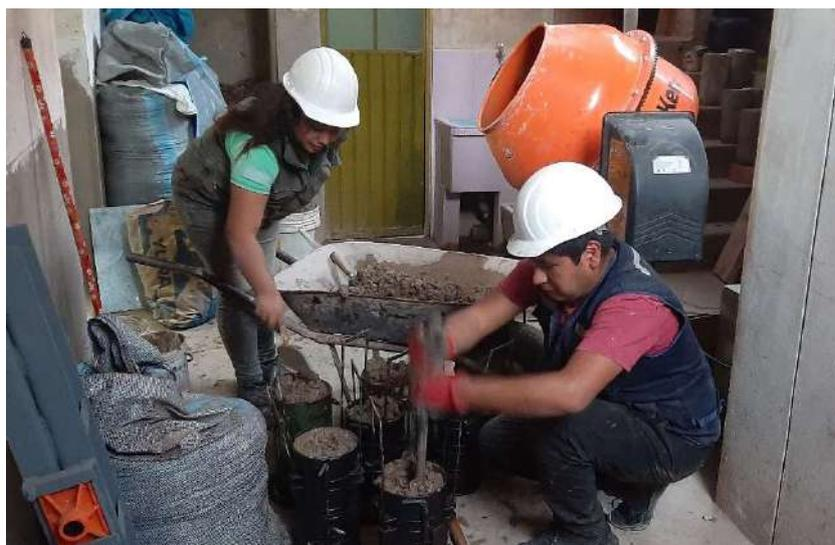
**Figura 38.** Elaboración de probetas (figura referencial). Fuente: Elaboración propia.
