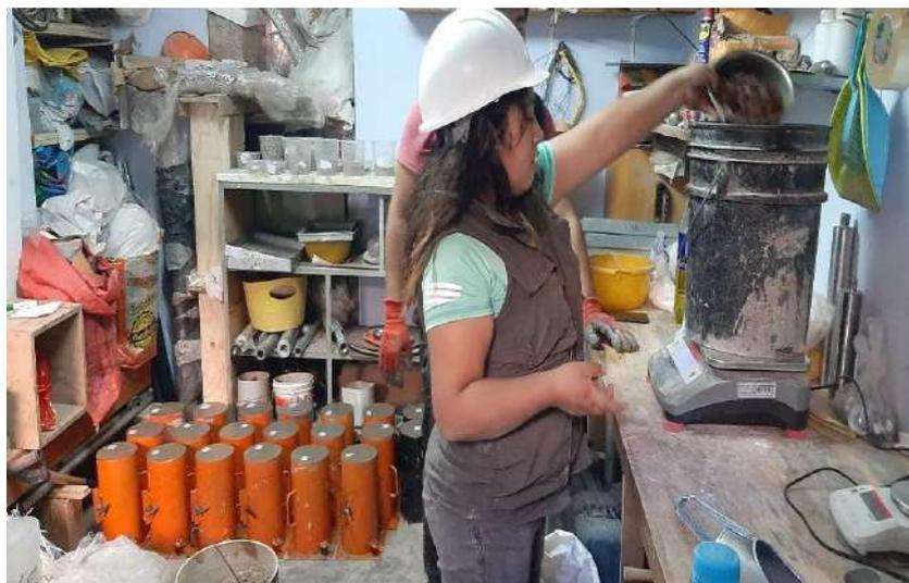
**Figura 35.** Se mide el peso de los agregados con la ayuda de baldes y balanza. Fuente: Elaboración propia.
