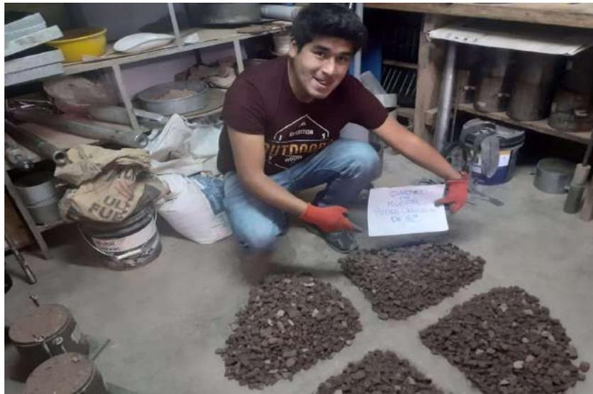
**Figura 28.** Extraer la muestra y cuartear. Fuente: Elaboración propia.
