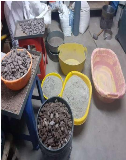
**Figura 65. Proporciones de material a emplear en mezcla de concreto.**
