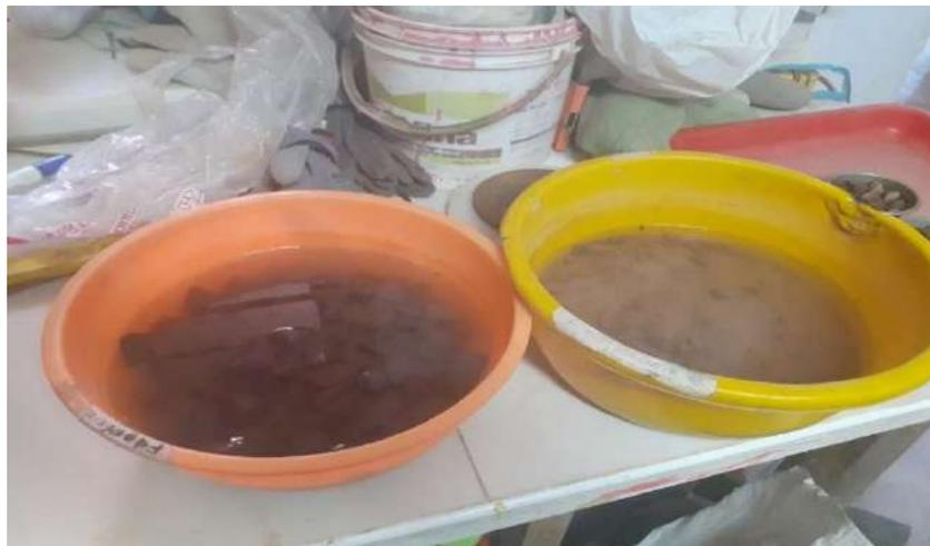
**Figura 26.** Se sumerge el agregado durante 24 horas. Fuente: Elaboración propia.
