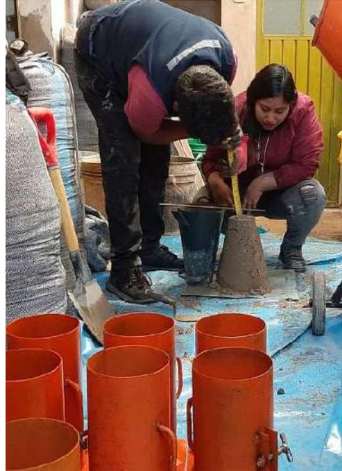
**Figura 68. Determinación de prueba del Slump**
