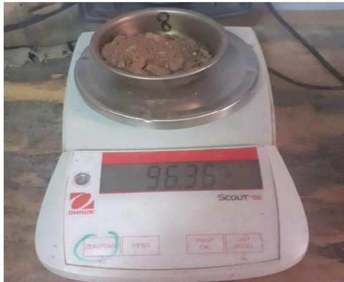
**Figura 13.** Peso unitario suelto seco de la muestra representativa. Fuente: Elaboración propia.
