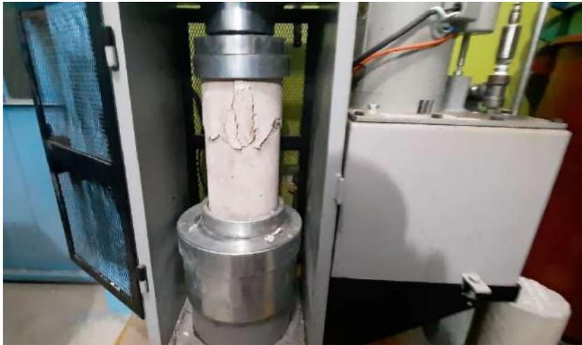
**Figura 45.** Fractura tipo (B) cono y separación, según la norma ASTM C-39, NTP 339.034. Fuente: Elaboración propia.
