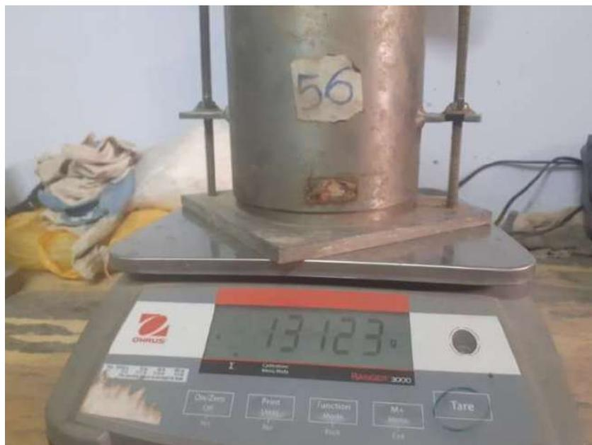
**Figura 15.** Peso del recipiente cilíndrico. Fuente: Elaboración propia.
