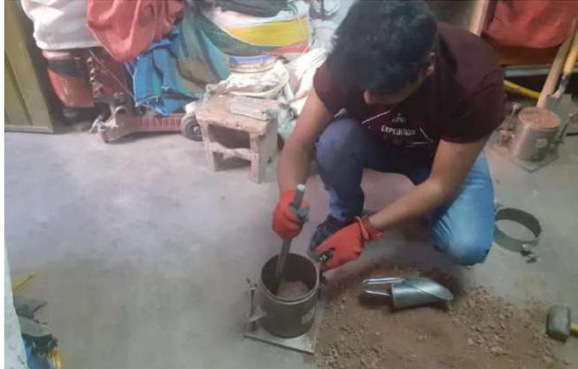
**Figura 16.** Compactado manual de forma helicoidal con varilla de  $\frac{5}{8}$ ". Fuente: Elaboración propia.
