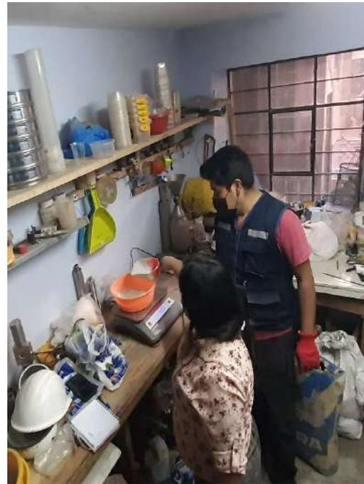
**Figura 66. Peso de los materiales para realizar mezcla de concreto.**
