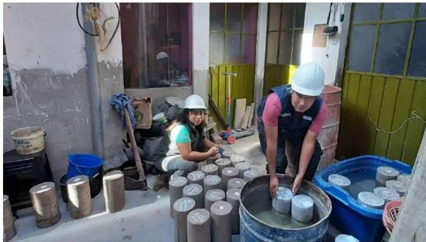
Figura 40. Curado de las probetas de  $C^o$  (figura referencial). Fuente: Elaboración propia.
