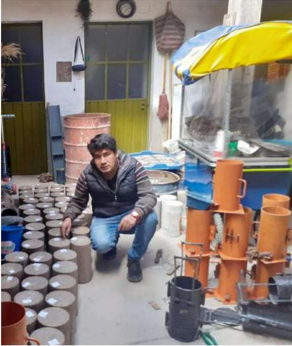
**Figura 71. Desmolde de probetas de concreto.**
