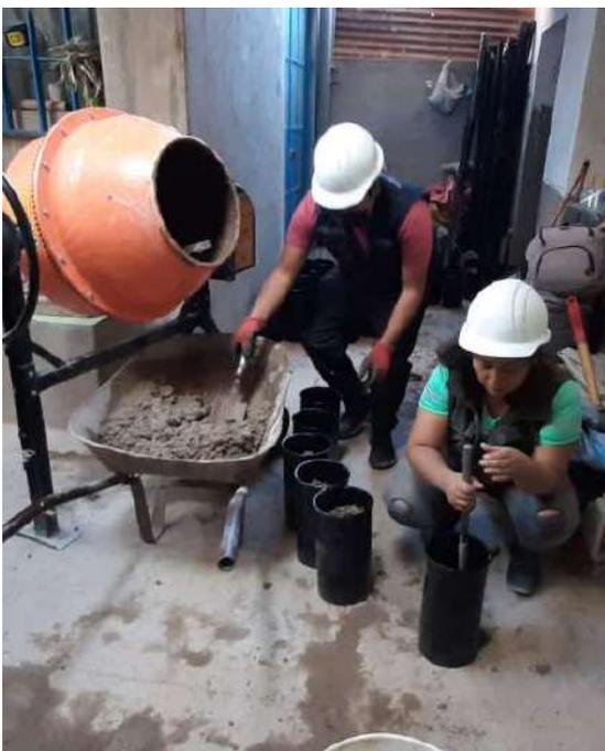
**Figura 69. Llenado de los moldes con C°.**
