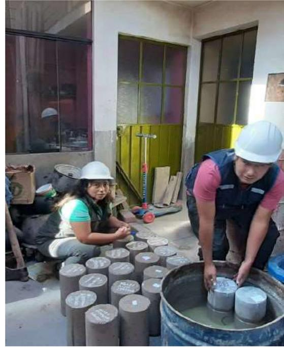
**Figura 72. Curado de probetas de concreto.**
