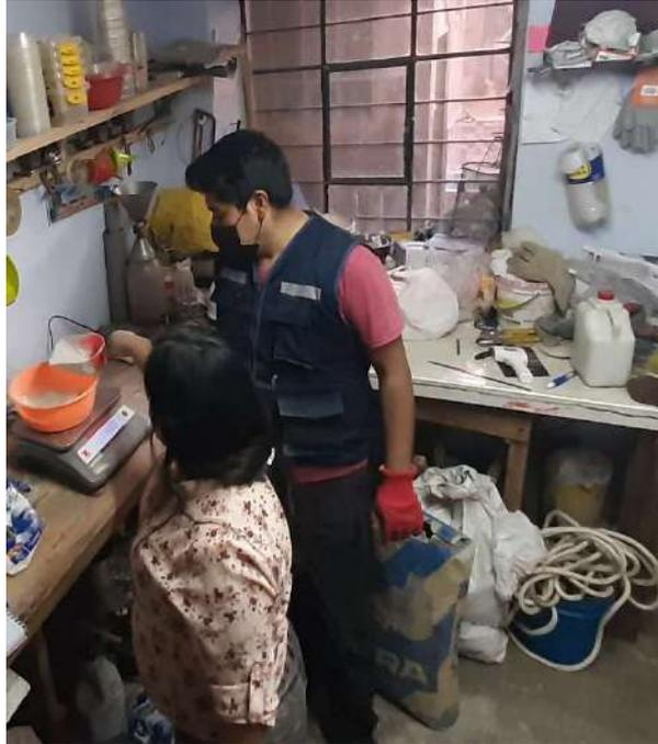
**Figura 36.** Se toma la medida del peso de la ceniza de fondo de eucalipto. Fuente: Elaboración propia.
