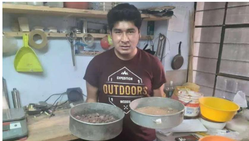
**Figura 17.** Tamizado del agregado fino (foto referencial). Fuente: elaboración propia
