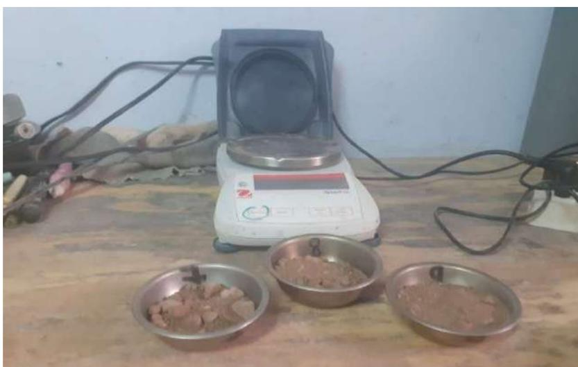
**Figura 10.** Peso de la muestra retenida en los tamices durante el zarandeo. Fuente: Elaboración propia
