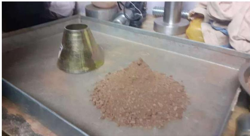
**Figura 18.** Ensayo del molde cónico con la superficie del material seco. Fuente: Elaboración propia
