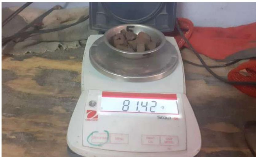
**Figura 24.** Peso de la muestra del agregado grueso (foto referencial). Fuente: Elaboración propia.
