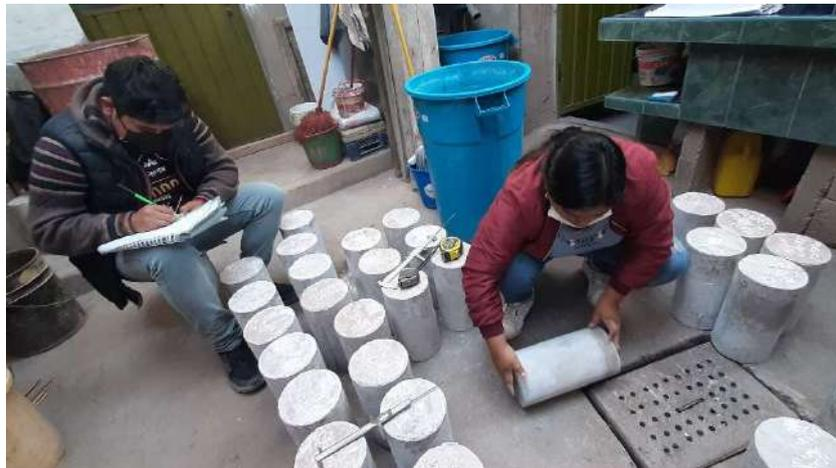
**Figura 73. Medición de probetas para realizar prueba a la compresión.**
