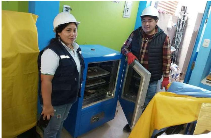
**Figura 22.** Secado del agregado fino en el horno eléctrico a 100°C. Fuente: Elaboración propia.
