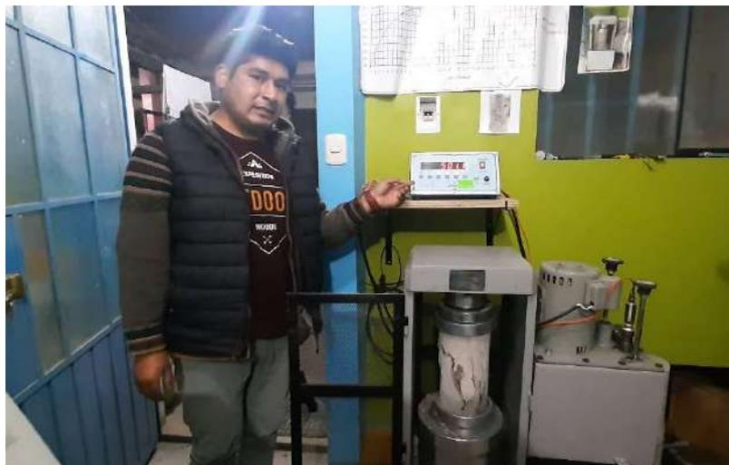
**Figura 46.** Fractura tipo (C) corte, según la norma ASTM C-39, NTP 339.034. Fuente: Elaboración propia.
