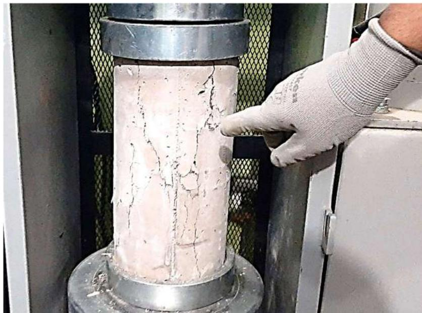
**Figura 43.** Fractura tipo (D) columnar según la norma ASTM C-39, NTP 339.034. Fuente: Elaboración propia.
