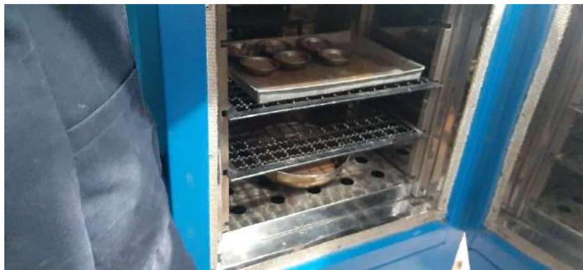
**Figura 20.** Horno para realizar el secado de la muestra. Fuente: Elaboración propia
