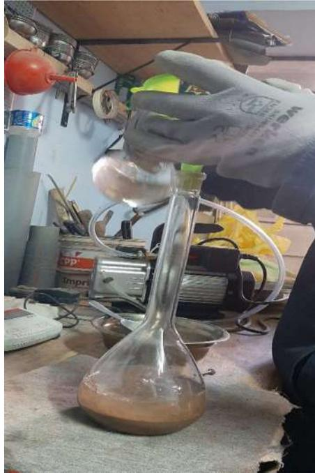
**Figura 19.** Se procede a pesar el matraz después de haber realizado la eliminación de aire del agregado. Fuente: Elaboración propia.
