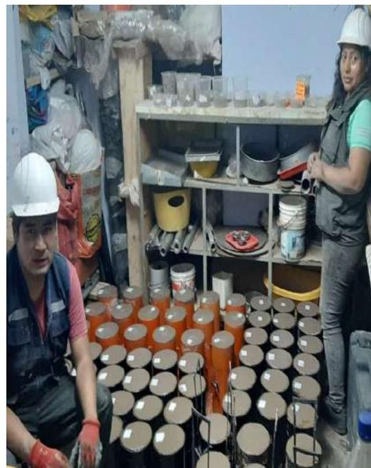
**Figura 70. Elaboración de probetas de C°.**
