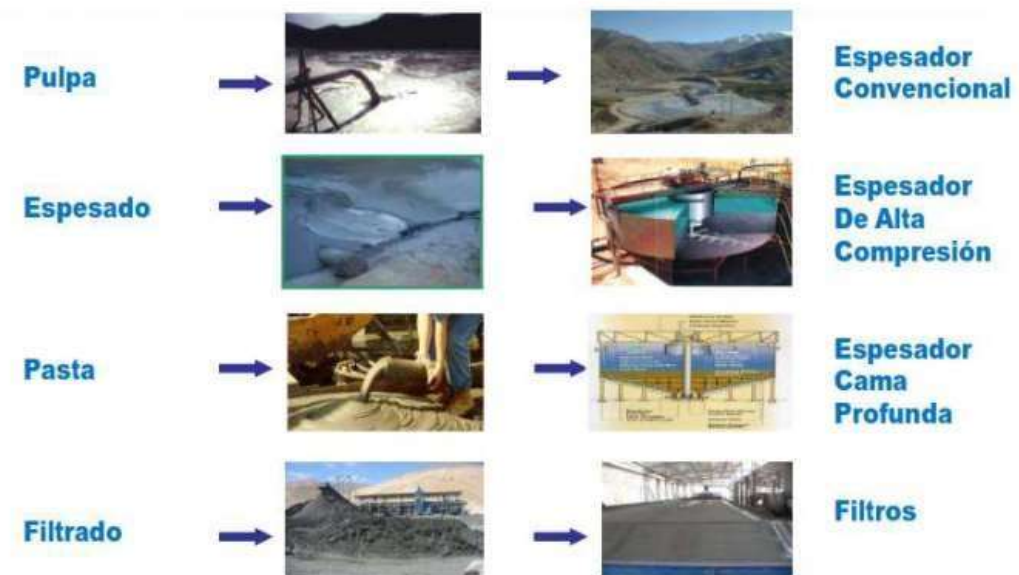
Figura 3. Tipos de relaves. Tomado de “Experiencias de Operación de Depósitos de Relaves Espesados y Filtrados, Golder Associates”, 2013.
